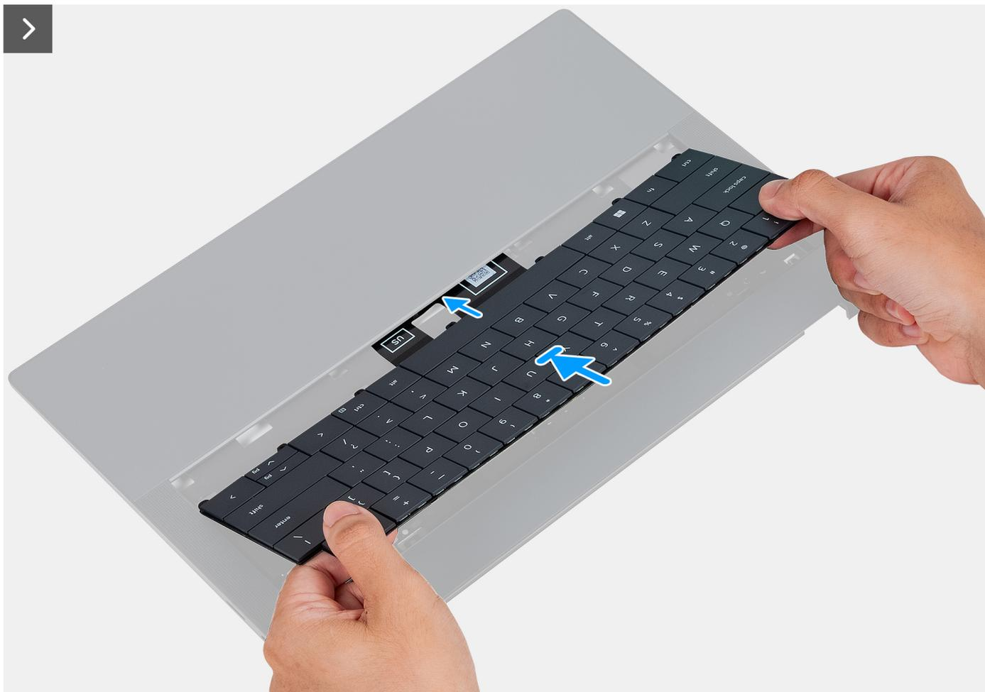
Figure 34. Installation du clavier
