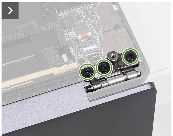
Figure 19. Retrait de l'assemblage d'écran
