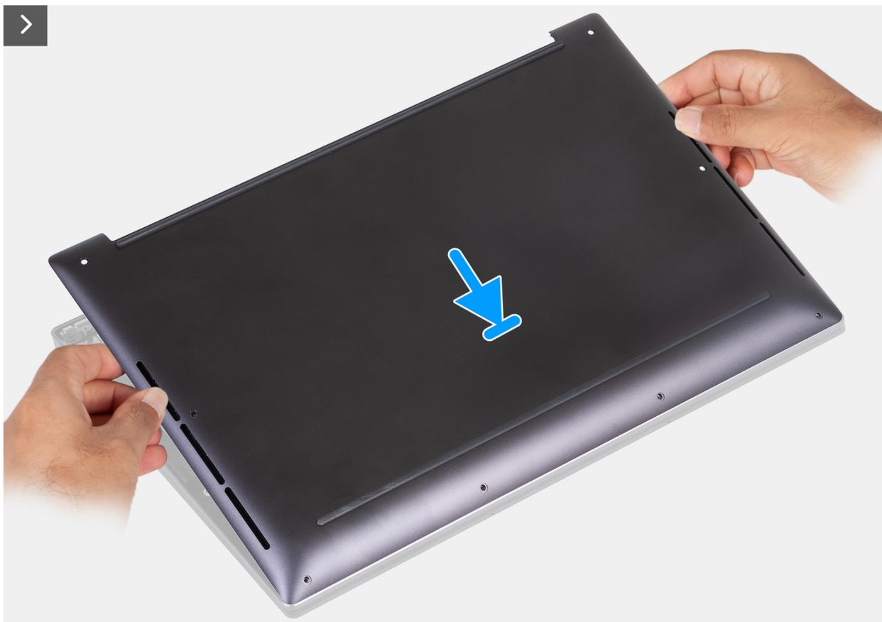
**Figure 6. Positionnement du cache de fond dans des logements situés sur l'assemblage du repose-poignets**
