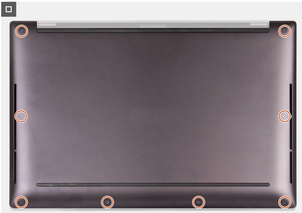
**Figure 8. Serrage des huit vis qui fixent le cache de fond à l'assemblage du repose-poignets**
