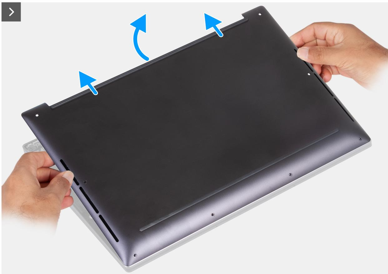
**Figure 3. Soulèvement du cache de fond hors de l'assemblage du repose-poignets**
