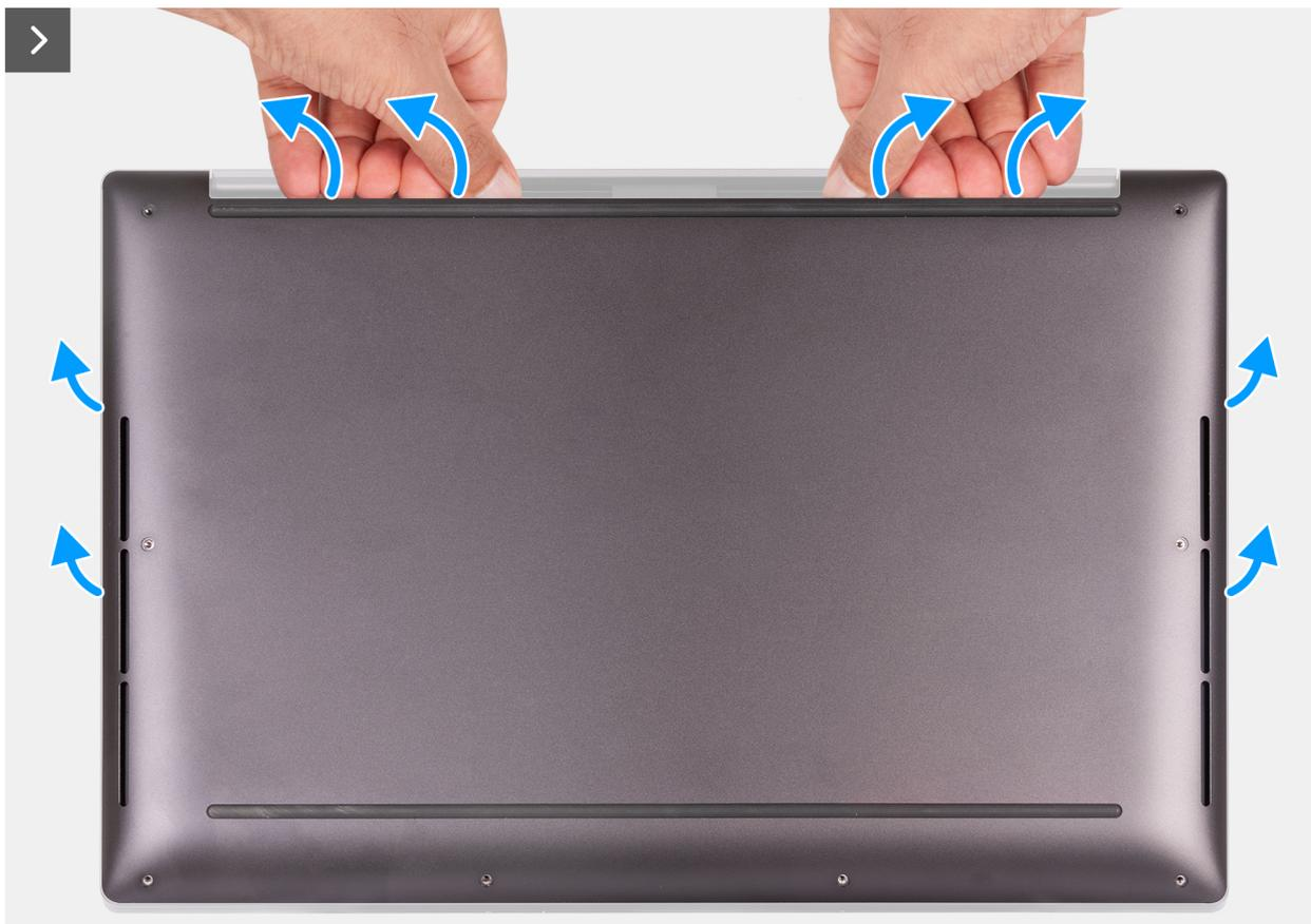
**Figura2. Utilizar ambos os polegares para forçar a tampa da base**
