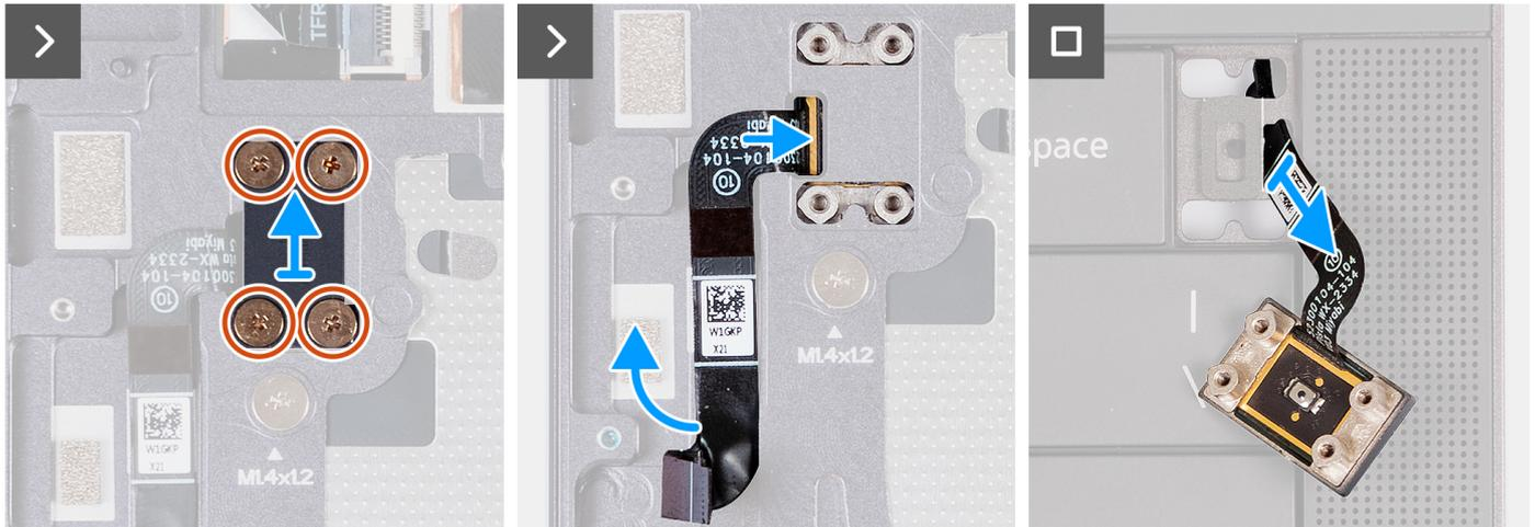
Figura30. Retirar o botão de alimentação com leitor de impressões digitais
