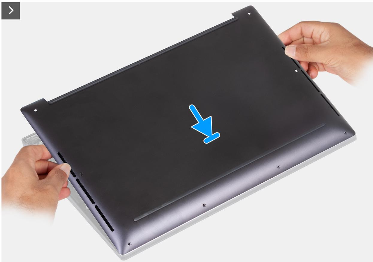
**Figura6. Colocar a tampa da base nas ranhuras no conjunto do descanso para os pulsos**
