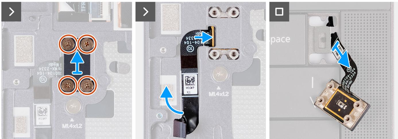
**Ilustración 30. Extracción del botón de encendido con lector de huellas digitales**
