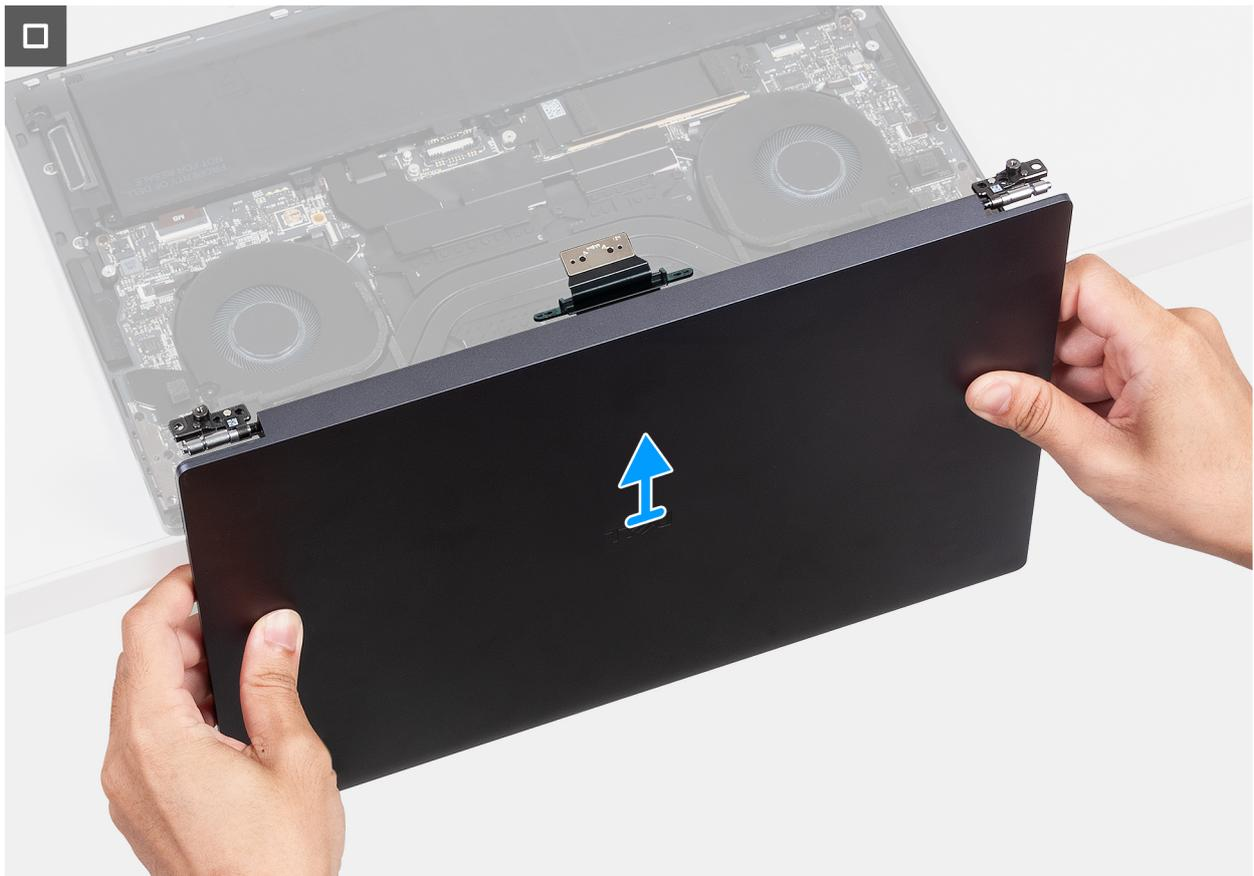
**Ilustración 22. Instalación del ensamblaje de la pantalla**
