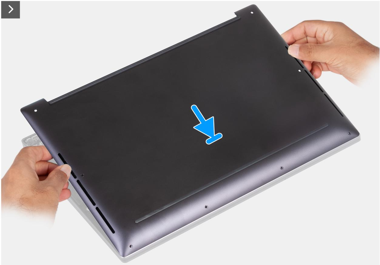
**Ilustración 6. Colocación de la cubierta de la base en las ranuras del ensamblaje del reposamanos**
