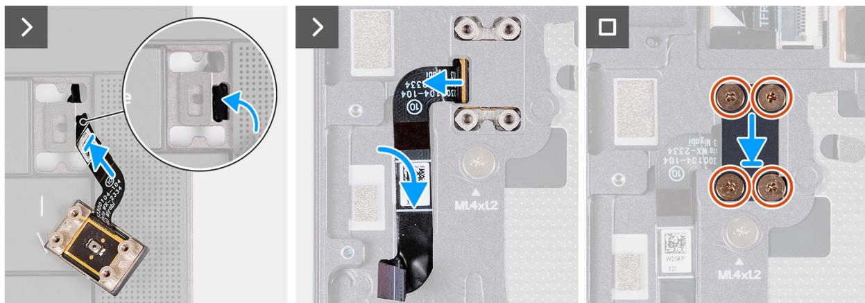
**Ilustración 31. Instalación del botón de encendido con lector de huellas digitales**
