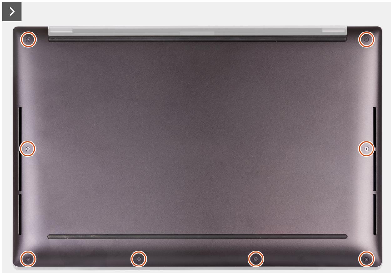
**Ilustración 1. Extracción de la cubierta de la base**
