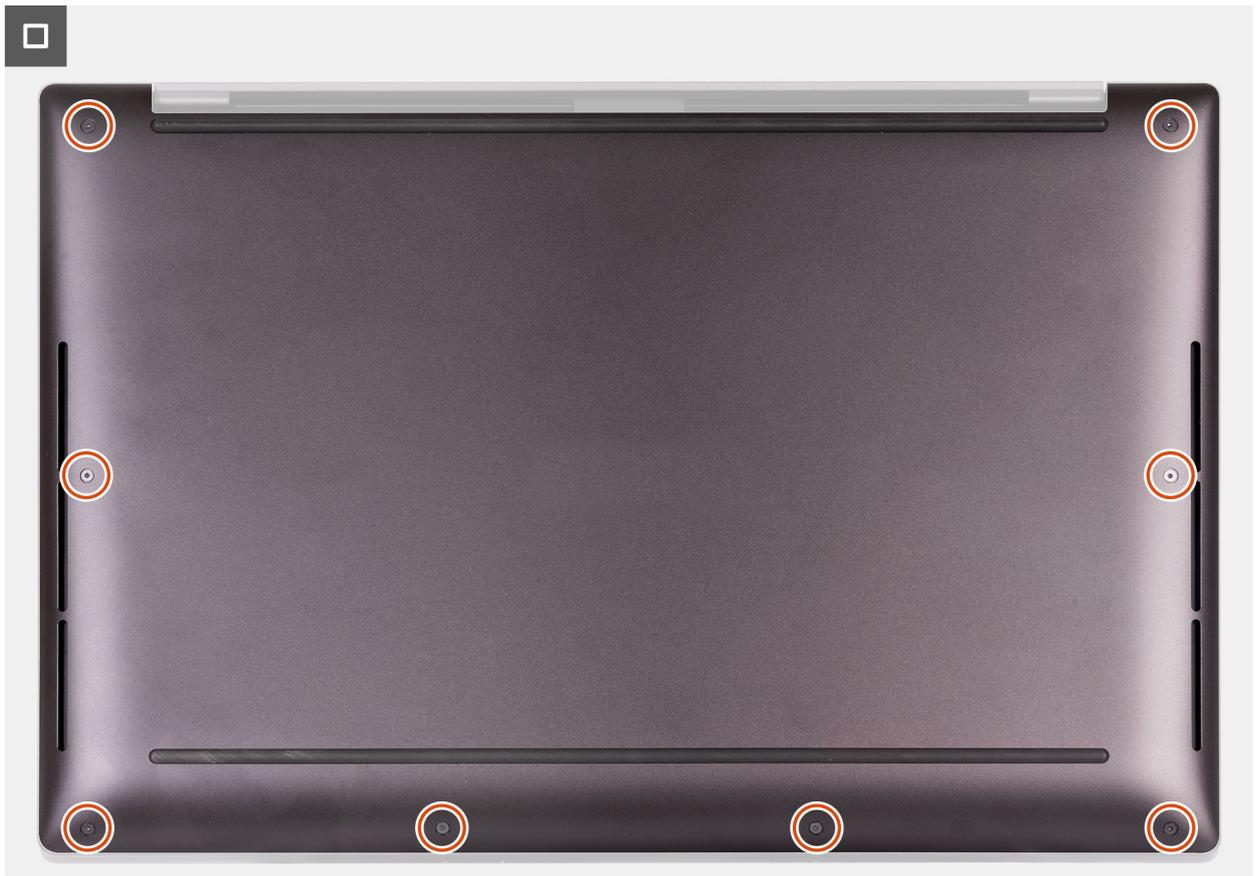
**Ilustración 8. Ajuste de los ocho tornillos que fijan la cubierta de la base al ensamblaje del reposamanos**
