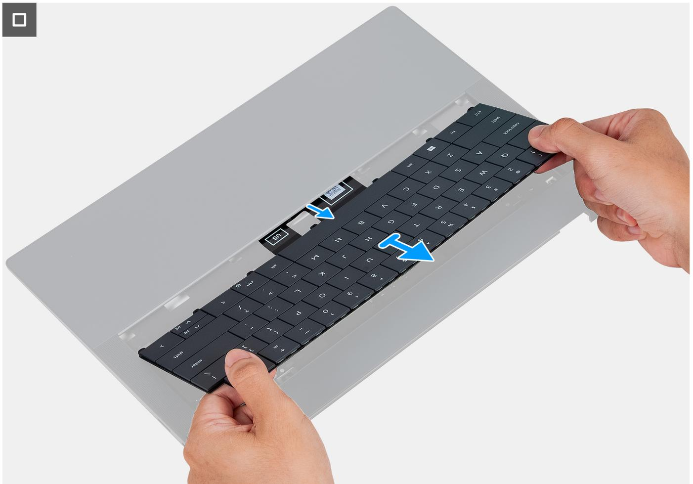
**Ilustración 33. Extracción del teclado**
