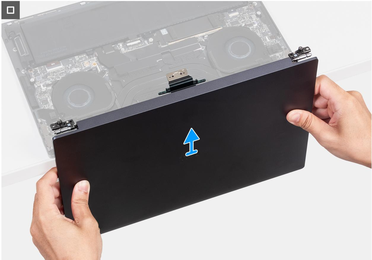
**Ilustración 20. Extracción del ensamblaje de la pantalla**
