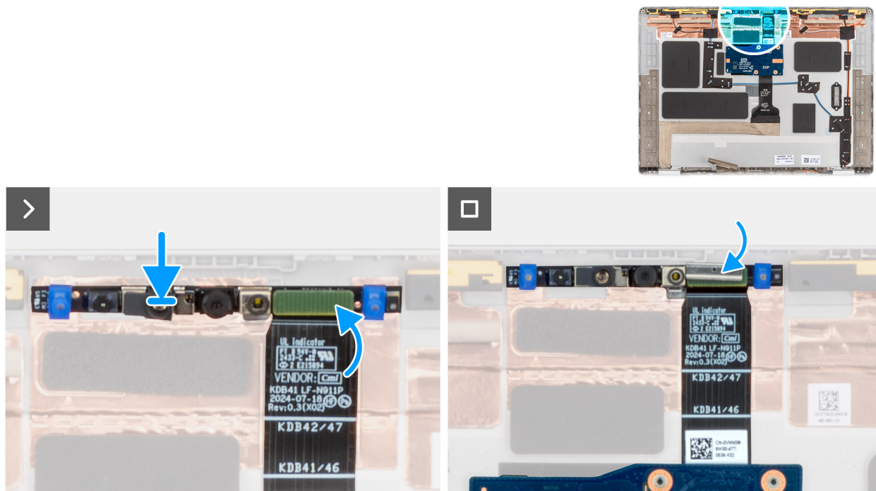
Figura 89. Installazione della fotocamera MIPI
