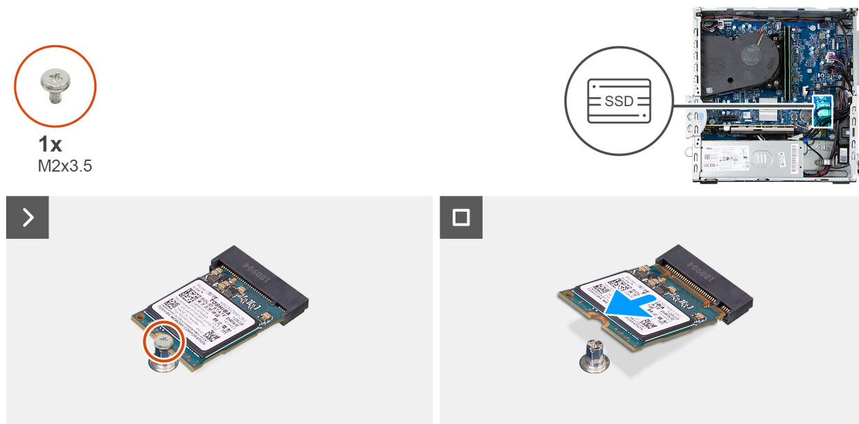
Figur 22. Ta bort M.2 2230 SSD-disken
