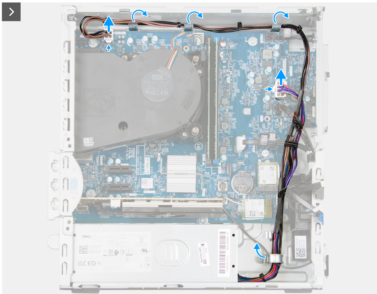
Figur 47. Ta bort nätaggregatet
