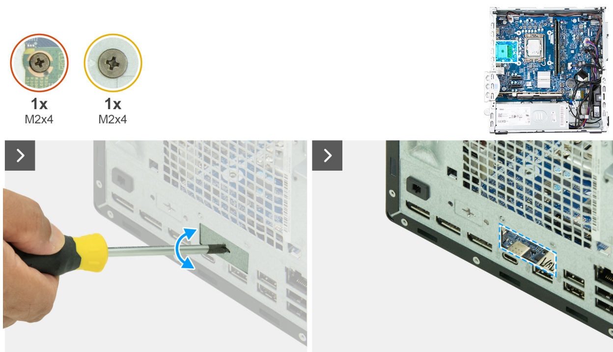
Figur 54. Installera den valfria portmodulen
