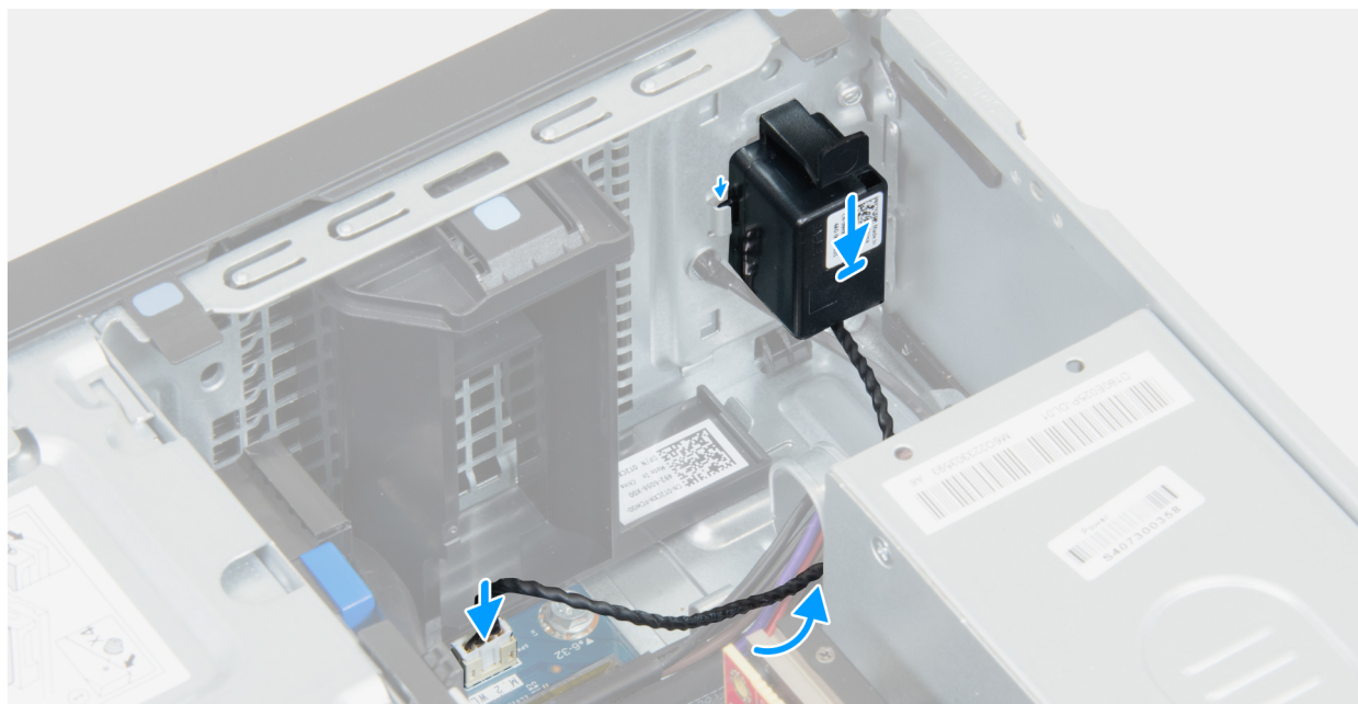
Figur 19. Installera den interna högtalaren
