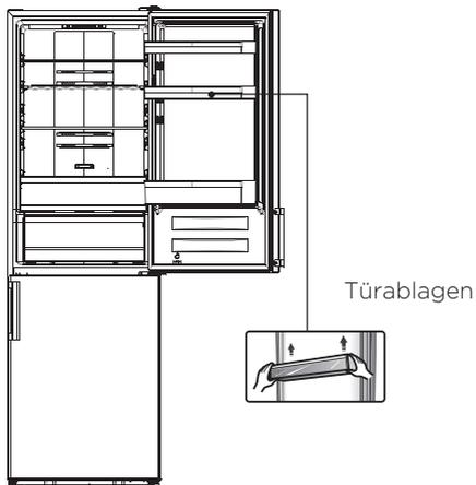
2. Entfernen Sie Teil 1, lösen Sie Teil 2 von der oberen rechten Seite des Kühlschranks und achten Sie auf den elektrischen Anschluss 3 unten, da die elektrischen Anschlüsse noch immer verbunden sind. Dann den Steckverbinder 3 abziehen und Teil 2 demontieren.
