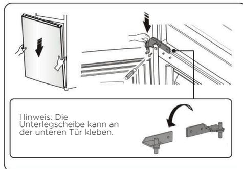
15. Bringen Sie die obere Tür in eine geeignete Position und befestigen Sie dann Teil 2 mit den Schrauben 1. Führen Sie den Steckverbinder 3 vor dem Befestigen des Teils 2 durch das Scharnier 2 (siehe Schritt 3). (Halten Sie die obere Tür beim Einbau mit der Hand fest).
