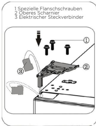
16. Schließen Sie den elektrischen Steckverbinder 1, wie in der Abbildung gezeigt, an und befestigen Sie Teil 2 mit der Schraube 3 (siehe Schritt 2).
