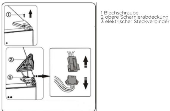
3. Entfernen Sie die Schrauben 1 und das Scharnier 2. Führen Sie dann den Stecker 3 durch die Öffnung des Scharniers 2. (Halten Sie die obere Tür beim Einbau mit der Hand fest).
