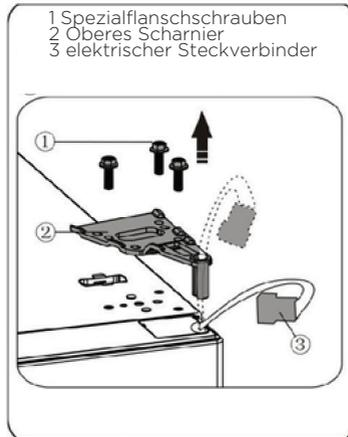
4. Entfernen Sie die obere Tür vom mittleren Scharnier, indem Sie die Tür vorsichtig nach oben anheben. Legen Sie dann die obere Tür mit der oberen Abdeckung nach oben auf eine glatte Oberfläche.
