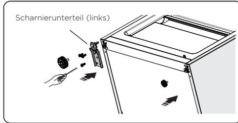
14. Setzen Sie die untere Tür auf den unteren Scharnierstift und halten Sie sie in Position. Drehen Sie das mittlere Scharnier um 180°, wechseln Sie die Unterlegscheibe an der Achse zur unteren Seite aus, stellen Sie das mittlere Scharnier in die entsprechende Position und bringen Sie es an, wobei Sie sicherstellen müssen, dass die untere Tür an ihrem Platz befestigt ist.
