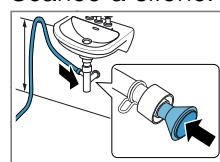
Fissare il punto di collegamento con una fascetta stringitubo (12-22 mm).
