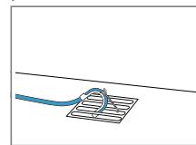
Spostare completamente il tubo flessibile di scarico dell'acqua attraverso il collettore e fissare con il materiale apposito.
