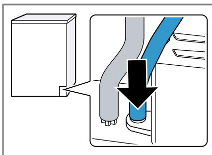
4. Infilare il tubo flessibile di scarico dell'acqua nella guida del tubo flessibile.
