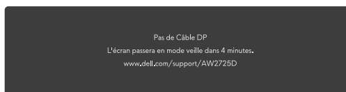
Figure 33. Message d'avertissement de câble DP débranché
