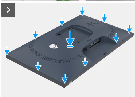
Obrázek 12. Instalace zadního krytu
