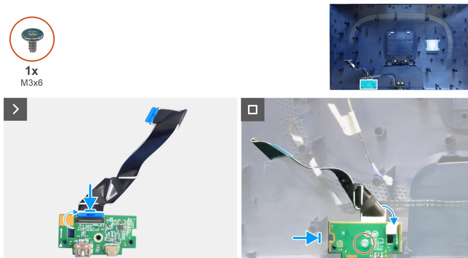
Figura 16. Instalar a placa USB
