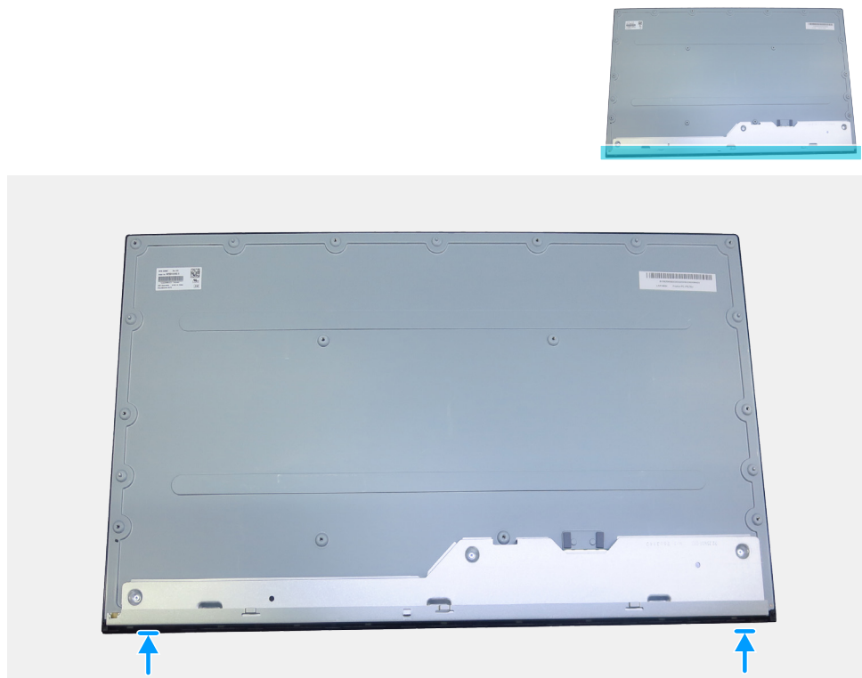
Figure 14. Installation du cadre frontal
