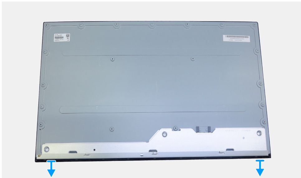
Figura 13. Desmontaje del bisel frontal
