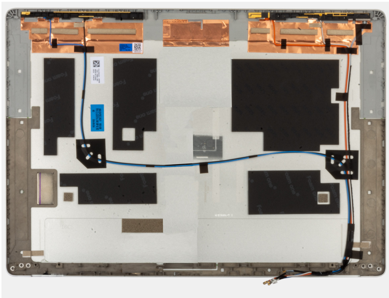
Afbeelding 80. Het achterpaneel van het beeldscherm verwijderen
