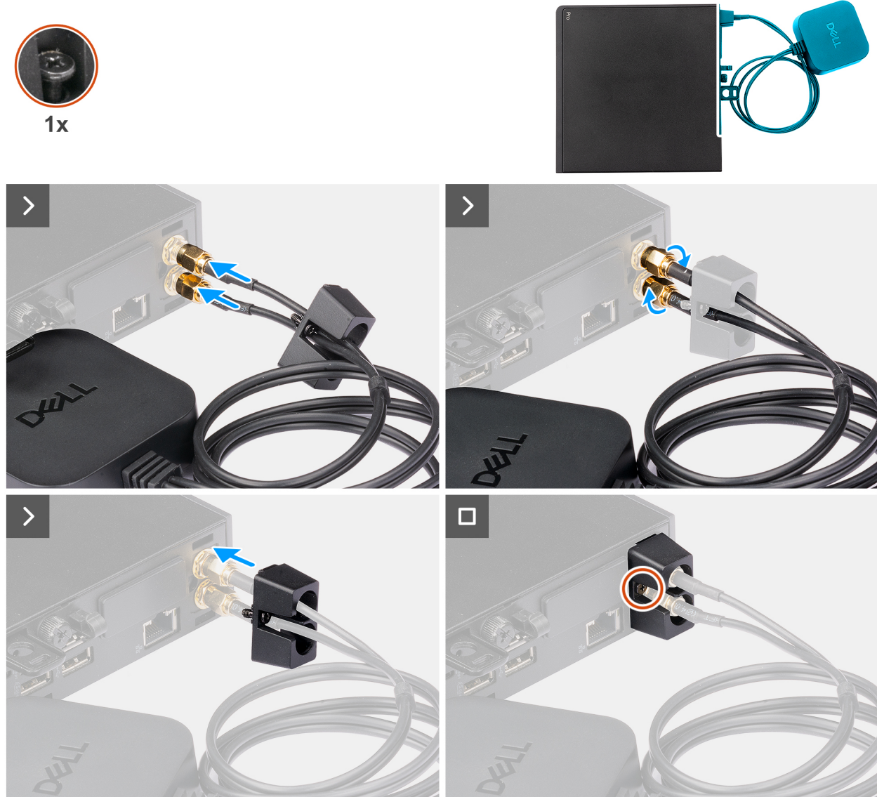
Figure 35. Installation de l'antenne Puck externe
