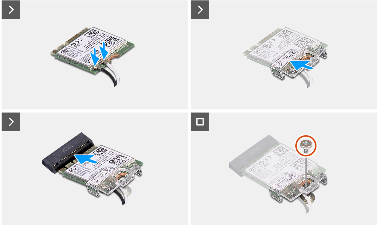
Figure 27. Installation de la carte sans fil
