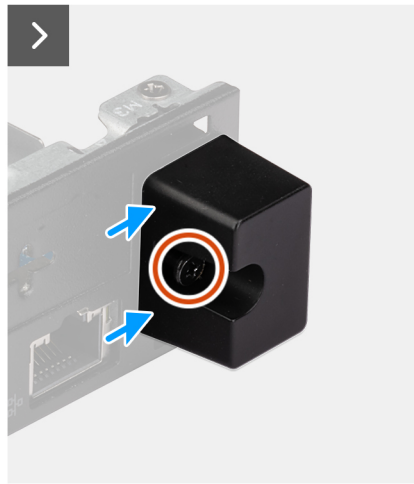
Figure 64. Retrait du module d'antenne (câble blanc)
