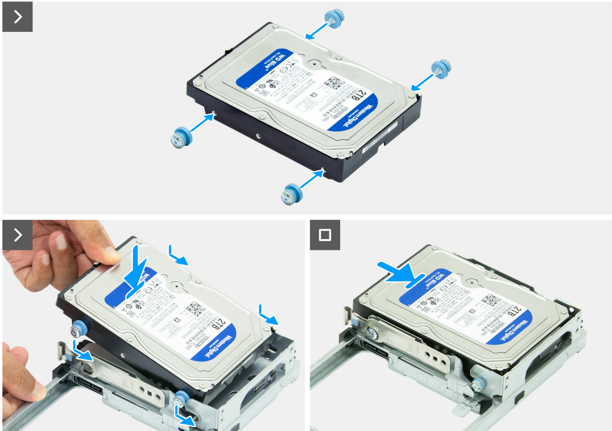
Abbildung 47. Einsetzen des Festplattenlaufwerks
