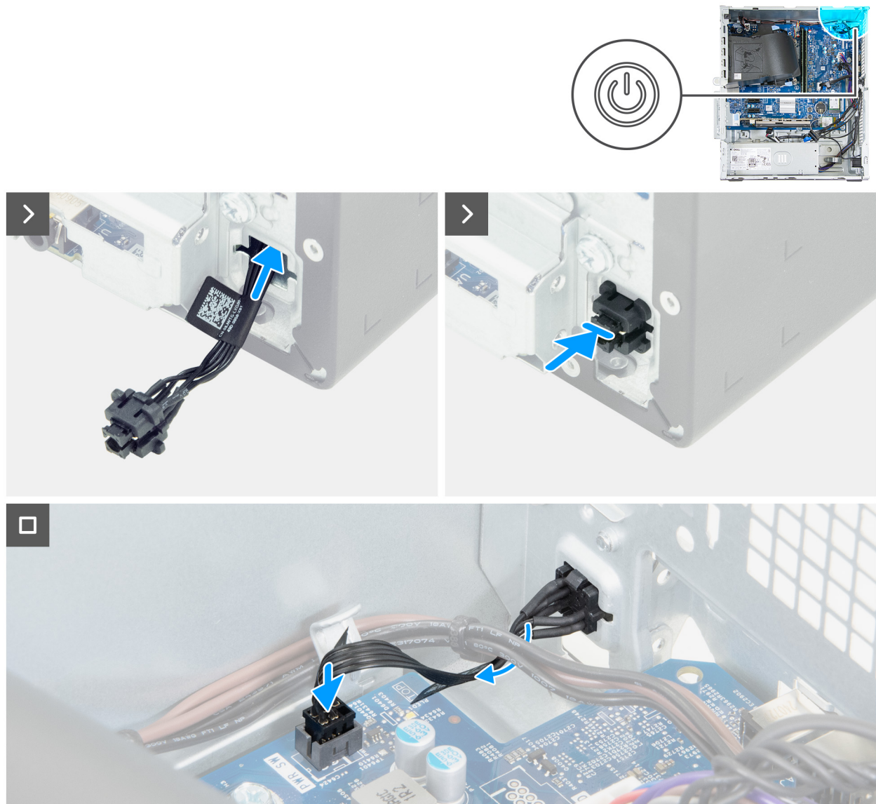
Abbildung 51. Installieren des Netzschalters
