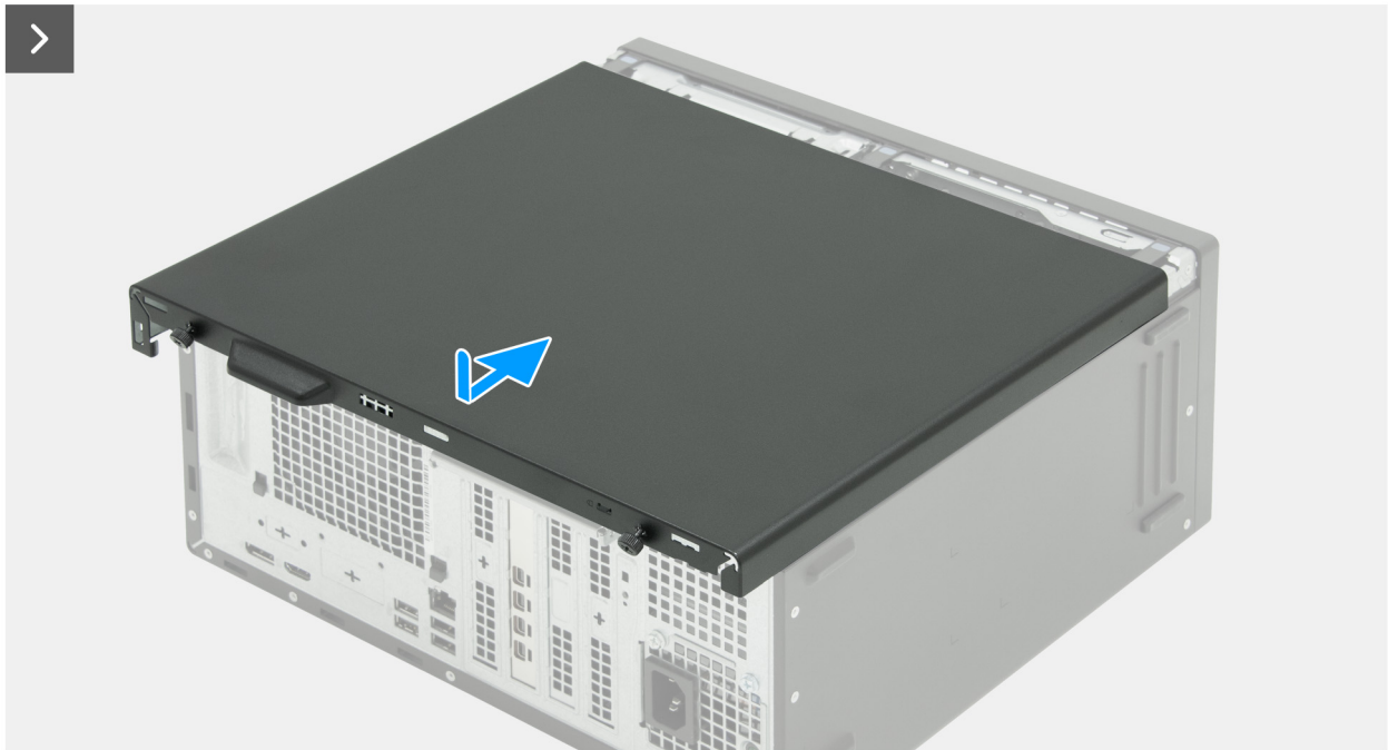
Abbildung 15. Installieren der linken Abdeckung
