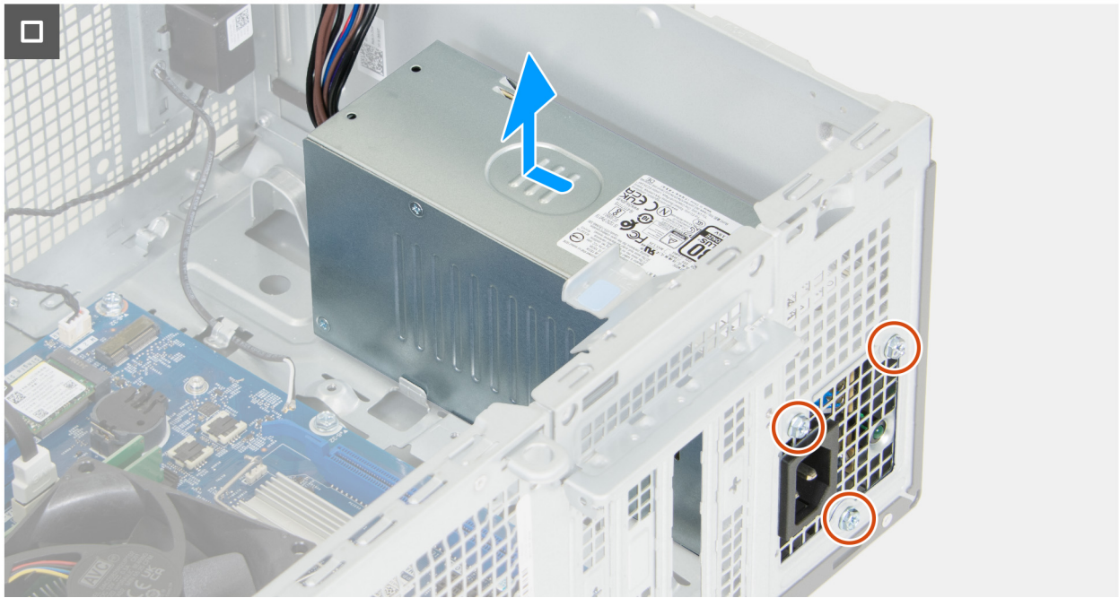
Abbildung 63. Entfernen der Stromversorgungseinheit
