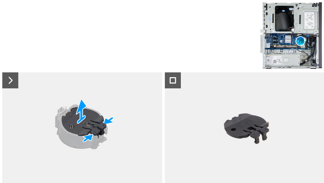
Abbildung 17. Entfernen der Abdeckung der Knopfzellenbatterie
