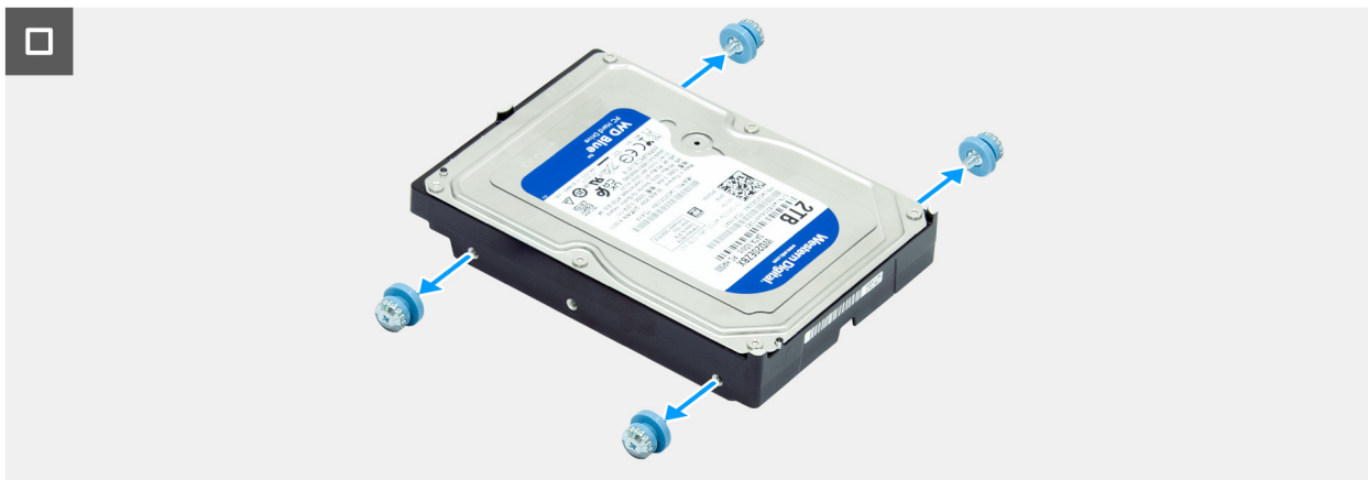
Abbildung 46. Entfernen der Festplatte
