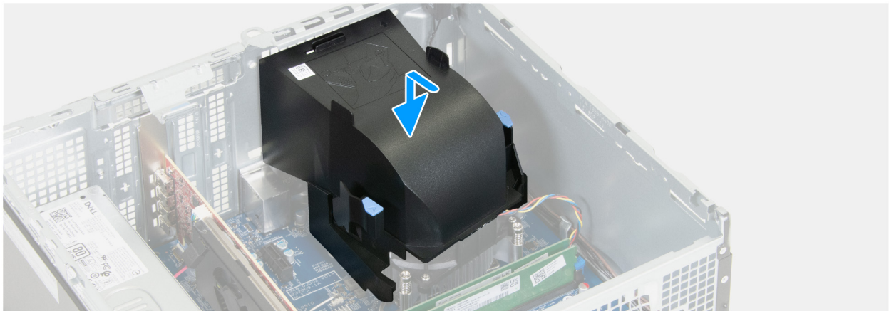
Abbildung 53. Abbildung: Einbauen der Lüfterverkleidung
