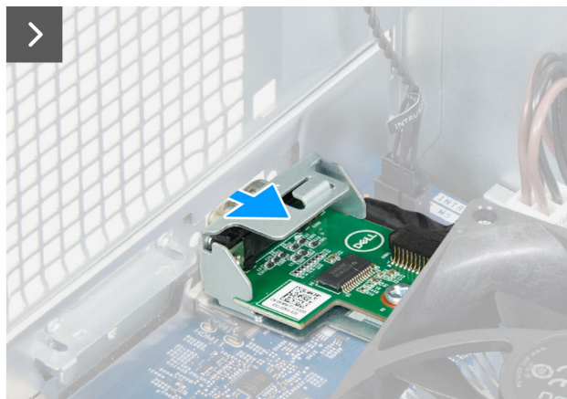
Abbildung 57. Entfernen des seriellen Anschlussmoduls
