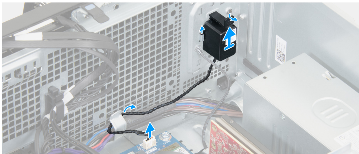
Abbildung 25. Entfernen des internen Lautsprechers
