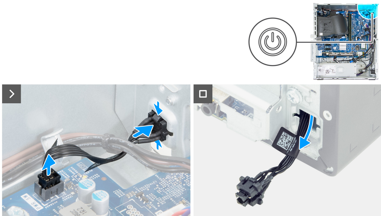
Abbildung 50. Entfernen des Netzschalters
