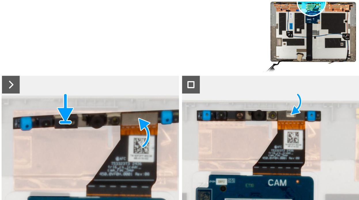
Figure 76. Installation du module de caméra
