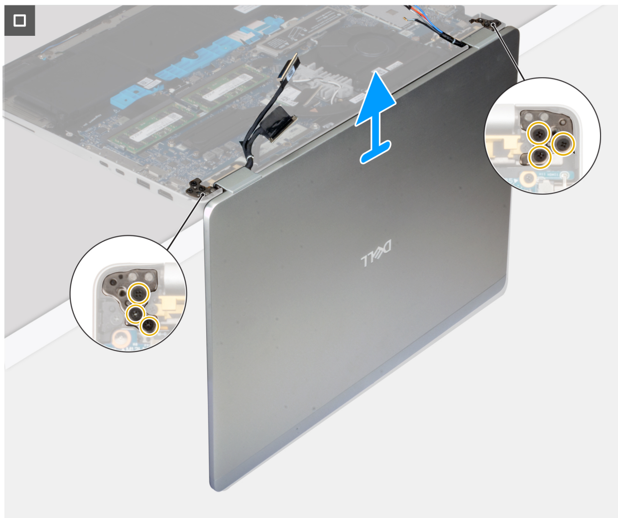
Figure 59. Retrait de l'assemblage d'écran
