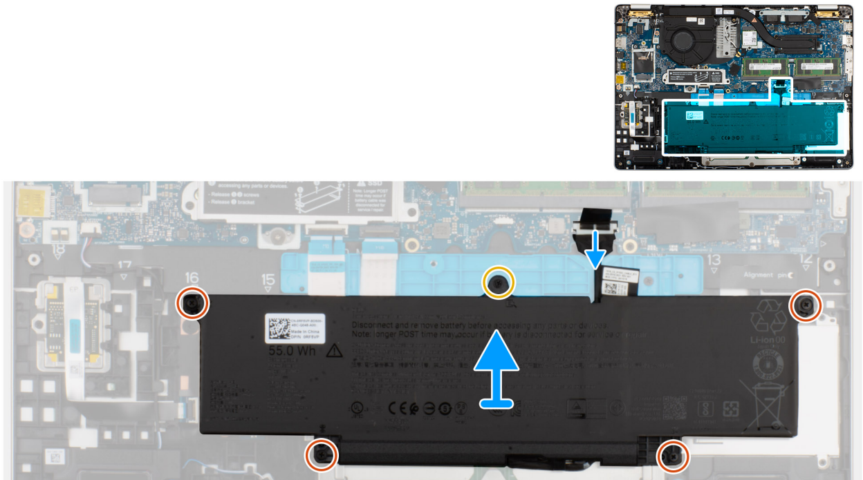
Afbeelding 15. De batterijkabel loskoppelen
