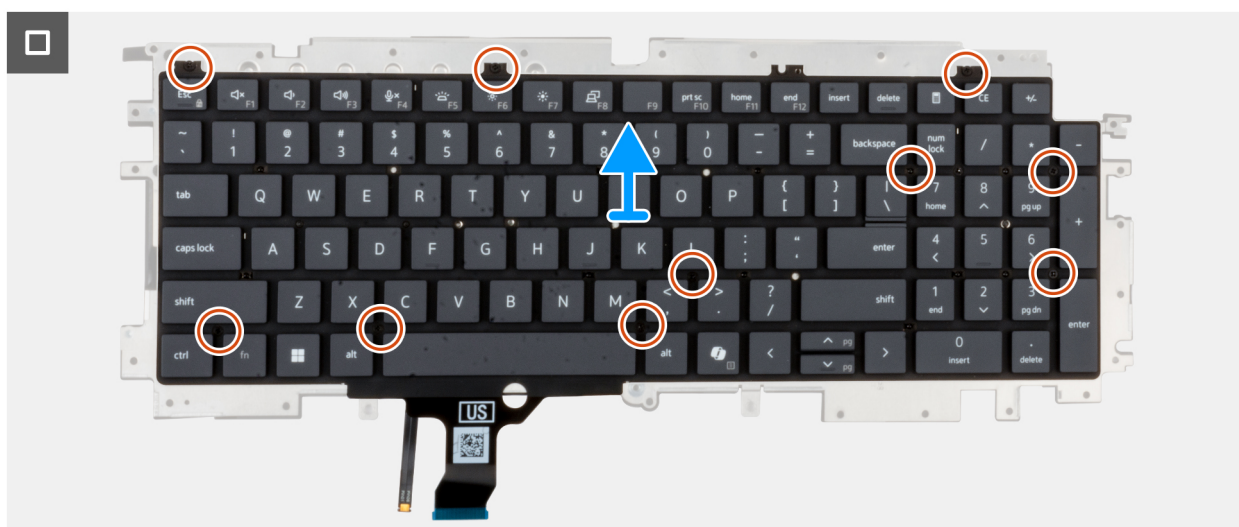
Afbeelding 82. Het toetsenbord verwijderen
