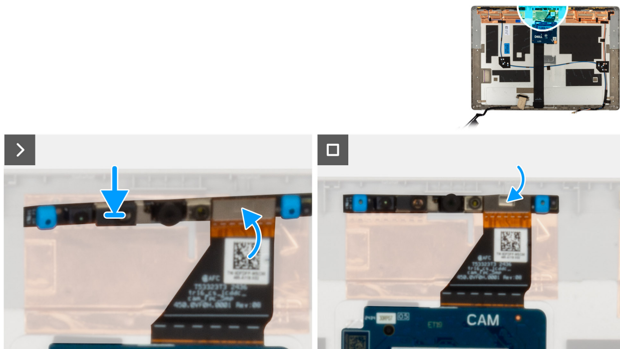
Afbeelding 76. De cameramodule installeren
