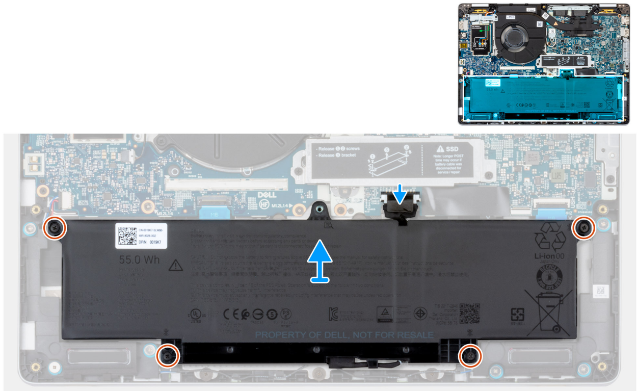
Figure 15. Déconnexion du câble de la batterie
