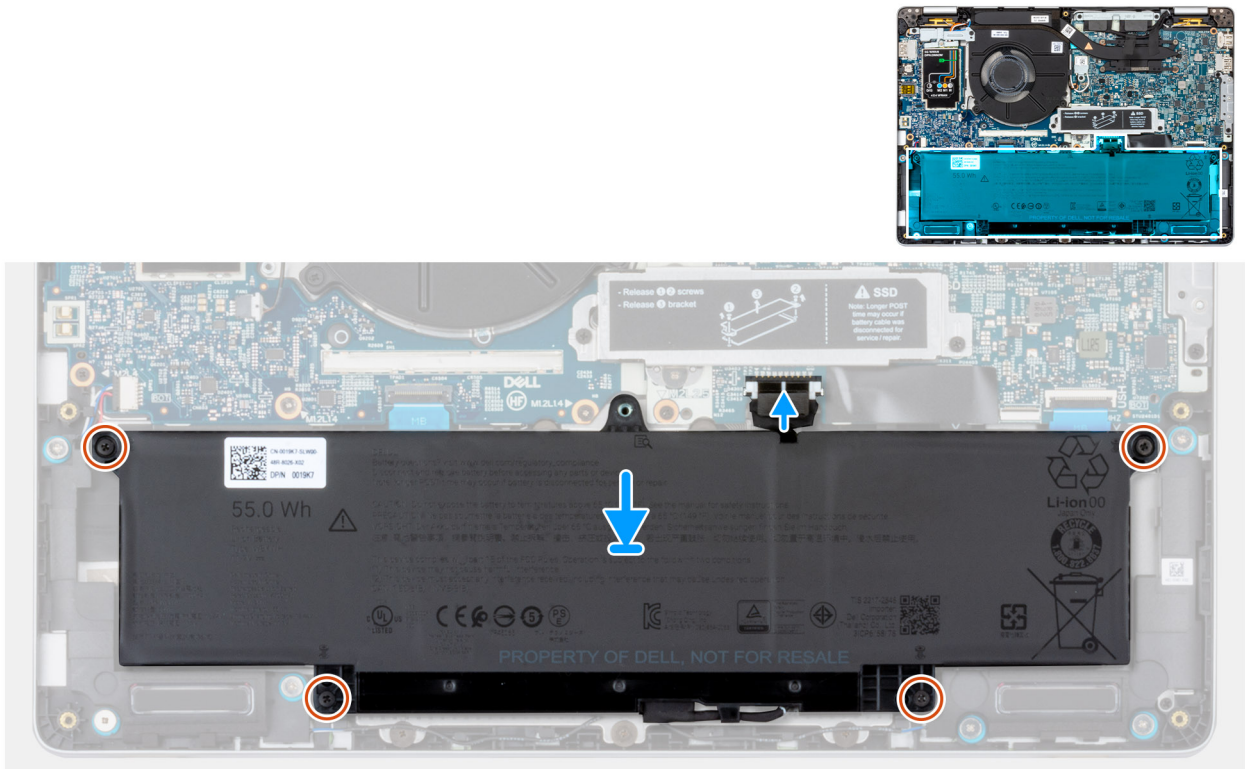
Figure 16. Connexion du câble de la batterie
