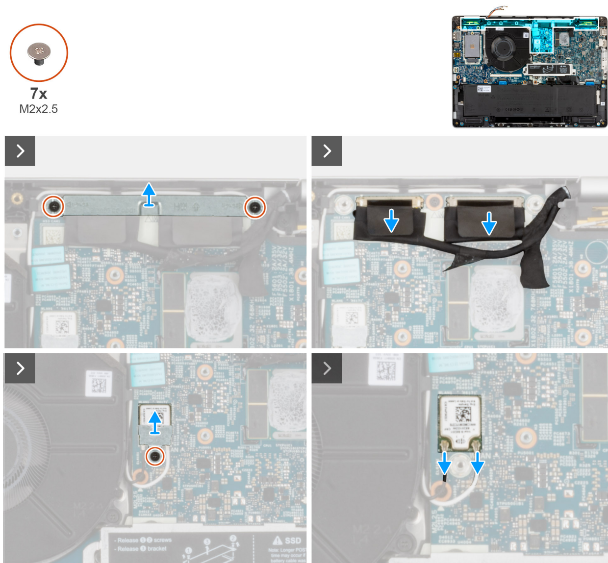
Figure 50. Retrait du module d'antenne WLAN
