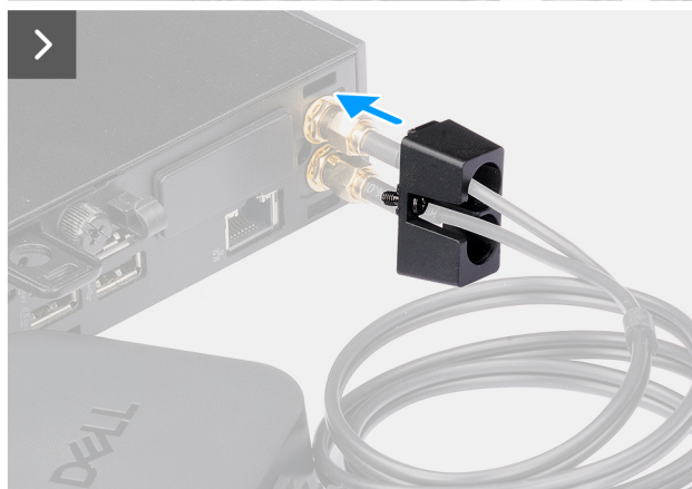
Obrázek 35. Montáž externí antény
