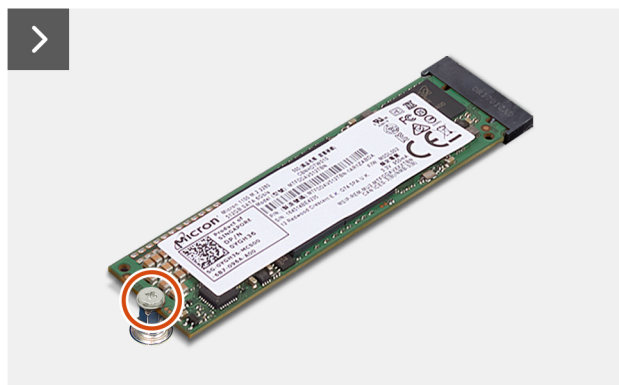
Obrázek 19. Demontáž disku SSD M.2 2280
