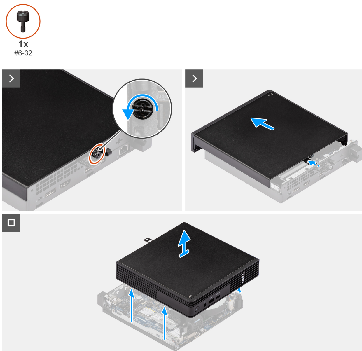
Obrázek 10. Demontáž bočního krytu
