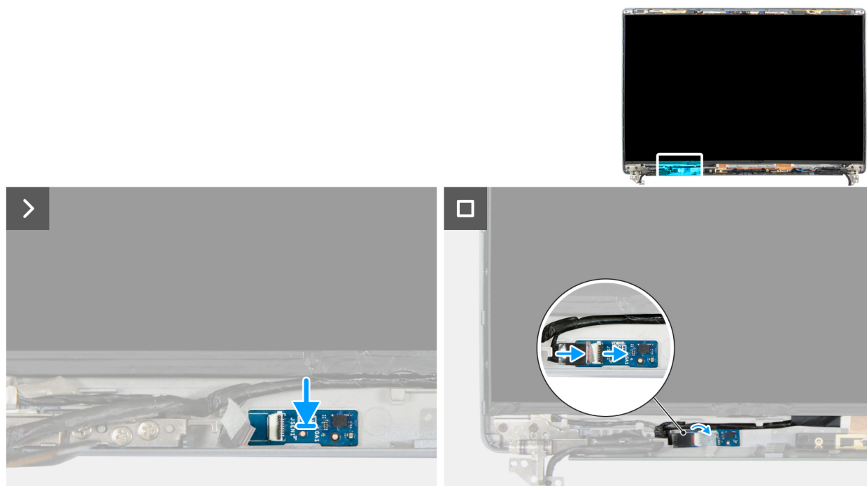
איור 102. התקנת לוח החיישן
