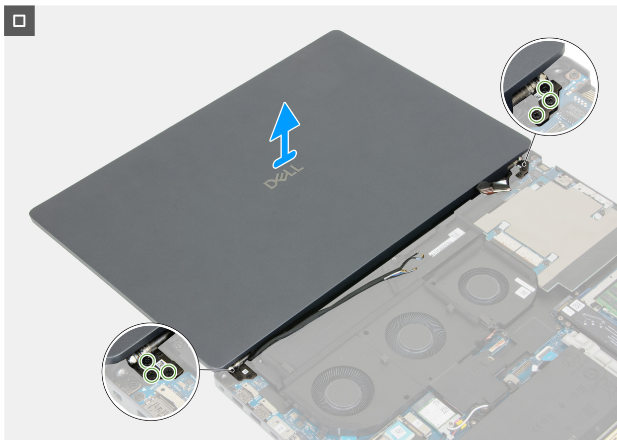
Rysunek 64. Wymontowywanie zestawu wyświetlacza
