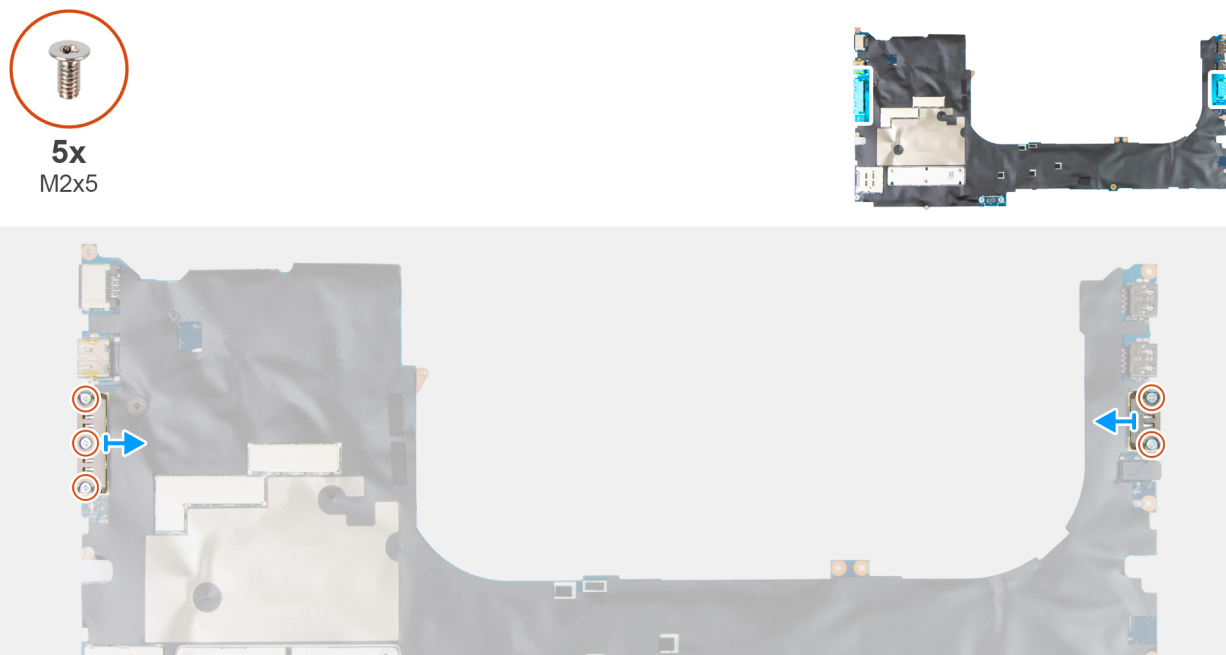
Rysunek 115. Wymontowywanie modułu złącza USB Type-C
