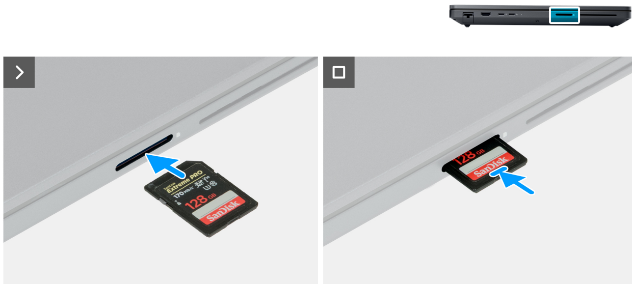
Rysunek 11. Instalowanie karty sieci SD
