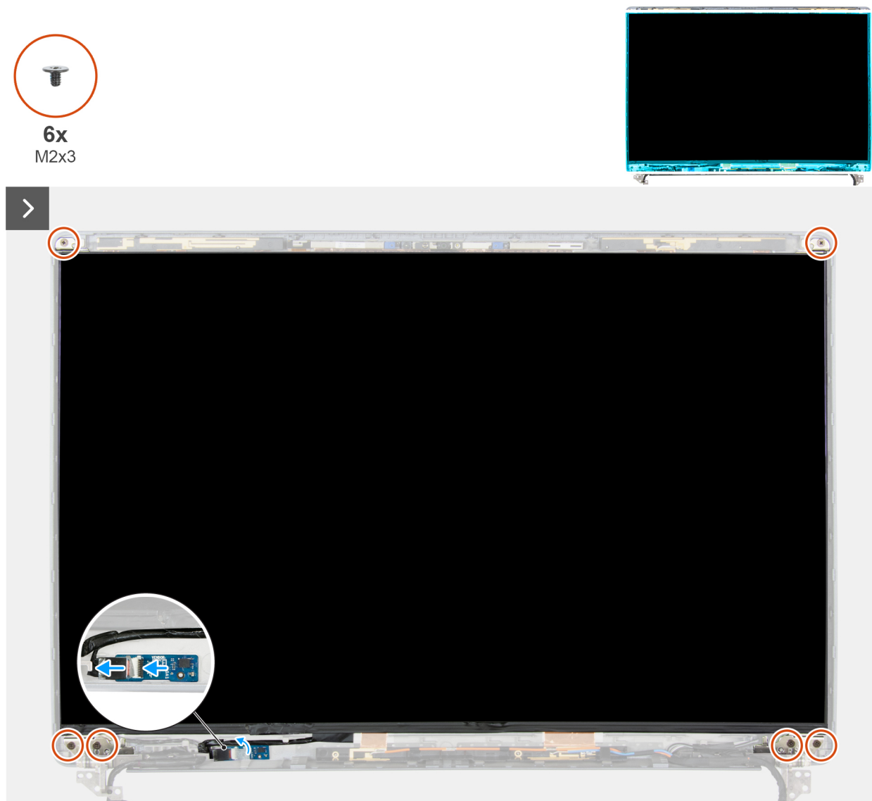
Rysunek 95. Wymontowywanie wyświetlacza
