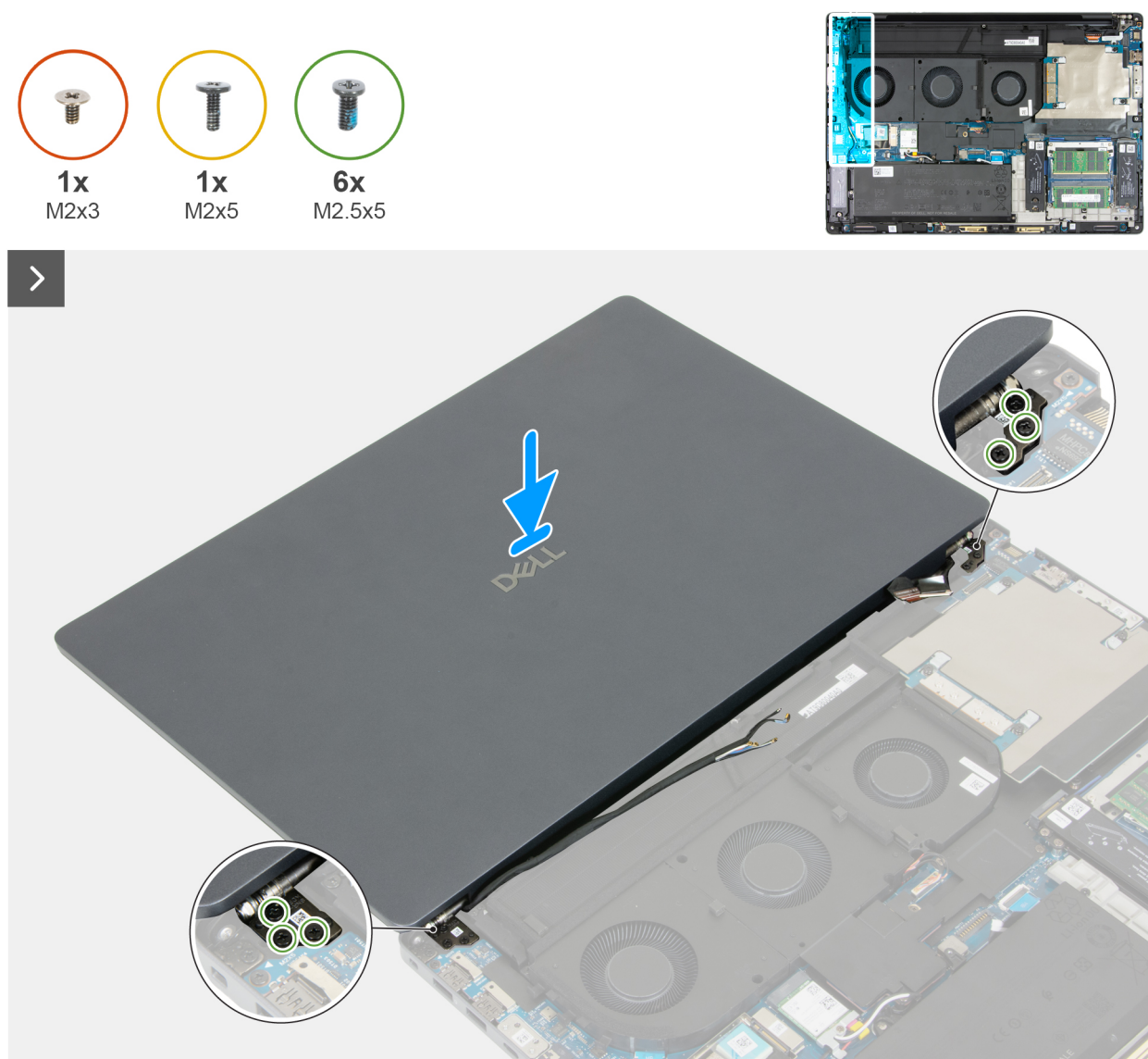
Rysunek 65. Instalowanie zestawu wyświetlacza
