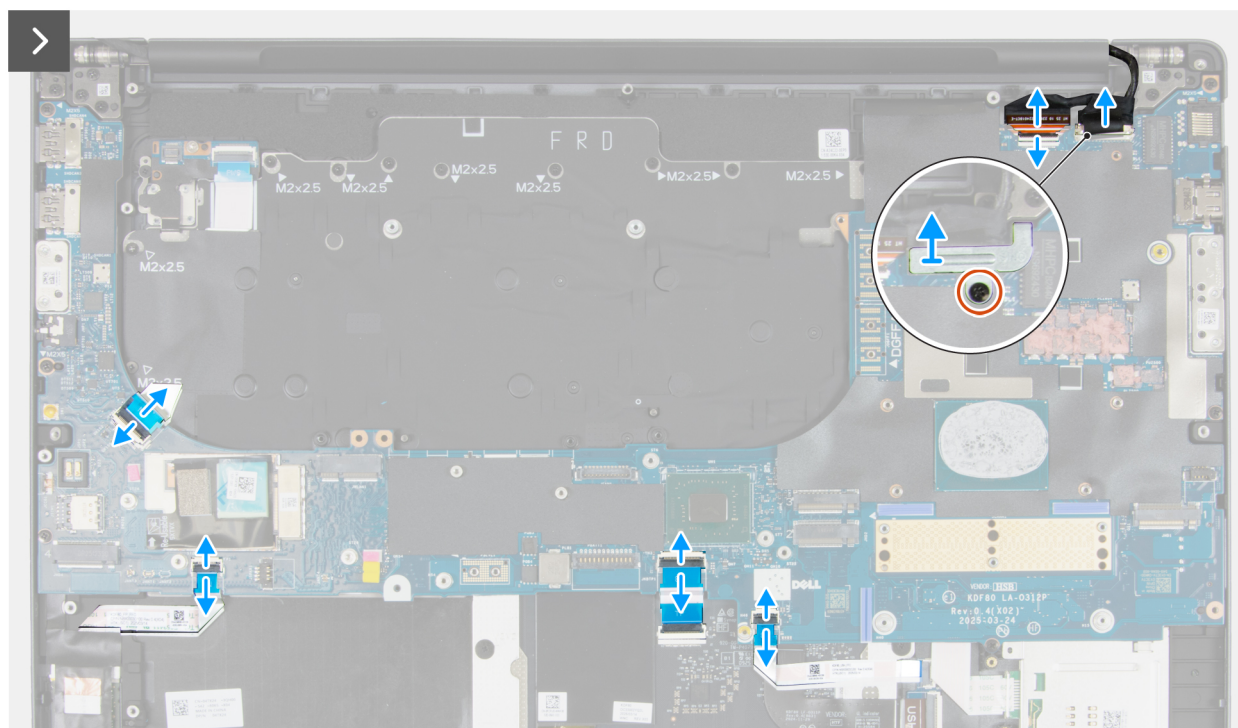
Rysunek 109. Wymontowywanie płyty głównej
