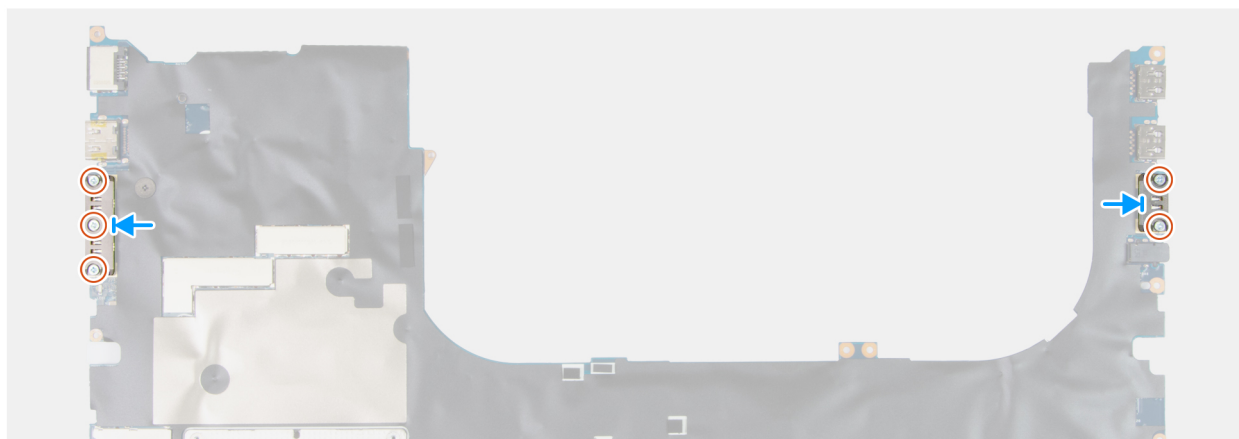
Rysunek 116. Instalowanie modułu złącza USB Type-C
