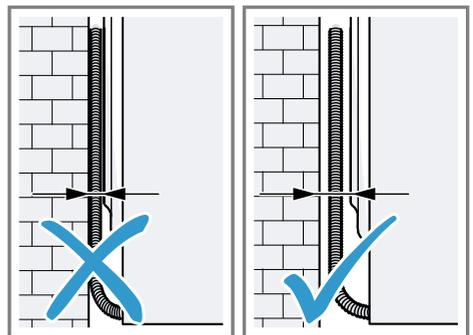
Keine Schläuche und Netzanschlussleitung zwischen Wand und Gerät einklemmen.
