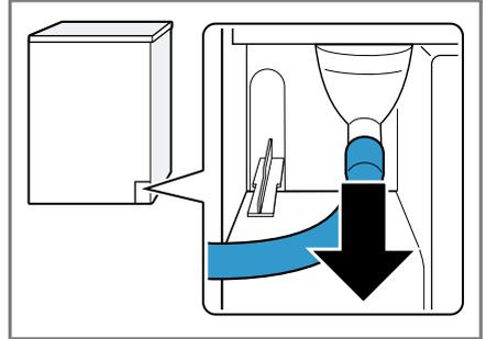
Der Kondenswasserschlauch ist werkseitig am Stutzen angeschlossen.
