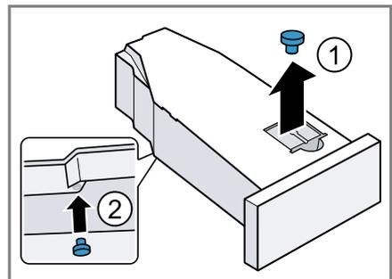
2. Den Filter im Kondenswasserbehälter reinigen.
