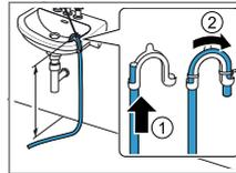
Den Wasserablaufschlauch komplett durch den Krümmer schieben und mit dem Befestigungsmaterial fixieren. Den Krümmer in maximal 100 cm Höhe befestigen.
