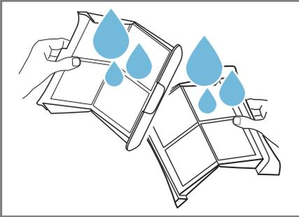
**Hinweis:** Das Reinigungswasser in einem Gefäß sammeln, z. B. einem Eimer. Nach dem Reinigen den Inhalt des Gefäßes durch einen Filter gießen, z. B. einen Kaffeefilter. Den Kaffeefilter im Hausmüll entsorgen, um eine Verunreinigung des Abwassers durch Mikroplastik zu vermeiden.
