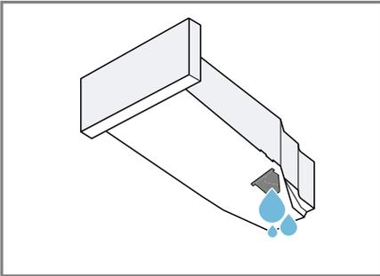
Prüfen Sie regelmäßig den Filter des Kondenswasserbehälters und reinigen Sie einen verunreinigten Filter. → *Seite 31*
