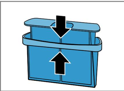
8. Das zweiteilige Flusensieb einsetzen.
