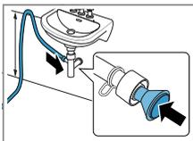
Die Anschlussstelle mit einer Schlauchschelle (12-22 mm) sichern. Den Wasserablaufschlauch mit einer Schlauchführung in minimal 80 cm und maxi-
