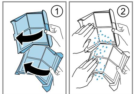
Die Flusen im Hausmüll entsorgen, um eine Verunreinigung des Abwassers durch Mikroplastik zu vermeiden.
