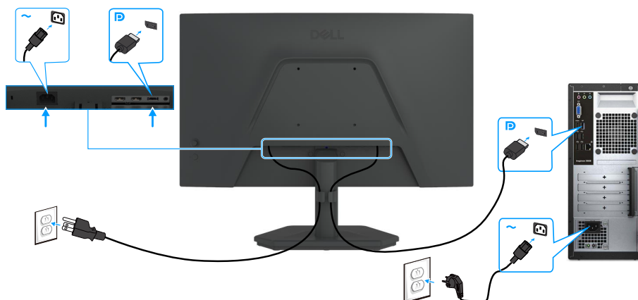
Abbildung 15. Anschließen des DisplayPort-Kabels
