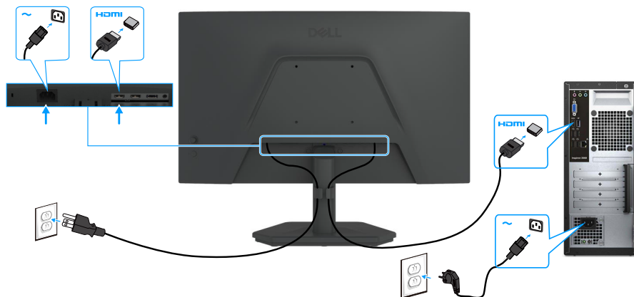
Abbildung 14. Anschließen des HDMI-Kabels
