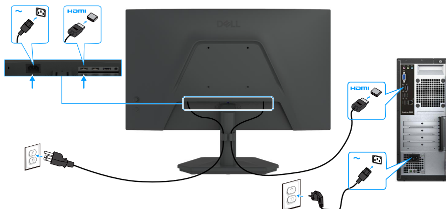
Afbeelding 14. De HDMI-kabel aansluiten
