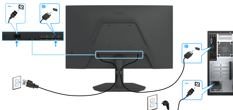
Afbeelding 15. De DisplayPort-kabel aansluiten
