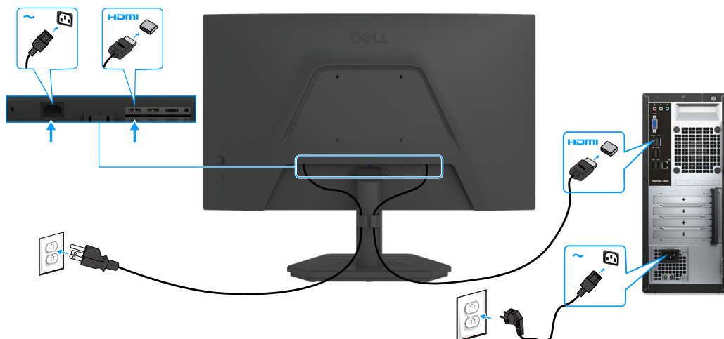
Figure 6. Branchement du câble HDMI
