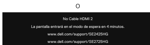
Figura 33. Mensaje de advertencia: No hay cable HDMI 2 conectado
