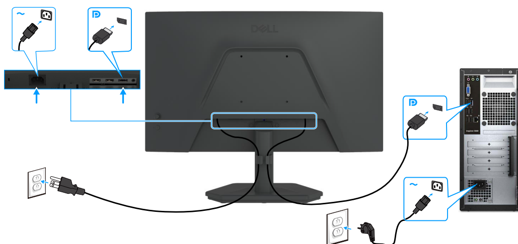
Figure 7. Branchement du câble DisplayPort
