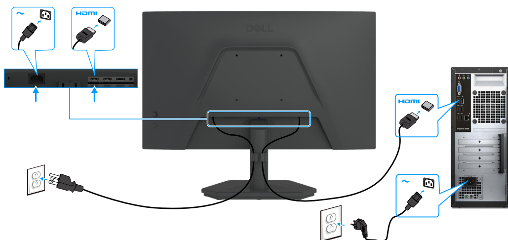
Figure 6. Branchement du câble HDMI
