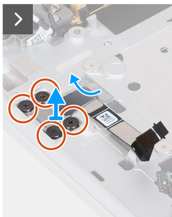
Afbeelding 42. De aan-uitknop met vingerafdrukkezer verwijderen
