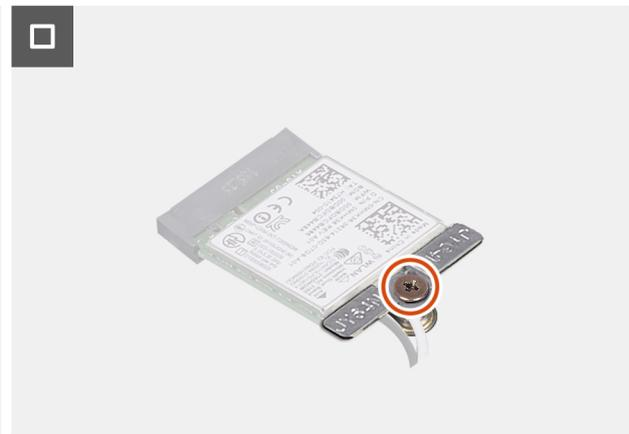
Abbildung 28. Installieren der Wireless-Karte
