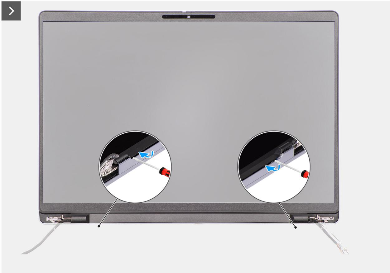
Abbildung 60. Entfernen der Bildschirmblende
