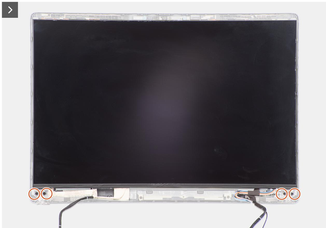
**Abbildung 68. Entfernen des Bildschirms**
