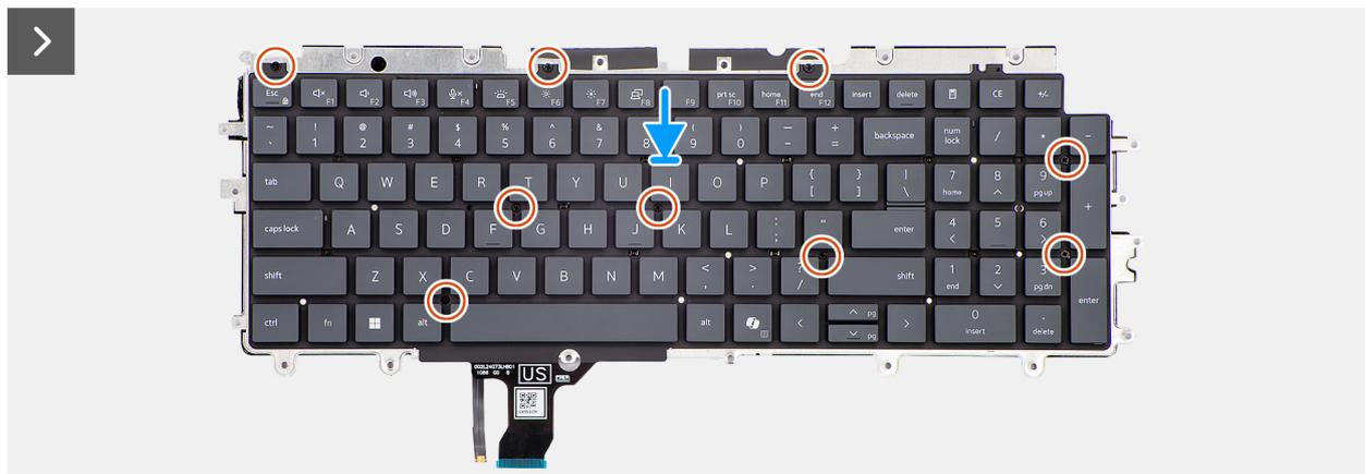
Abbildung 100. Einbauen der Tastatur
