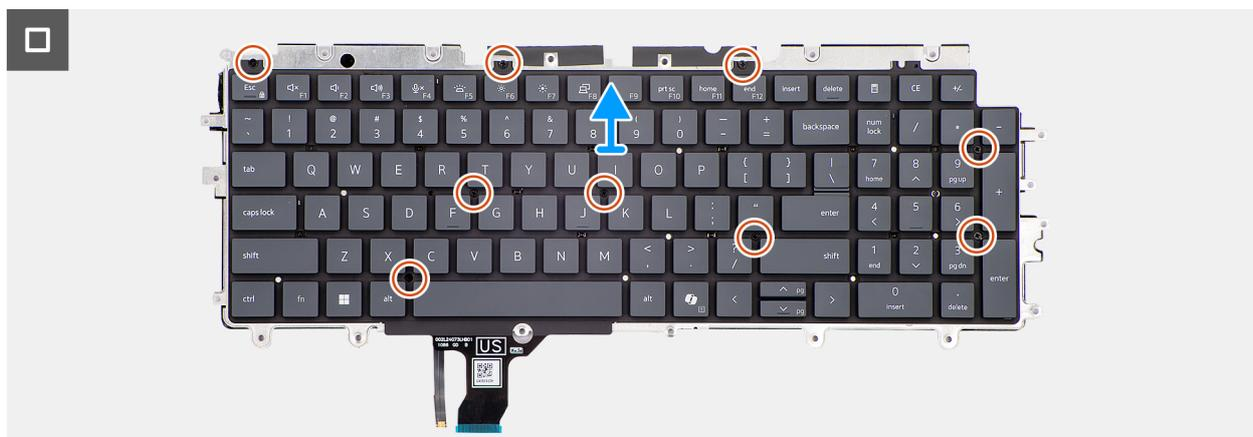
Abbildung 99. Entfernen der Tastatur
