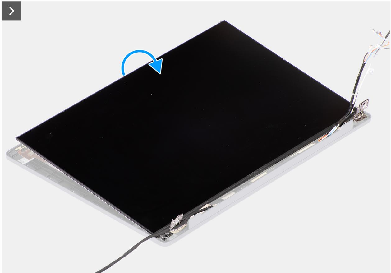
Abbildung 69. Entfernen des Bildschirms
