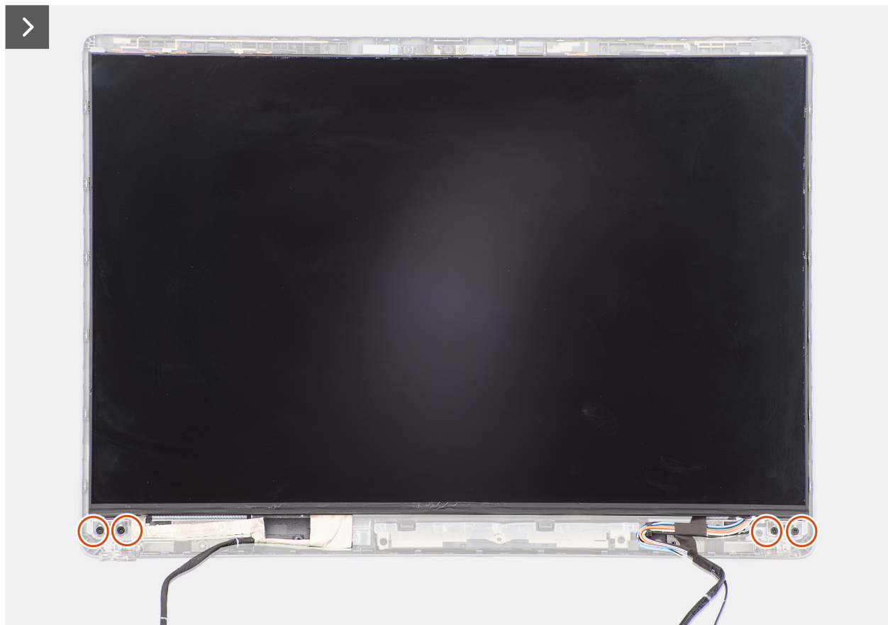
Afbeelding 68. Het beeldschermpaneel verwijderen
