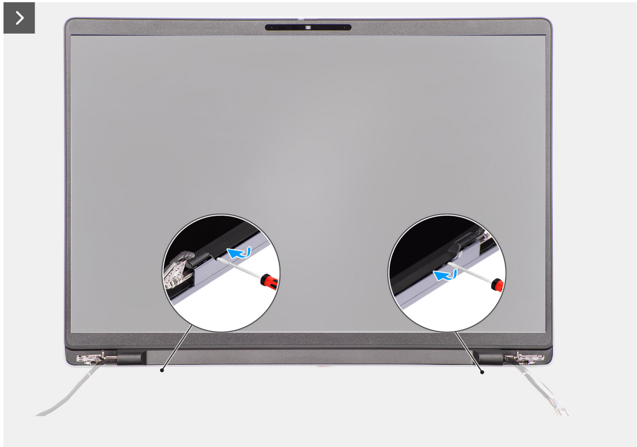
Afbeelding 60. De beeldschermbezel verwijderen
