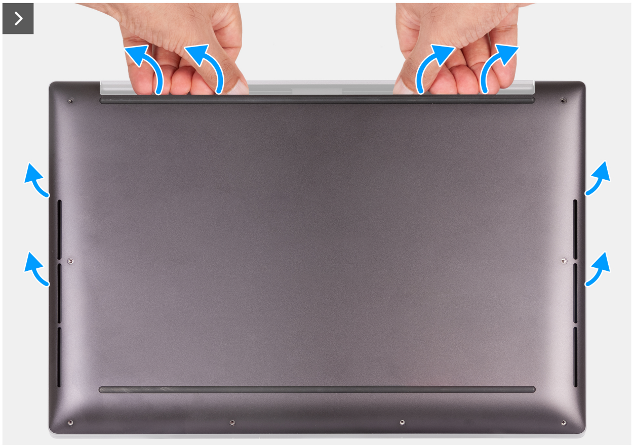
Afbeelding 2. Gebruik beide duimen om de onderplaat los te wrikken
