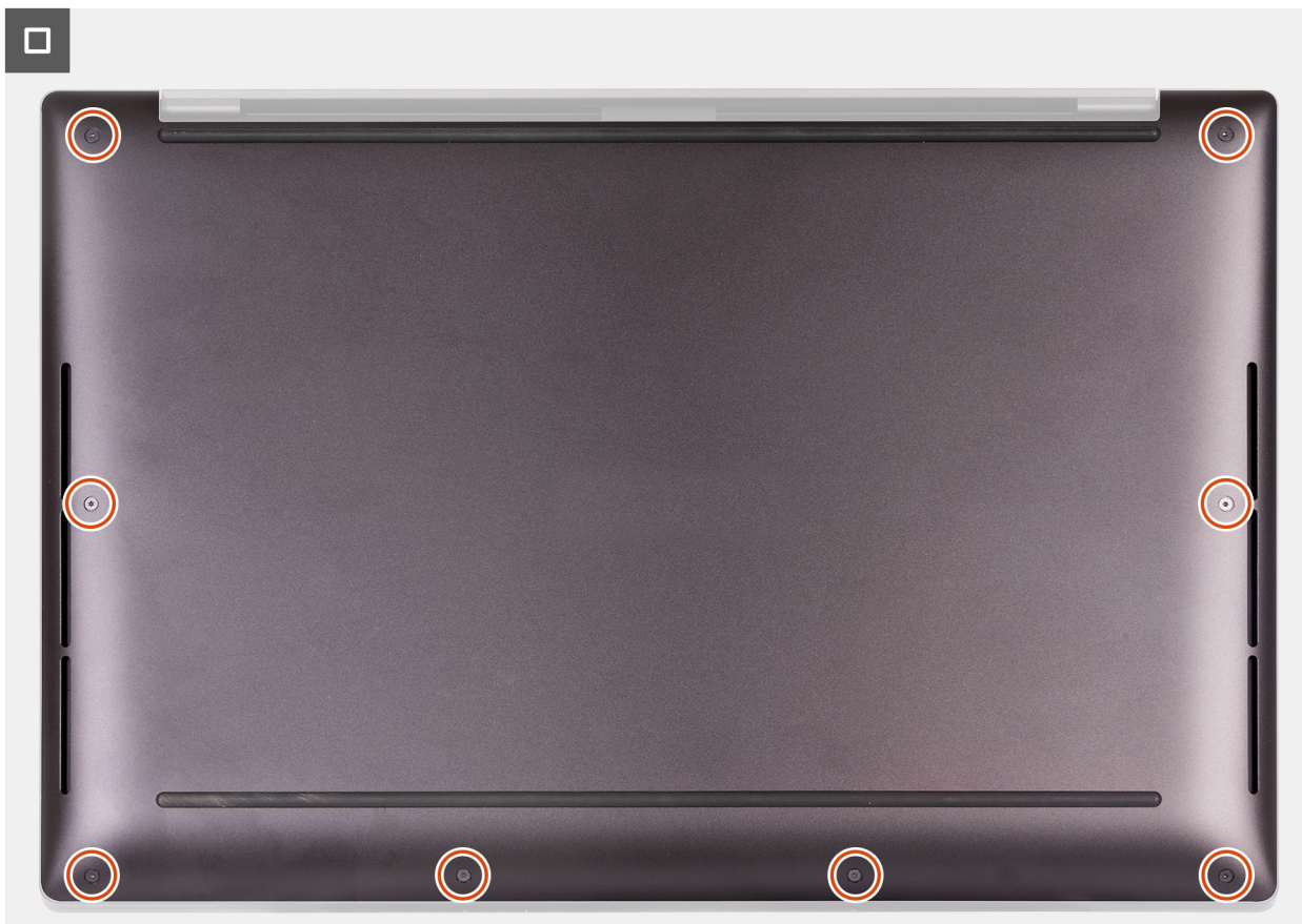
Afbeelding 8. Draai de acht schroeven vast waarmee de onderplaat aan de palmsteuneenheid is bevestigd.
