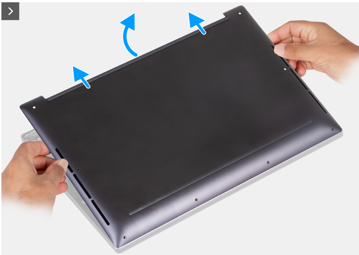
Afbeelding 3. Til de onderplaat van de palmsteuneenheid
