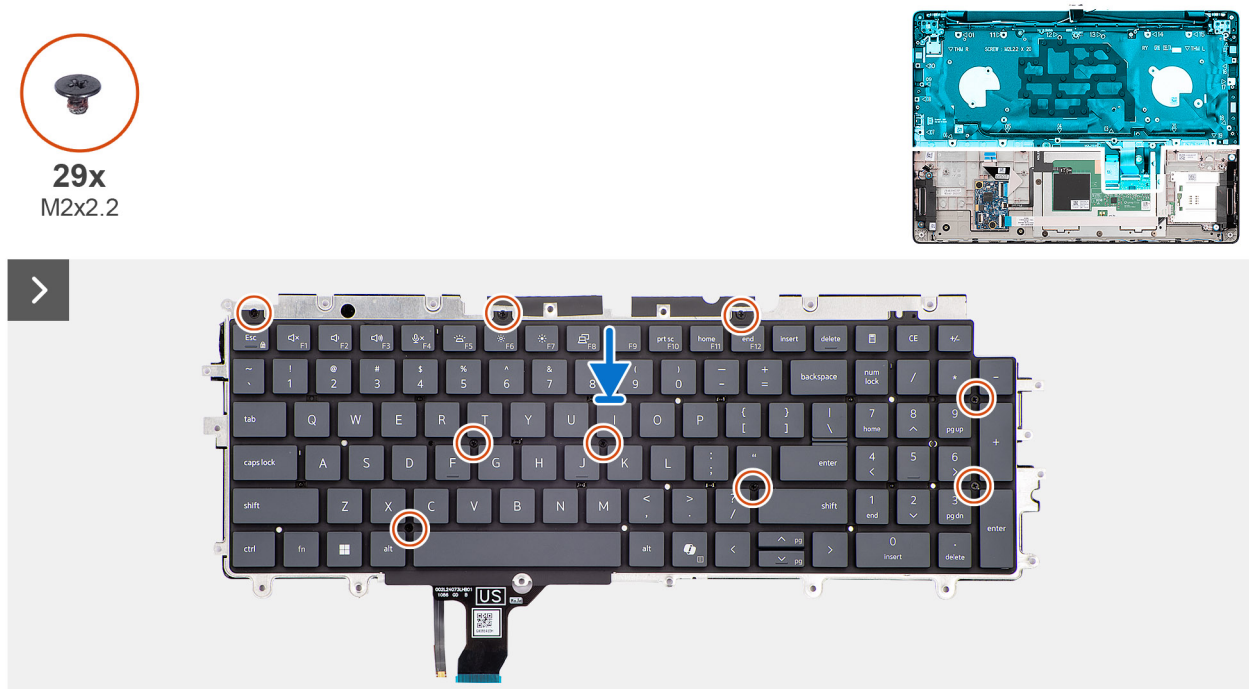
Abbildung 85. Einbauen der Tastatur
