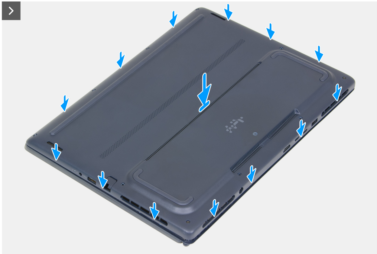
Afbeelding 16. De onderplaat installeren
