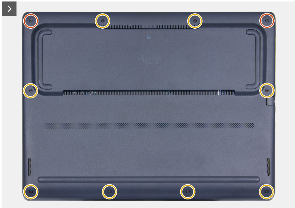
Afbeelding 11. De onderplaat verwijderen
