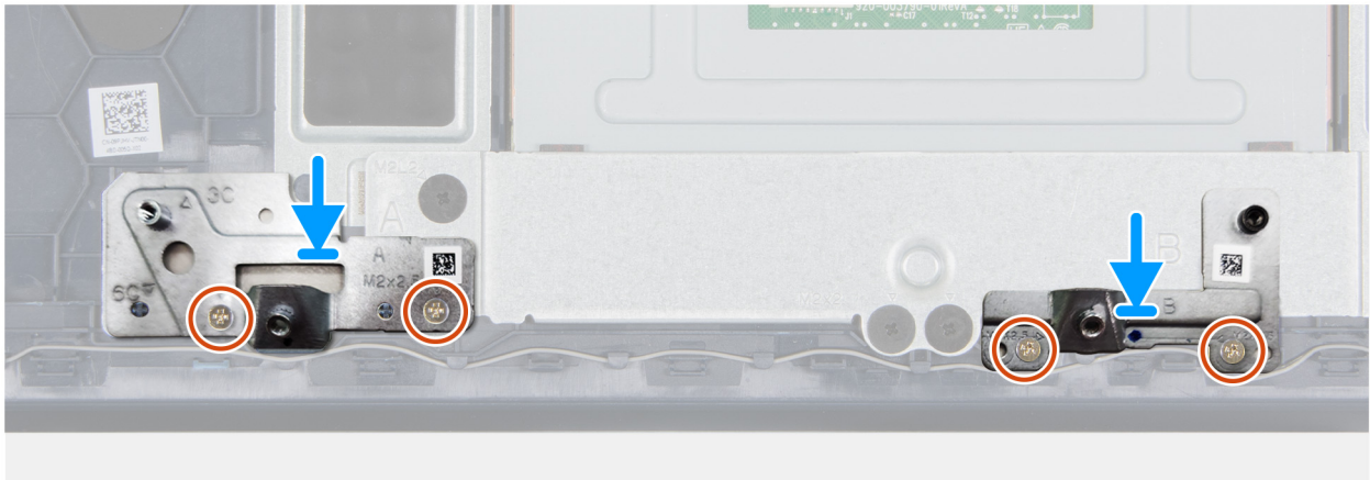
Afbeelding 43. De 3-cels batterijbeugels installeren
