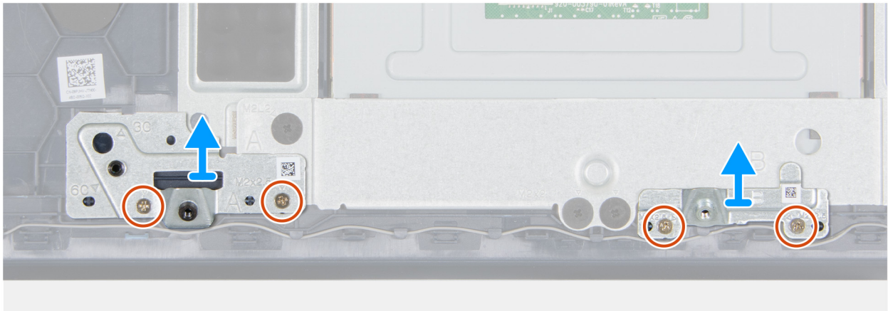
Afbeelding 44. De 6-cels batterijbeugels verwijderen
