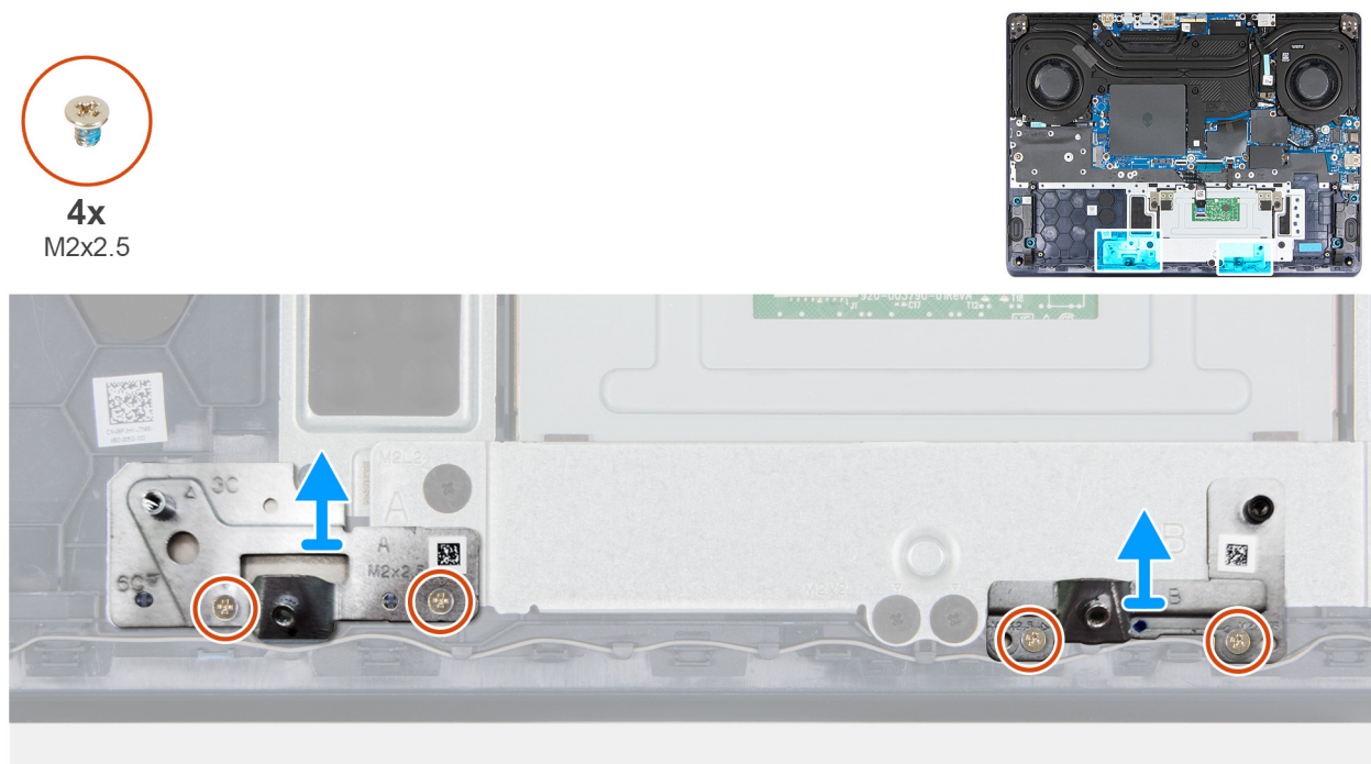
Figure 42. Retrait des supports de la batterie à 3 cellules
