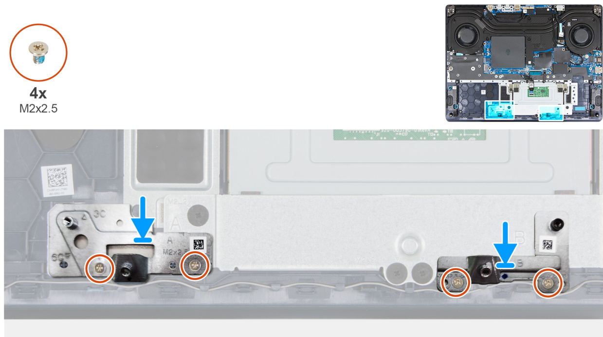
Figure 43. Installation des supports de la batterie à 3 cellules
