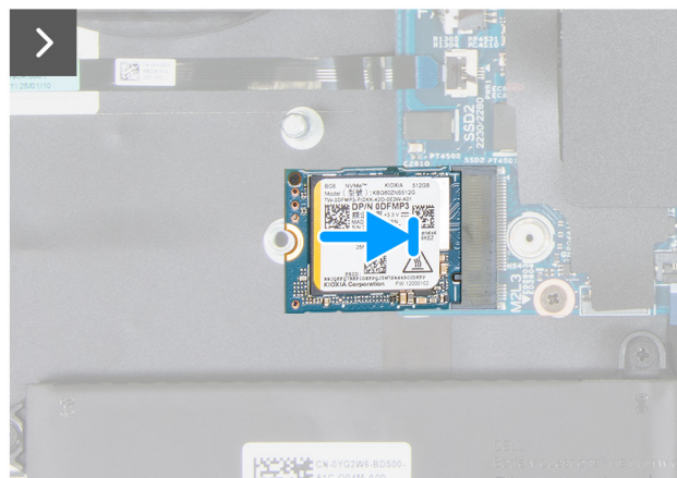
Afbeelding 26. De M.2 2230 SSD installeren in het SSD2-slot
