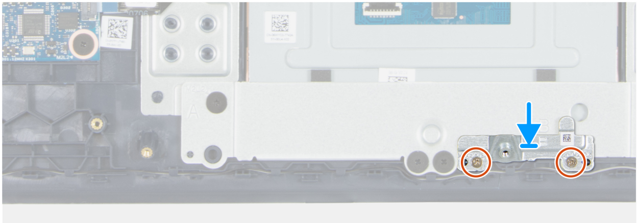
Afbeelding 42. De batterijbeugel installeren
