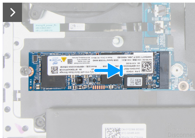
Afbeelding 30. De M.2 2280 SSD installeren in het SSD2-slot
