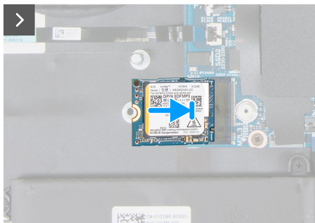
Ilustración 26. Instalación de la SSD M.2 2230 en la ranura de SSD2
