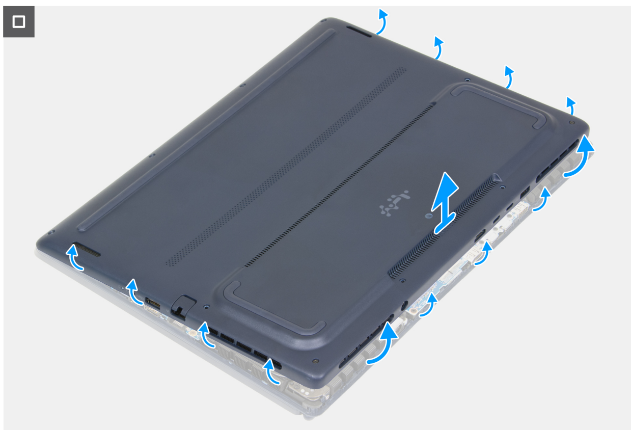
Ilustración 12. Extracción de la cubierta de la base
