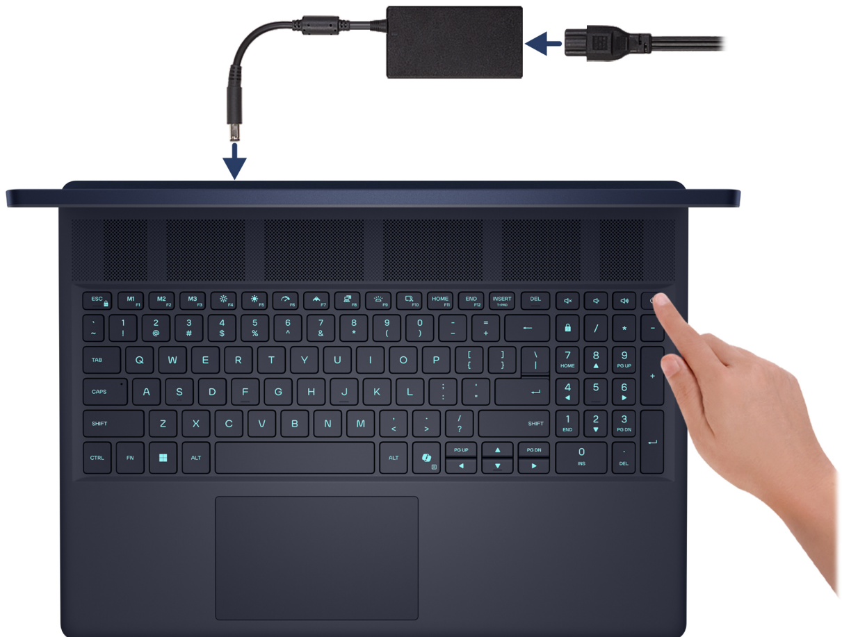
Ilustración 8. Conecte el adaptador de alimentación y presione el botón de encendido
