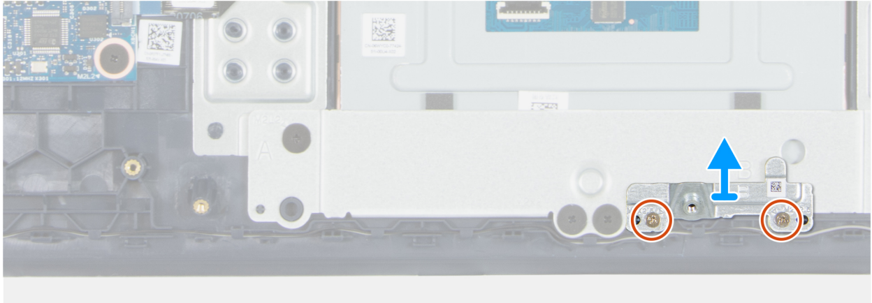
Ilustración 41. Extracción del soporte de la batería
