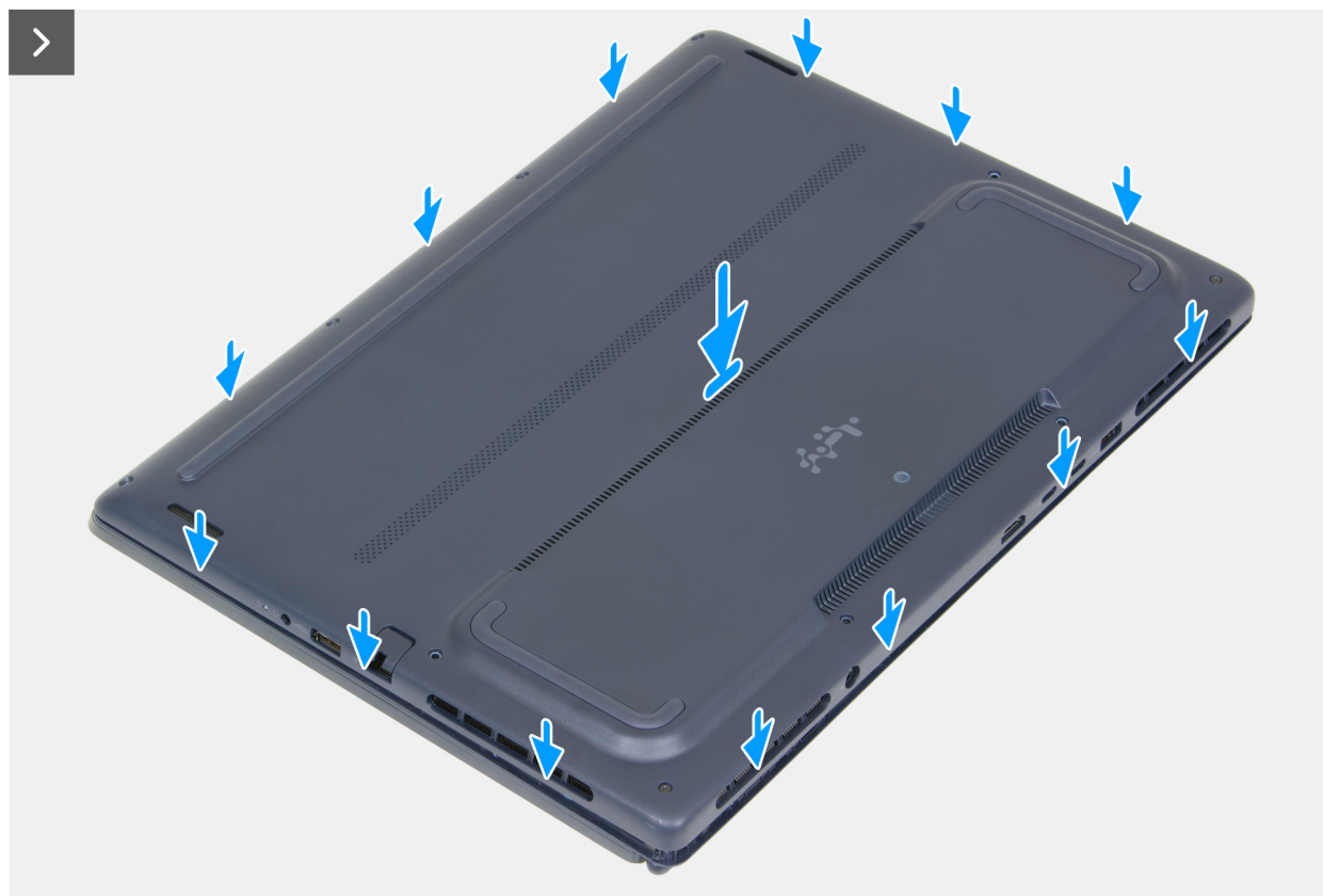
Ilustración 15. Instalación de la cubierta de la base
