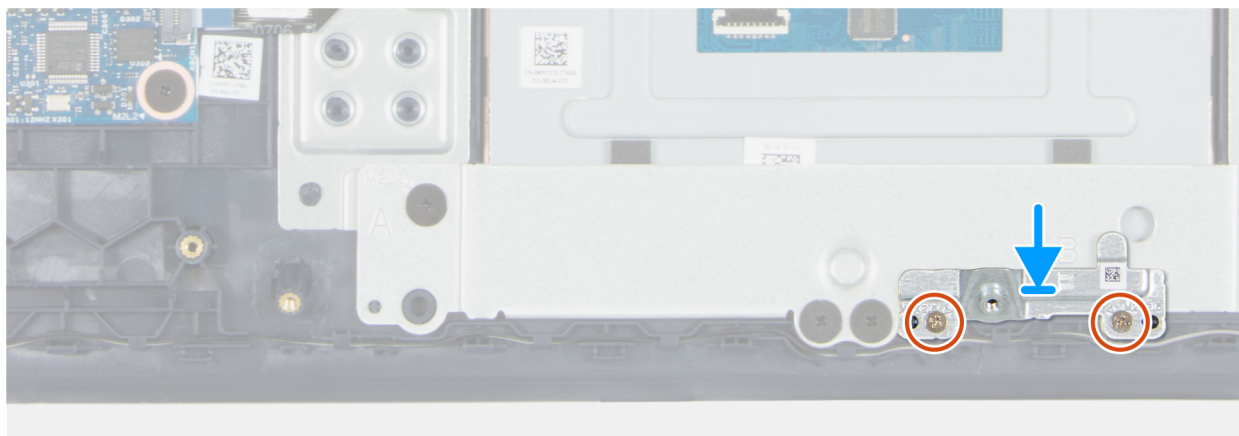
Ilustración 42. Instalación del soporte de la batería
