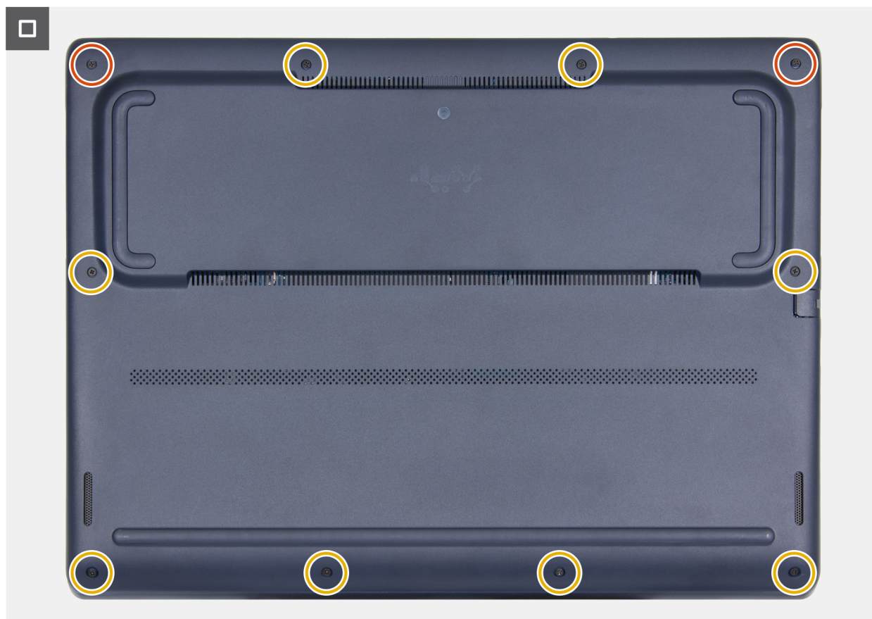
Ilustración 16. Instalación de la cubierta de la base
