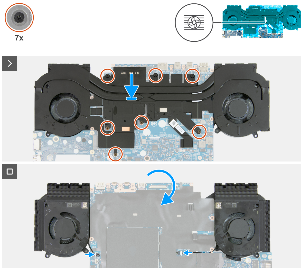
Ilustración 61. Instalación del ensamblaje del dissipador de calor y el ventilador
