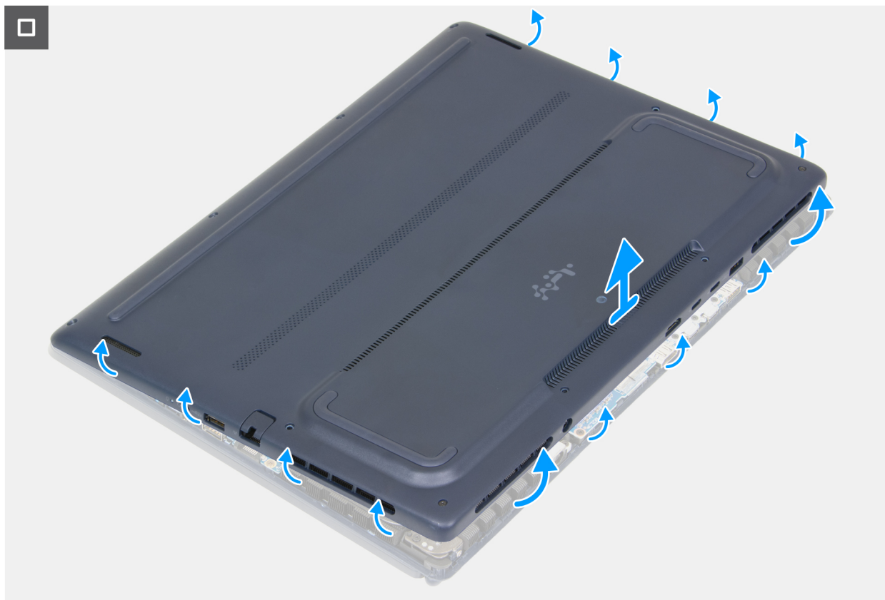
Ilustración 11. Extracción de la cubierta de la base
