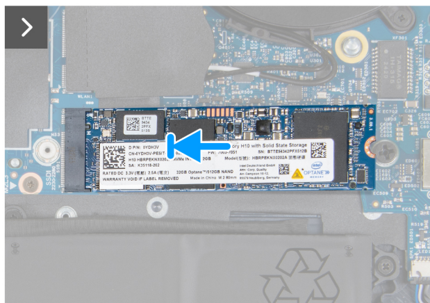
Ilustración 28. Instalación de la SSD M.2 2280 en la ranura de SSD1
