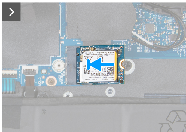
Ilustración 24. Instalación de la SSD M.2 2230 en la ranura de SSD1
