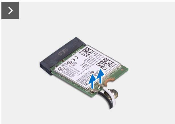
Afbeelding 25. De draadloze kaart verwijderen
