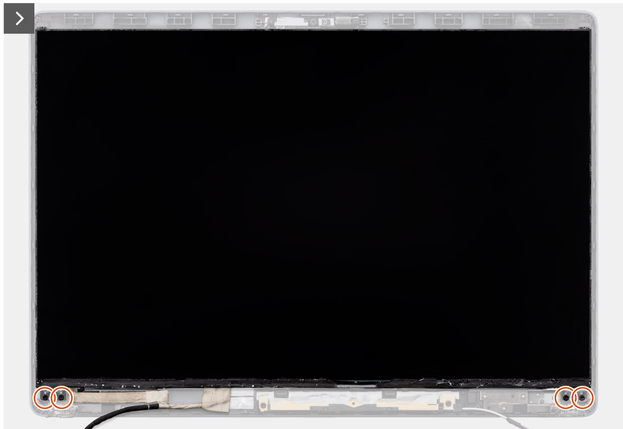
Afbeelding 58. Het beeldschermpaneel verwijderen
