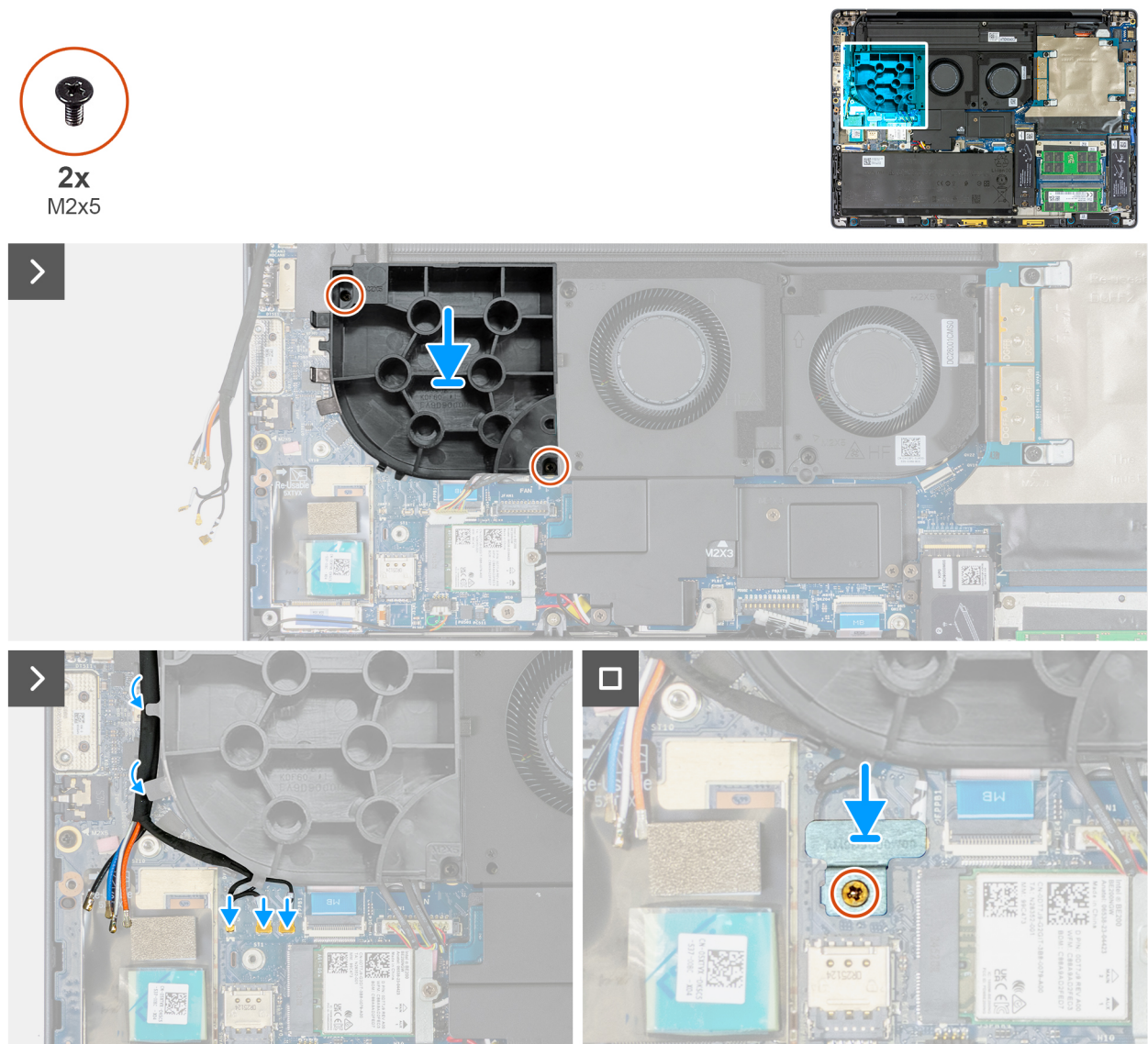
Afbeelding 60. De dummyventilator installeren
