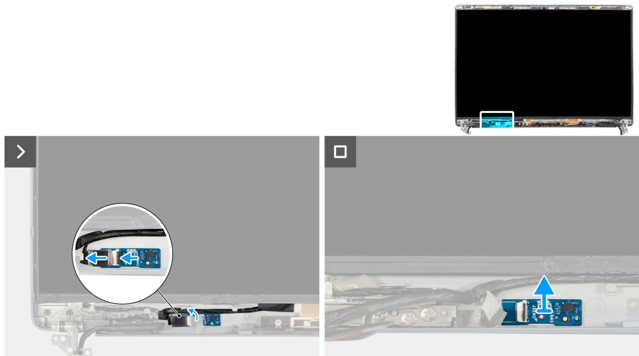
Afbeelding 101. De sensorkaart verwijderen
