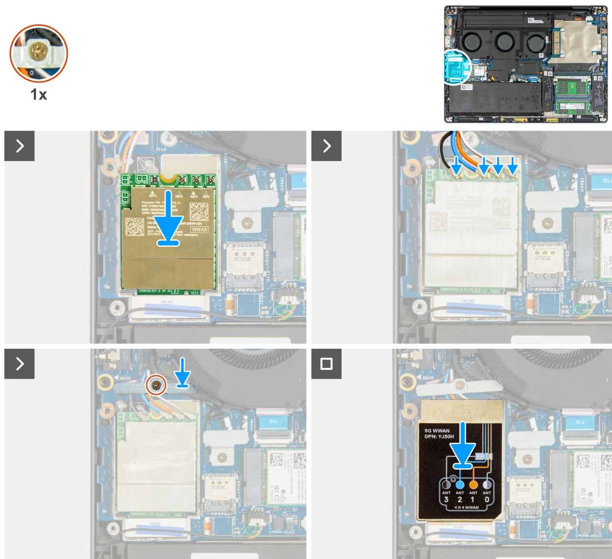
Abbildung 51. Einbauen der WWAN-Karte
