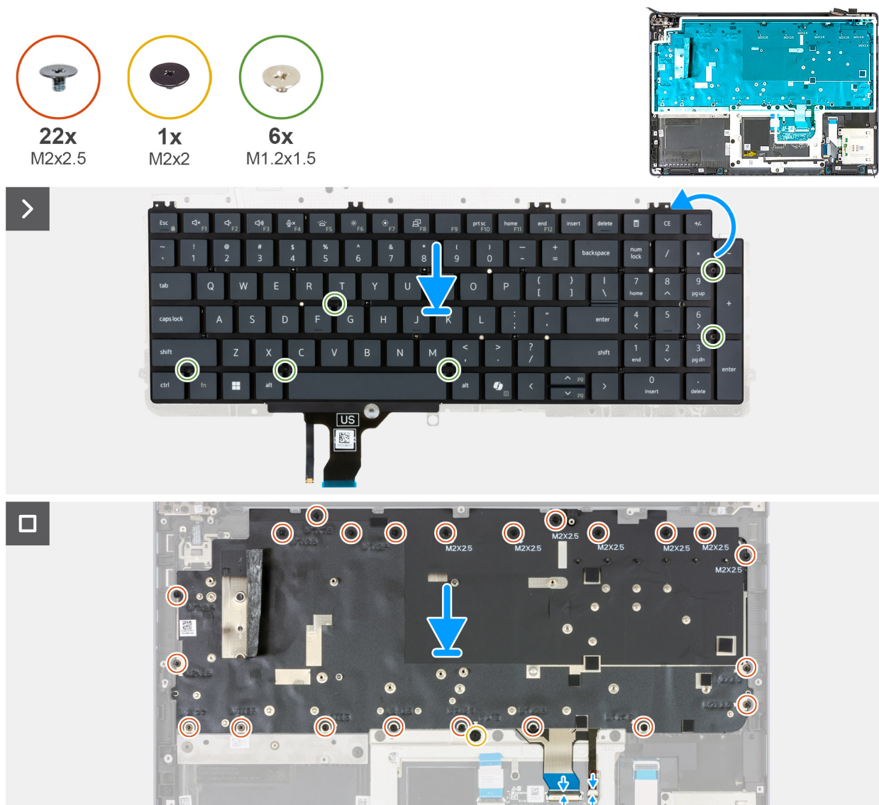
Abbildung 122. Einbauen der Tastatur
