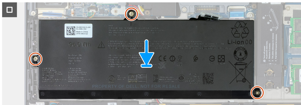
Abbildung 45. Wiedereinbau des Akkus
