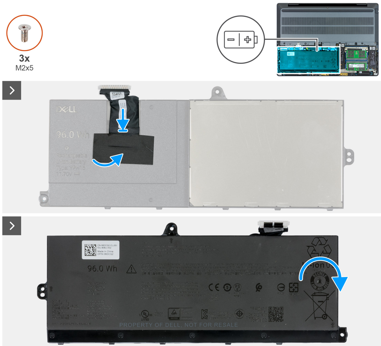
Figure 44. Remplacement du câble de la batterie
