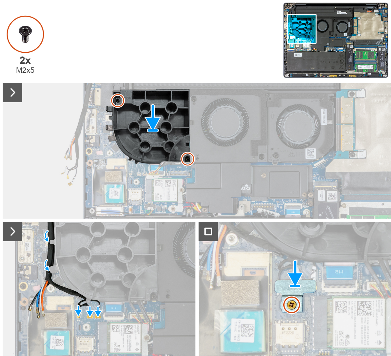
Figure 60. Installation du ventilateur factice
