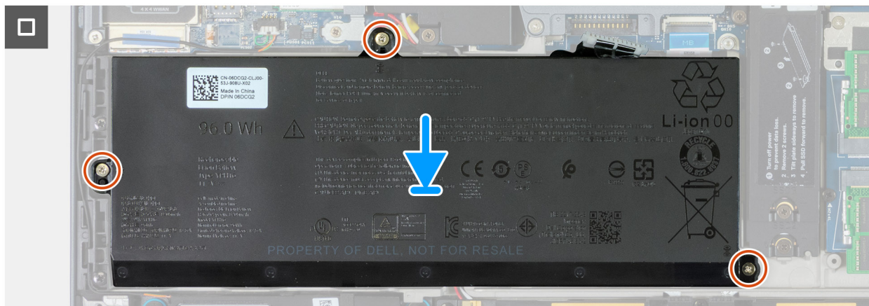
Figure 45. Remise en place de la batterie
