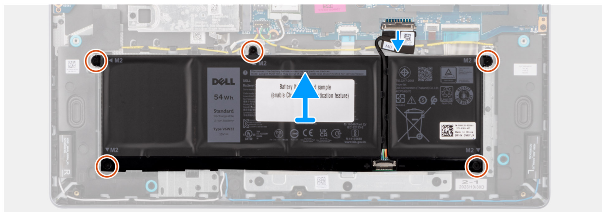
Ilustración 19. Extracción de la batería de 4 celdas
