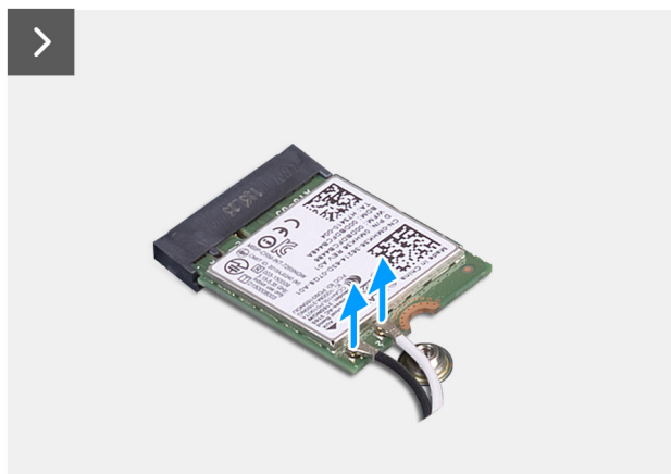
Ilustración 30. Extracción de la tarjeta inalámbrica
