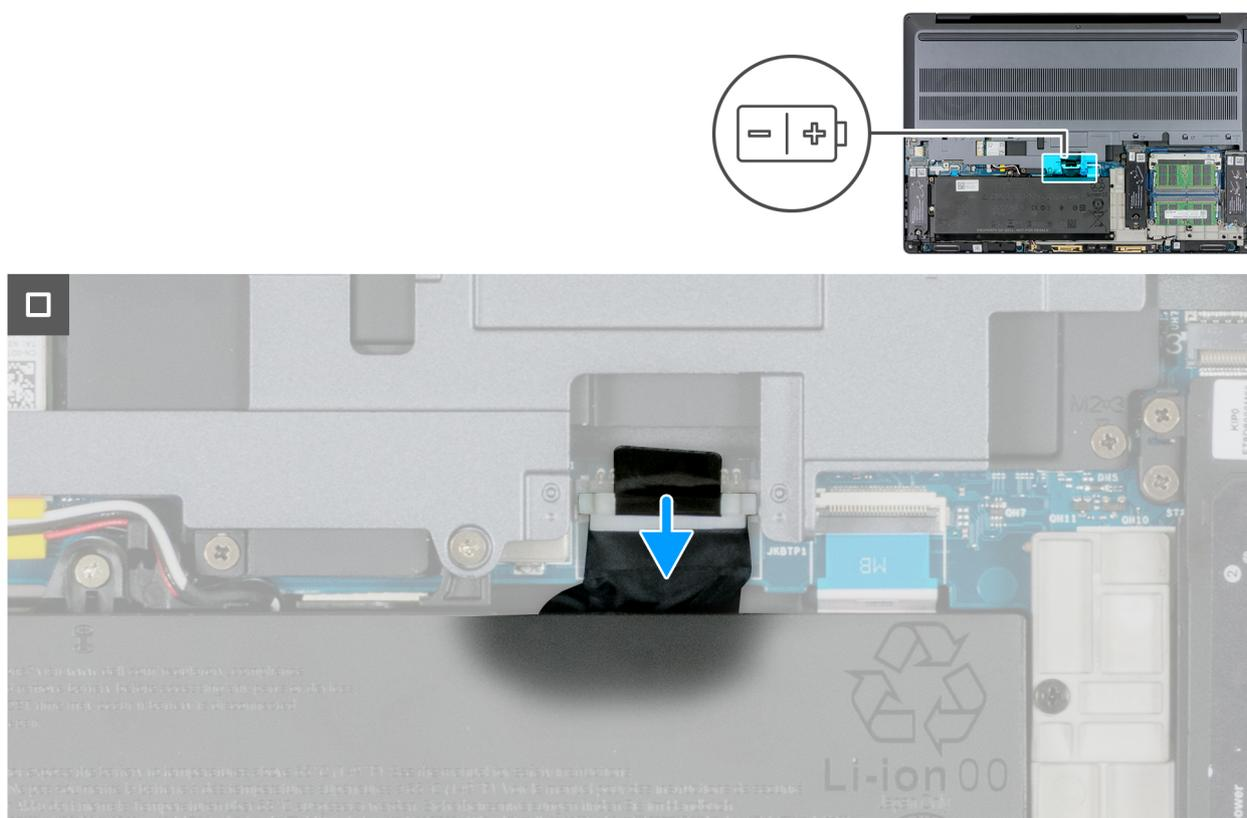
Figure 14. Déconnexion du câble de la batterie
