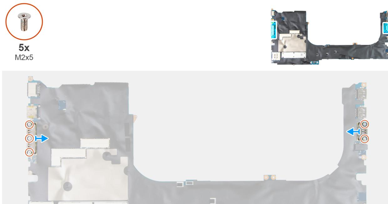
Figure 115. Retrait du module de connecteur USB-C
