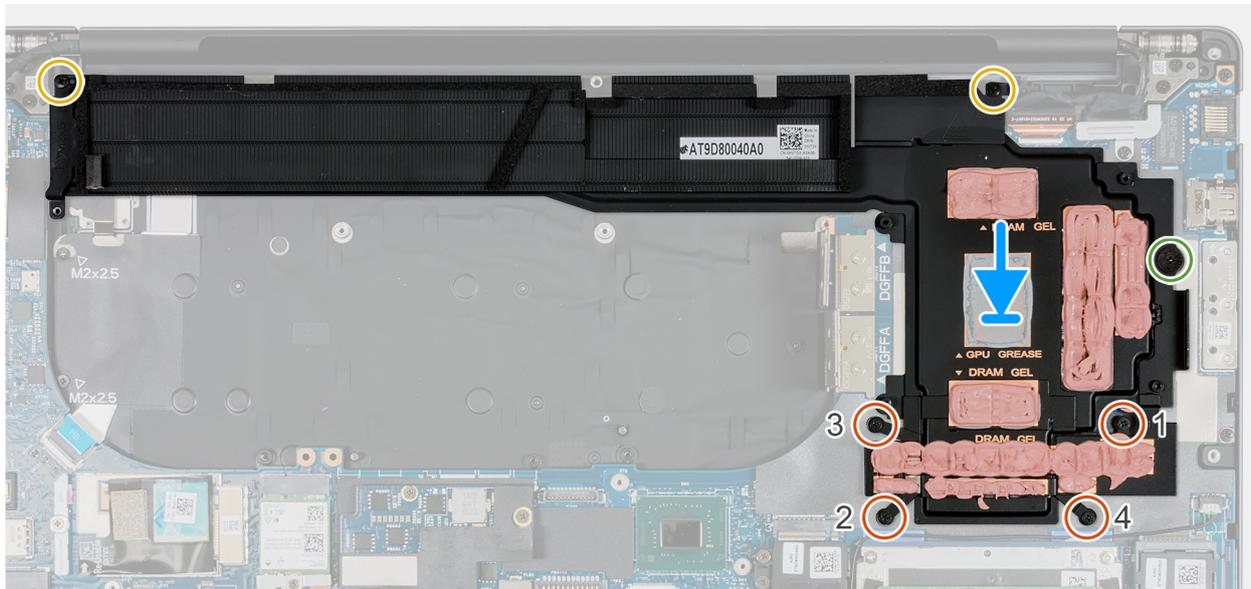
Figure 76. Installation du dissipateur de chaleur pour les ordinateurs expédiés avec une carte graphique séparée
