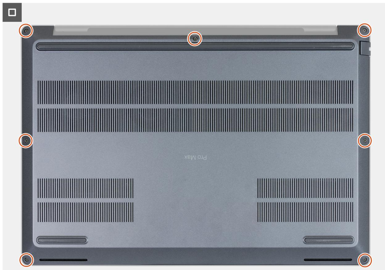
Figure 29. Serrage des vis imperdables
