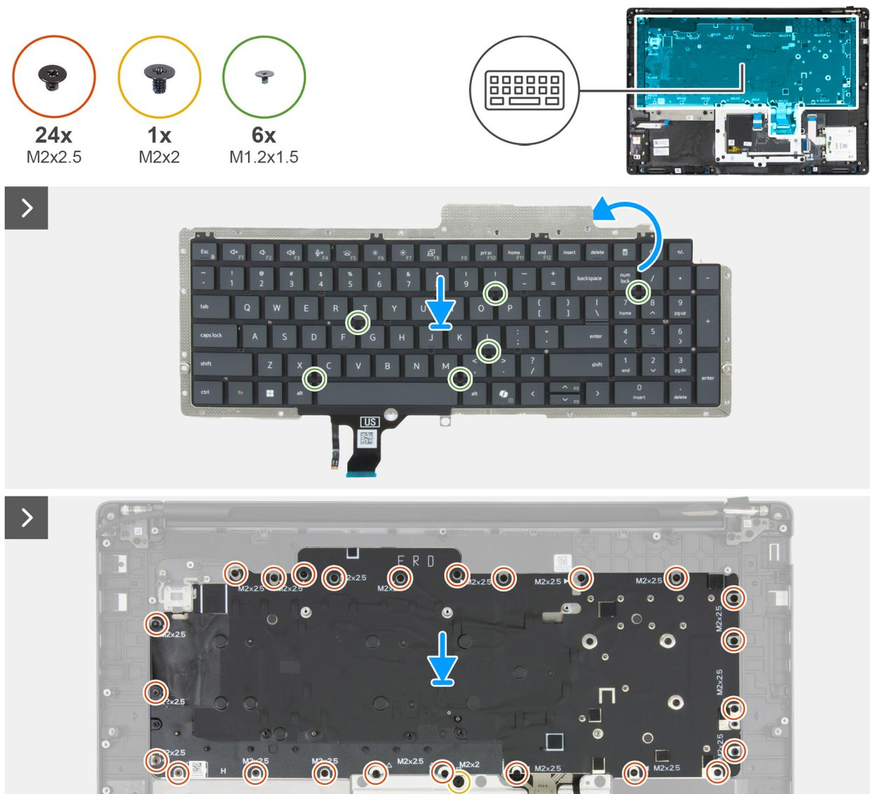
Figure 121. Installation du clavier
