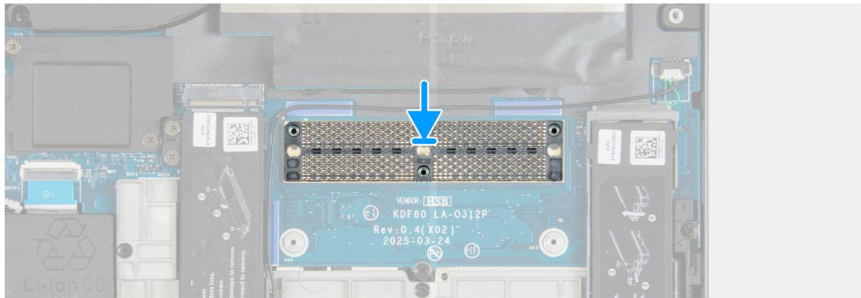
Figure 70. Installation du connecteur de mémoire
