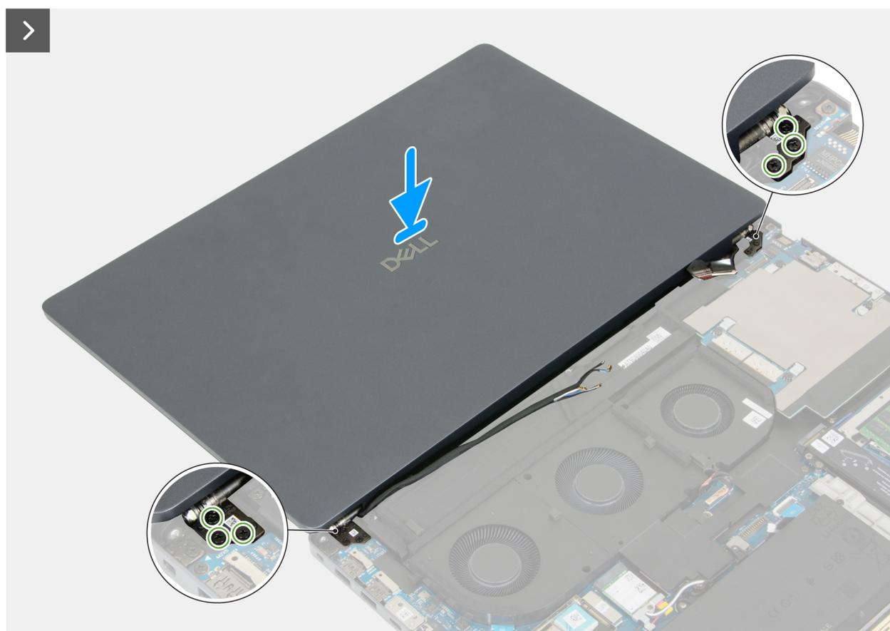
Figure 65. Installation de l'assemblage d'écran
