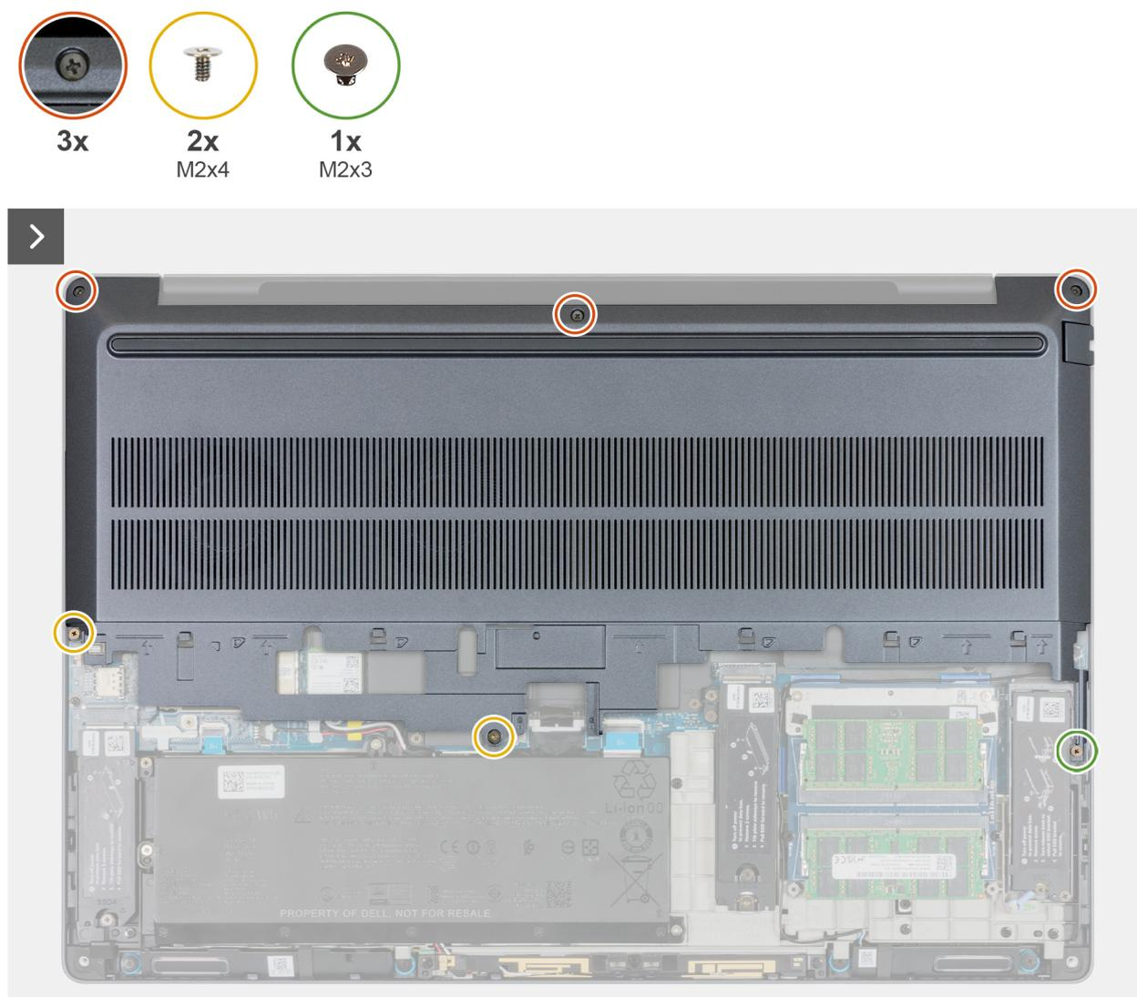
Figure 18. Desserrage des trois vis imperdables et retrait des trois vis
