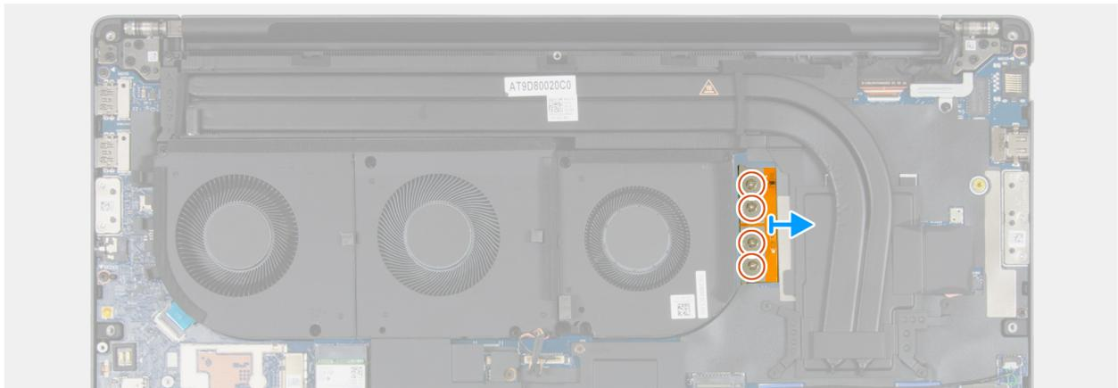
Figure 57. Retrait du connecteur de faisceau FPC intégré
