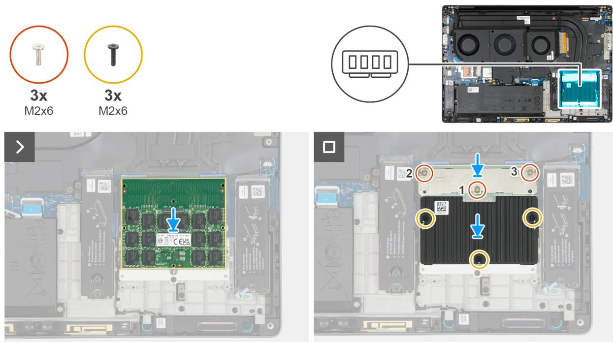
Figure 33. Installation du module CAMM (bicanal)
