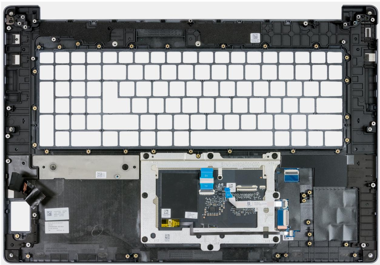
Figure 132. Assemblage du repose-poignets
