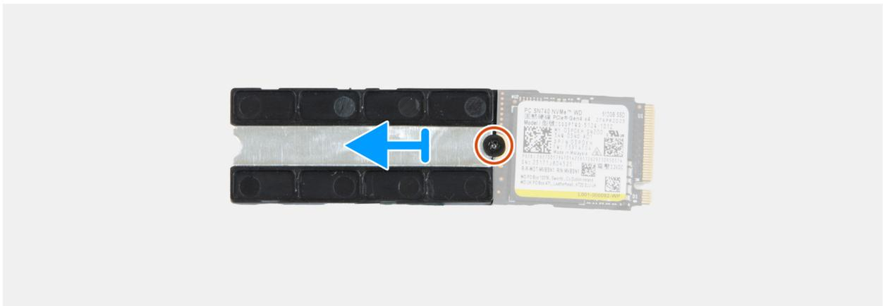
Figure 42. Retrait du disque SSD M.2 2230
