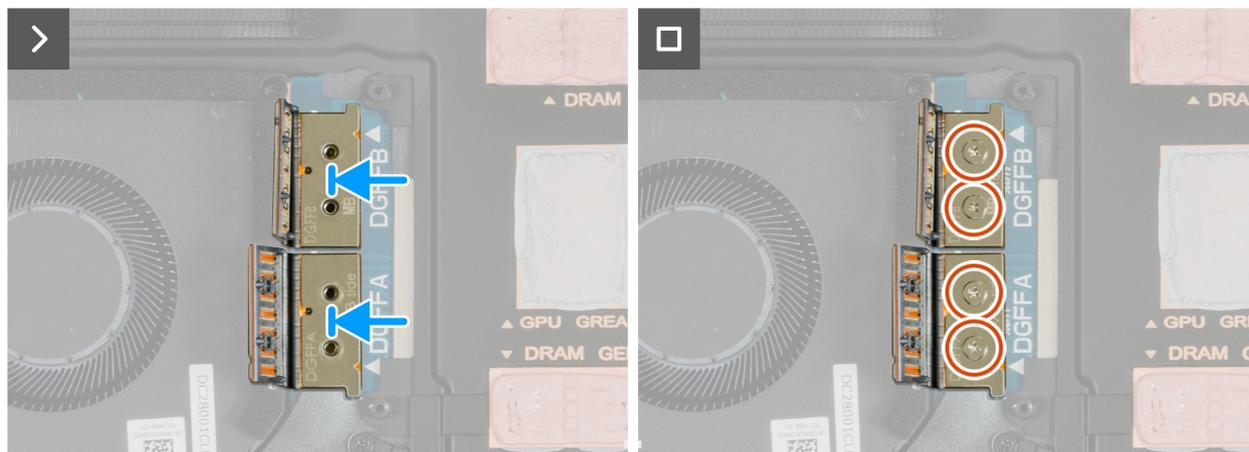
Figure 60. Installation du connecteur de faisceau FPC séparé
