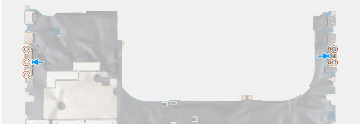
**Figure 116. Installation du module de connecteur USB-C**
