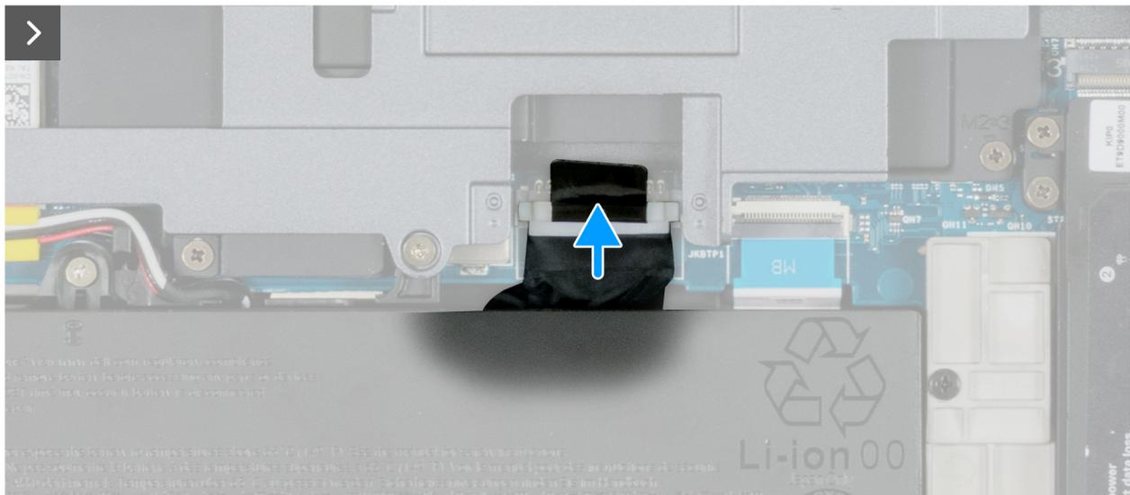
Figure 15. Connexion du câble de la batterie
