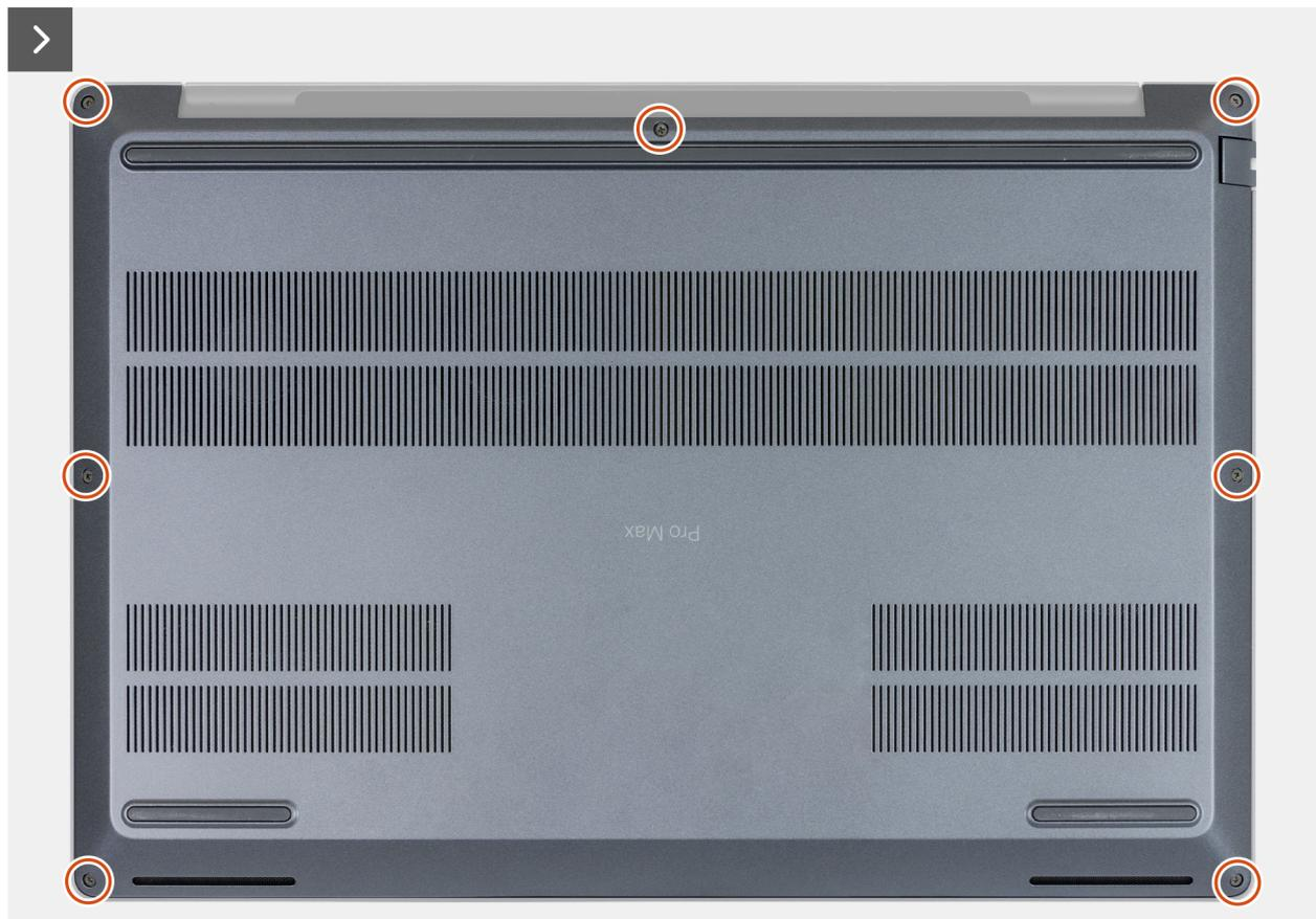
Figure 24. Desserrage des vis imperdables
