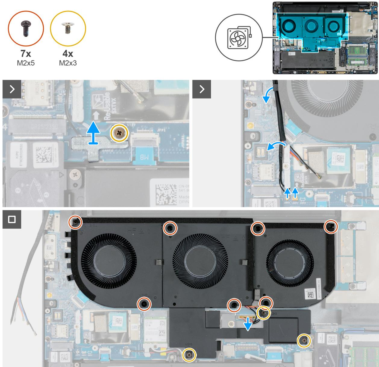
Figure 61. Retrait de l'assemblage du ventilateur
