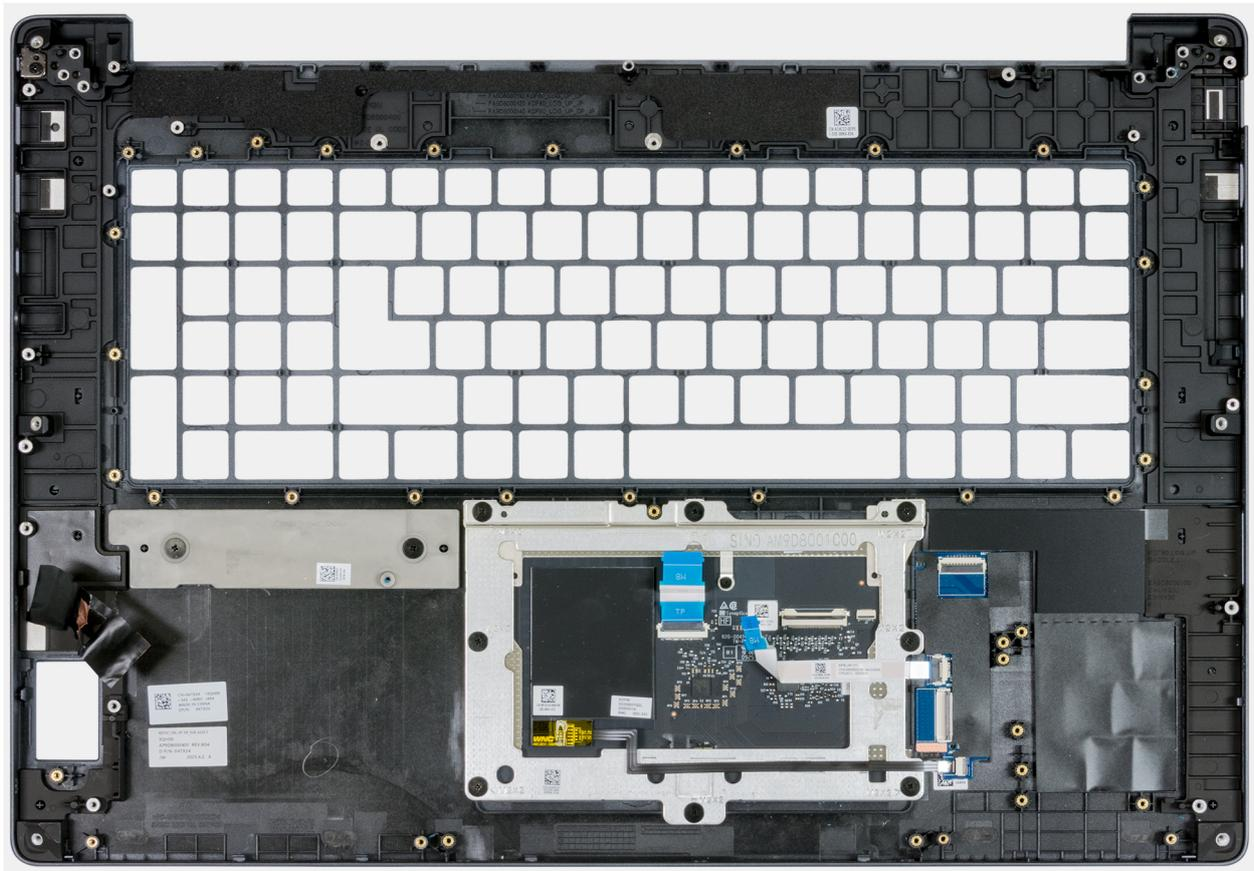
Figure 131. Assemblage du repose-poignets
