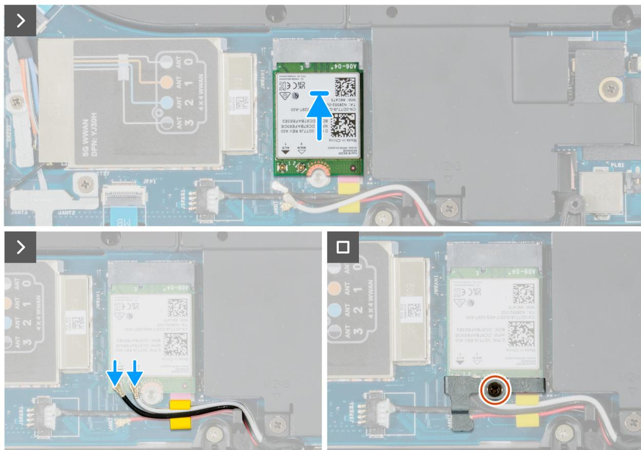
Figure 49. Installation de la carte WLAN
