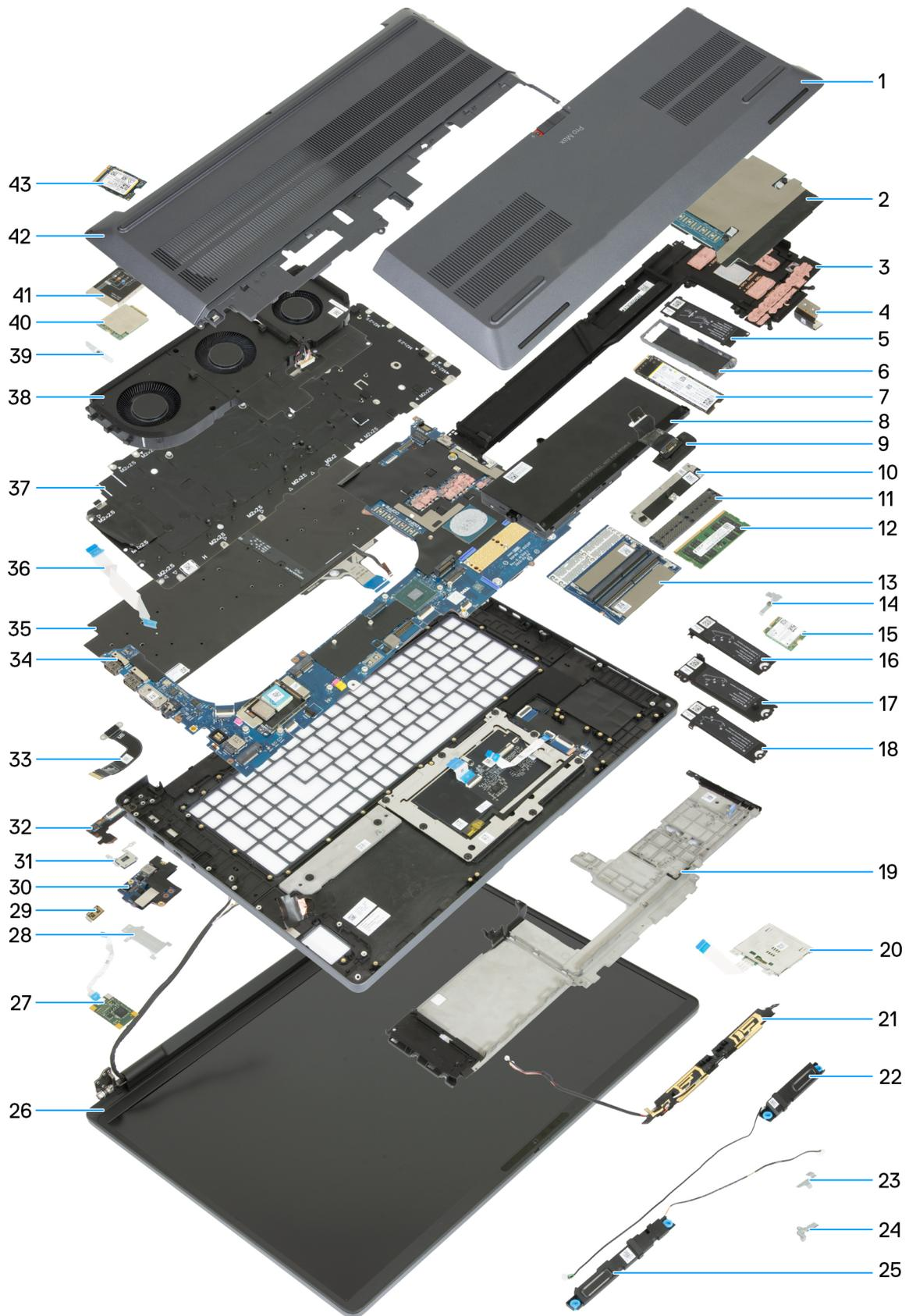
**Figure 9. Principaux composants de l'ordinateur Dell Pro Max 18 Plus MB18250**
