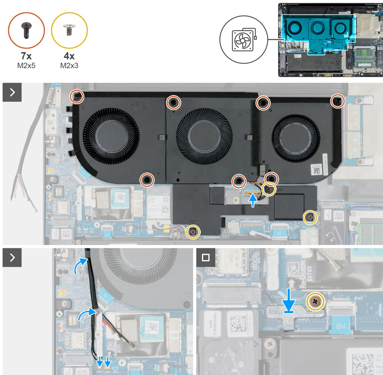
**Figure 62. Installation de l'assemblage du ventilateur**
