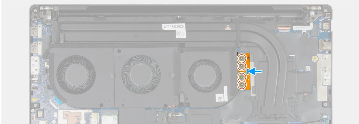
Figure 58. Installation du connecteur de faisceau FPC intégré
