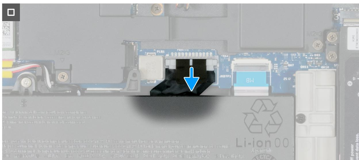
Figure 26. Déconnexion du câble de la batterie
