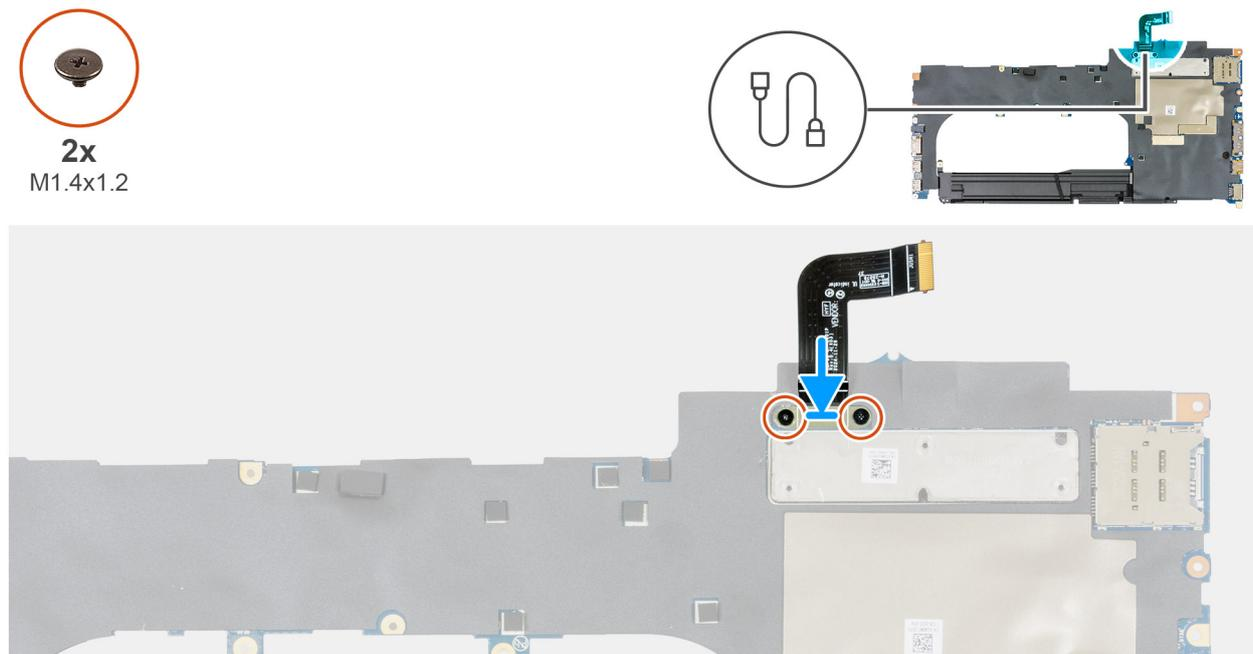
**Figure 118. Installation du câble de la carte USH**
