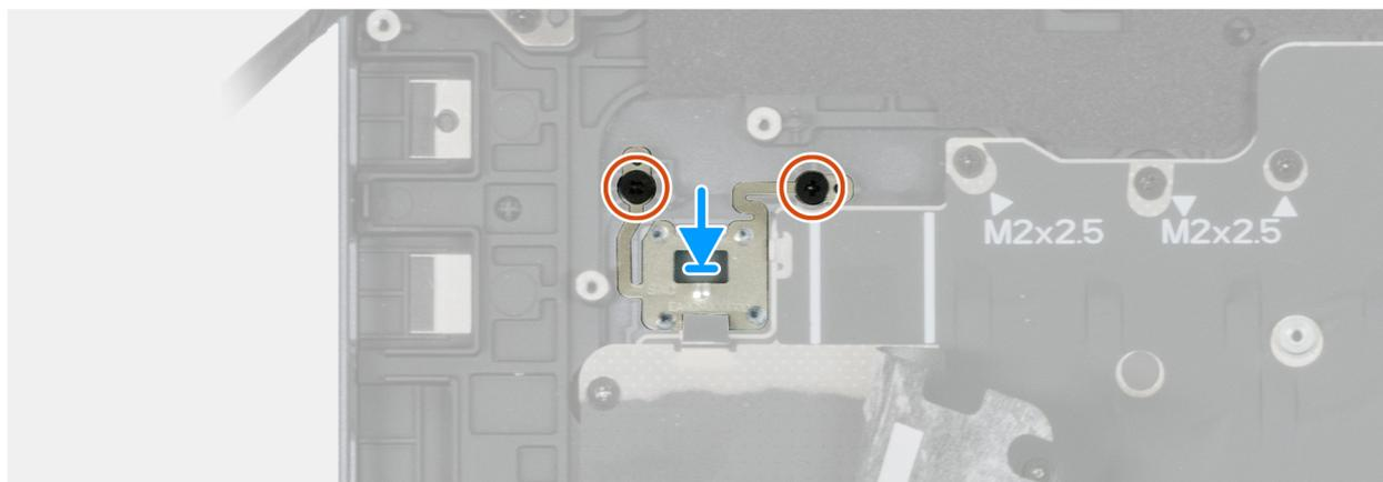
Figure 130. Installation du bouton d'alimentation
