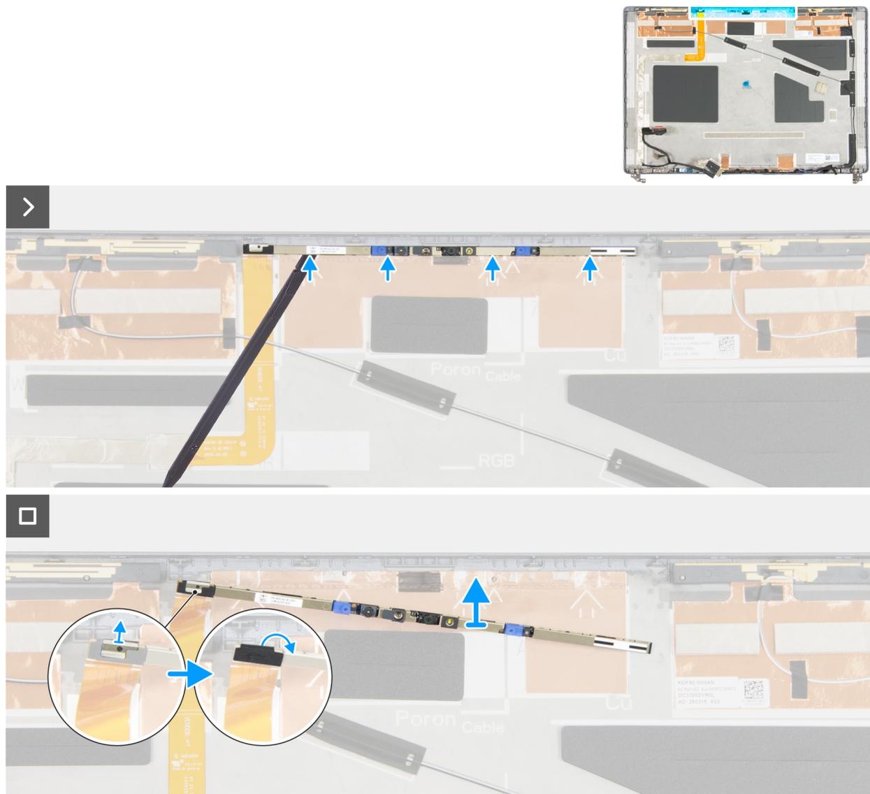
**Figure 103. Retrait du module de caméra**
