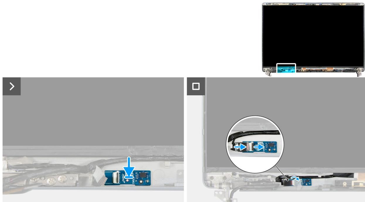
Figure 102. Installation de la carte des capteurs
