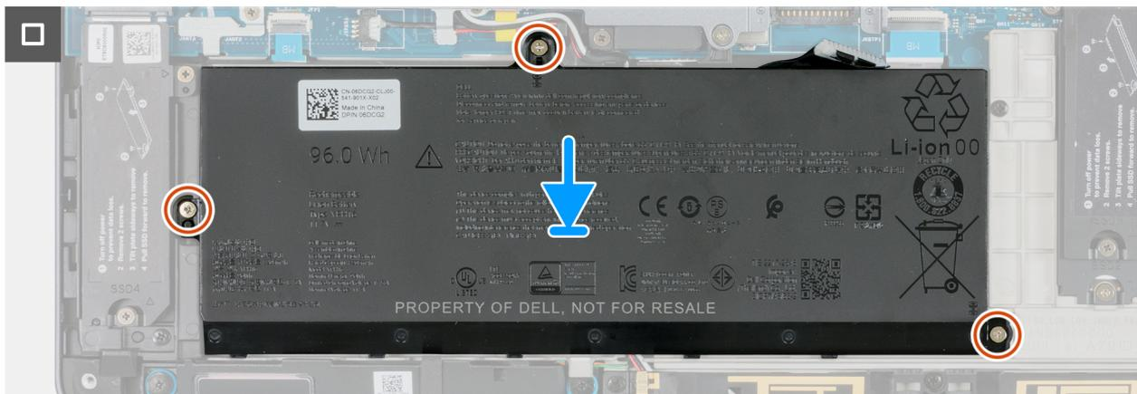
Figure 47. Remise en place de la batterie
