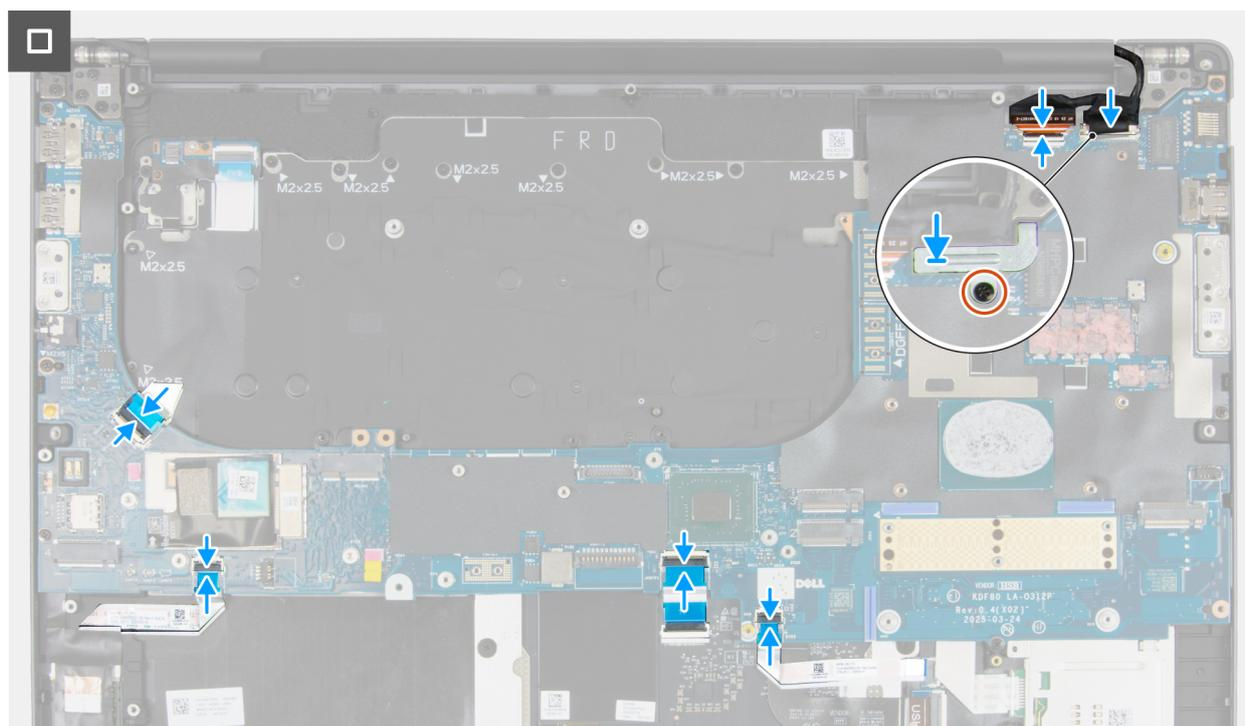
**Figure 114. Installation de la carte système**
