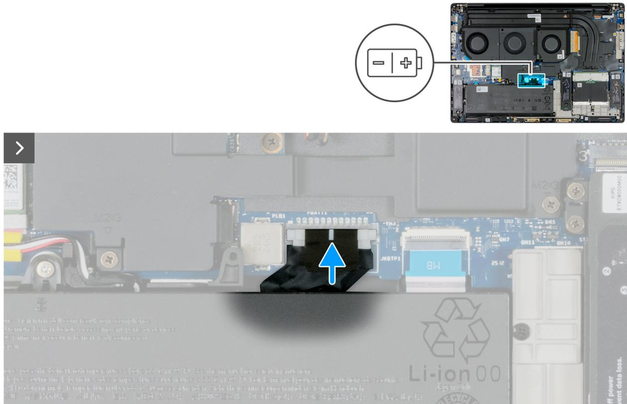
Figure 27. Connexion du câble de la batterie
