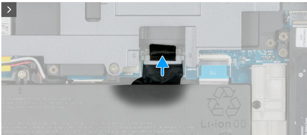
Figure 21. Connexion du câble de la batterie
