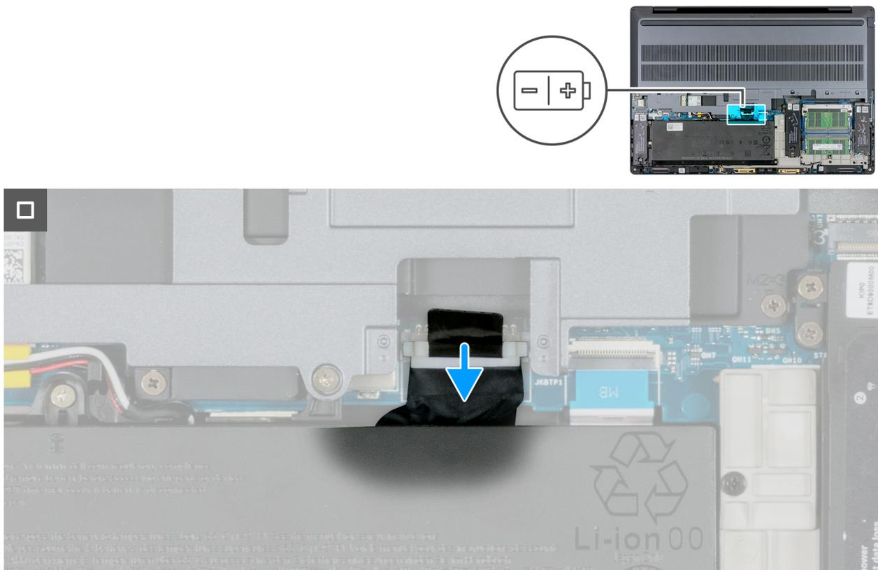
Figure 20. Déconnexion du câble de la batterie
