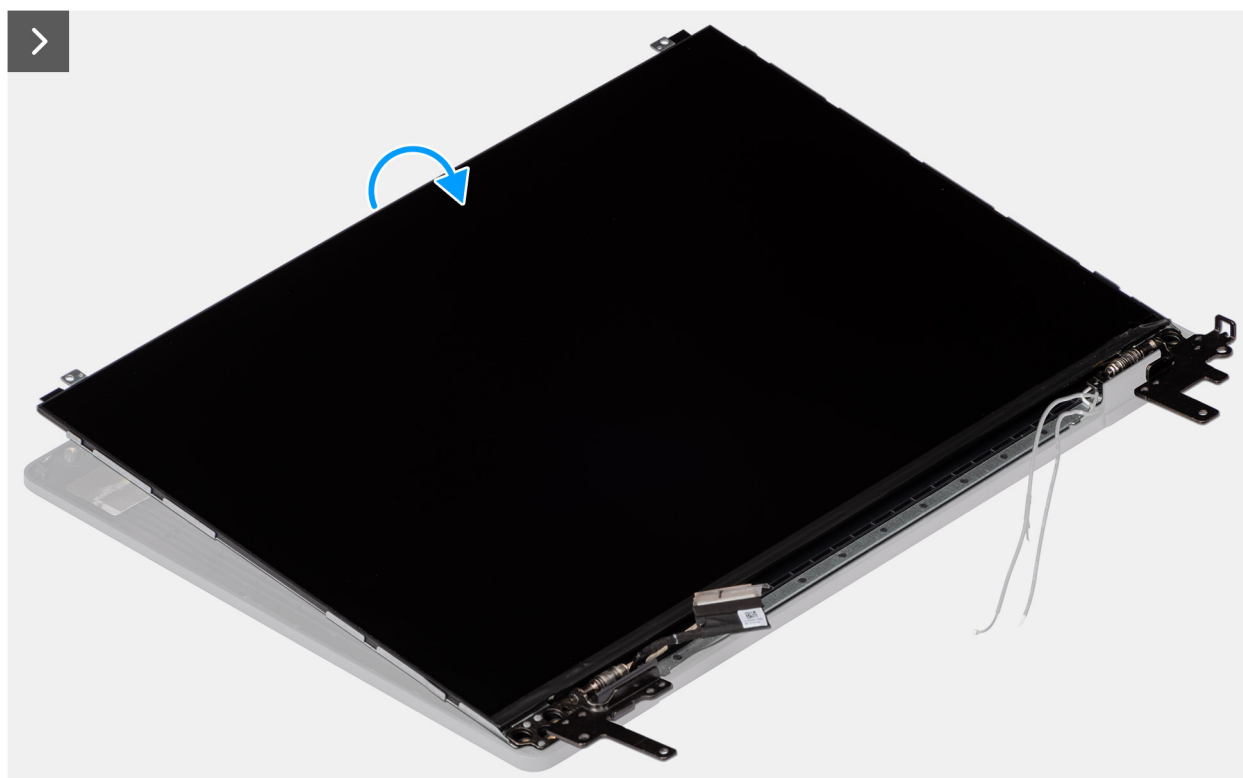
Figura 106. Rimozione del gruppo del pannello del display
