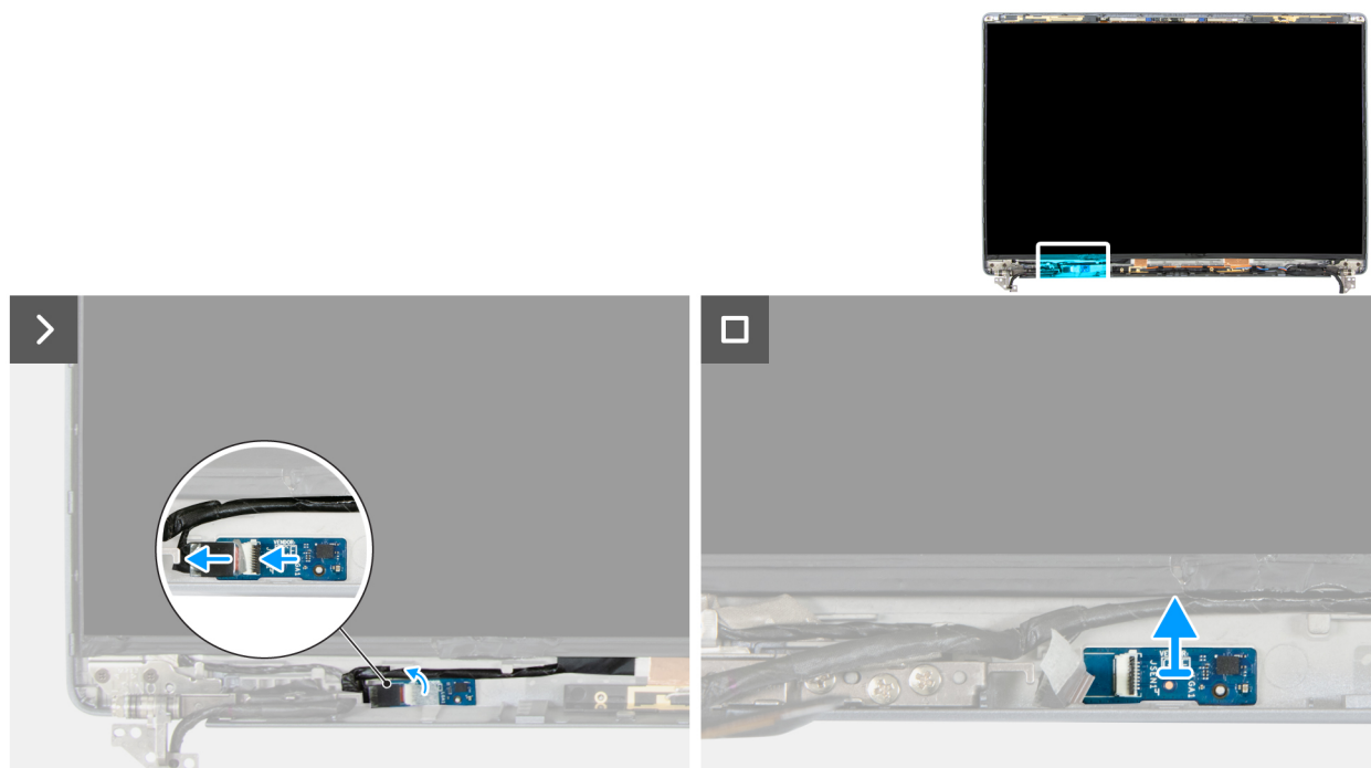
Obrázek 101. Demontáž desky snímače
