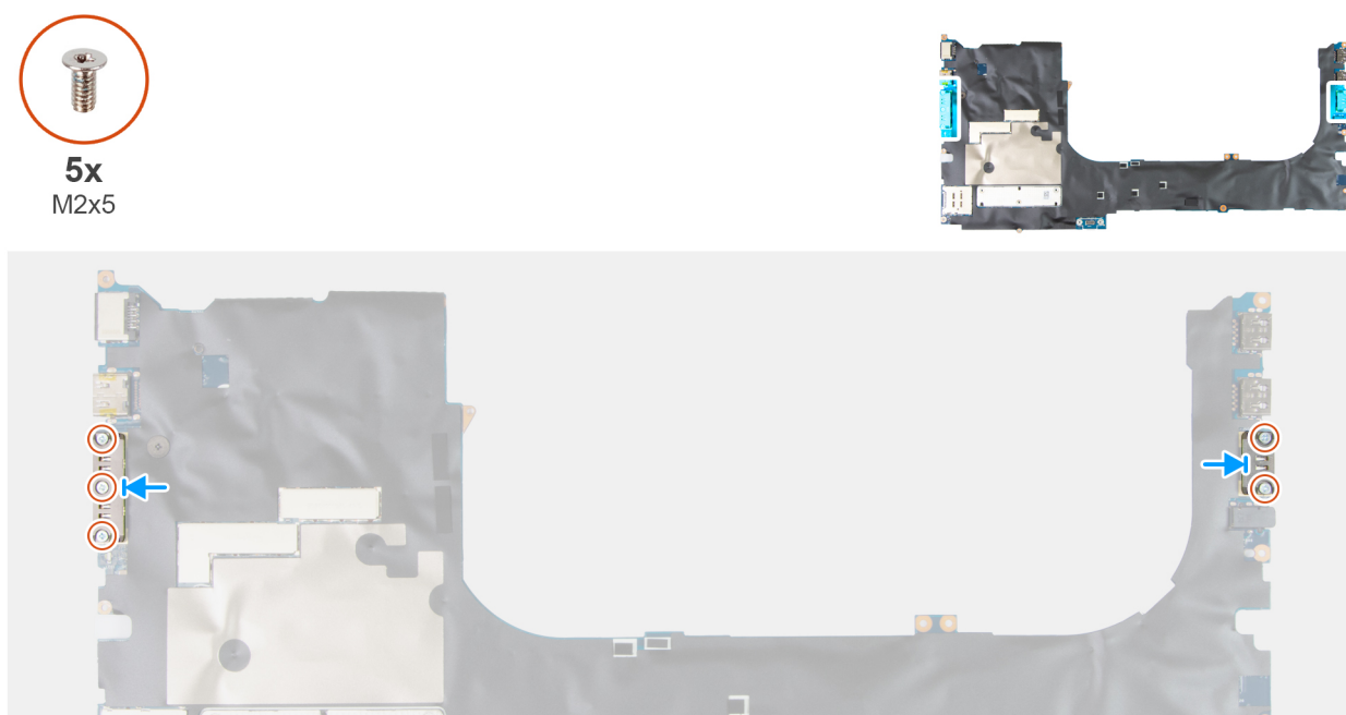
Obrázek 116. Montáž modulu konektoru USB Type-C
