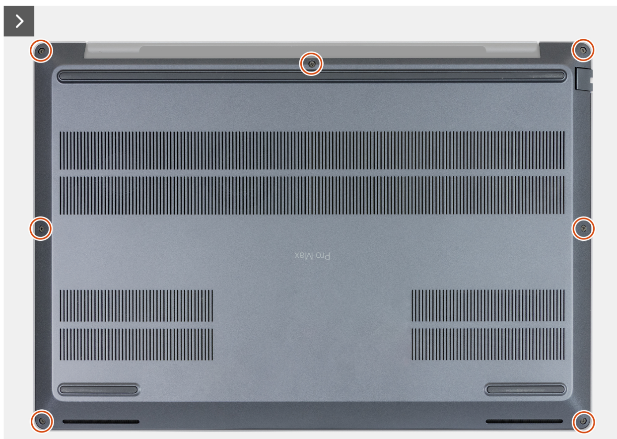
Obrázek 24. Uvolnění jisticích šroubů
