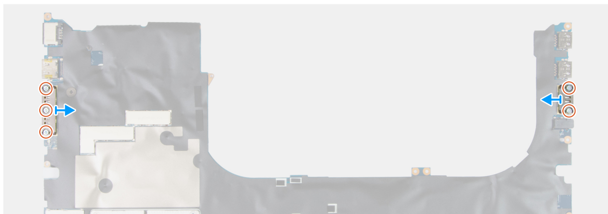
Obrázek 115. Demontáž modulu konektoru USB Type-C
