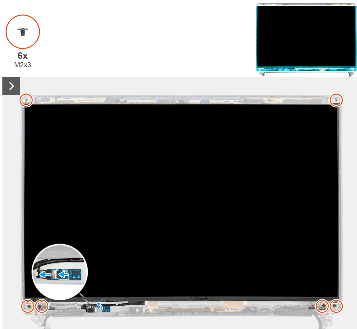
Obrázek 95. Demontáž obrazovky displeje
