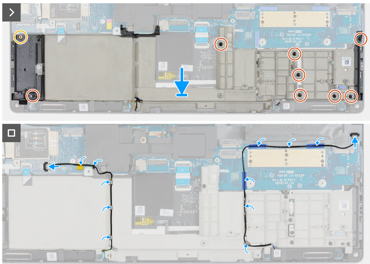
Obrázek 80. Montáž vnitřního rámu
