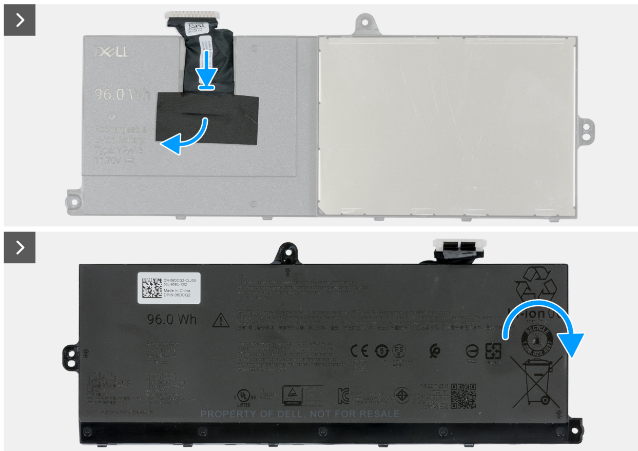
Obrázek 46. Výměna kabelu baterie
