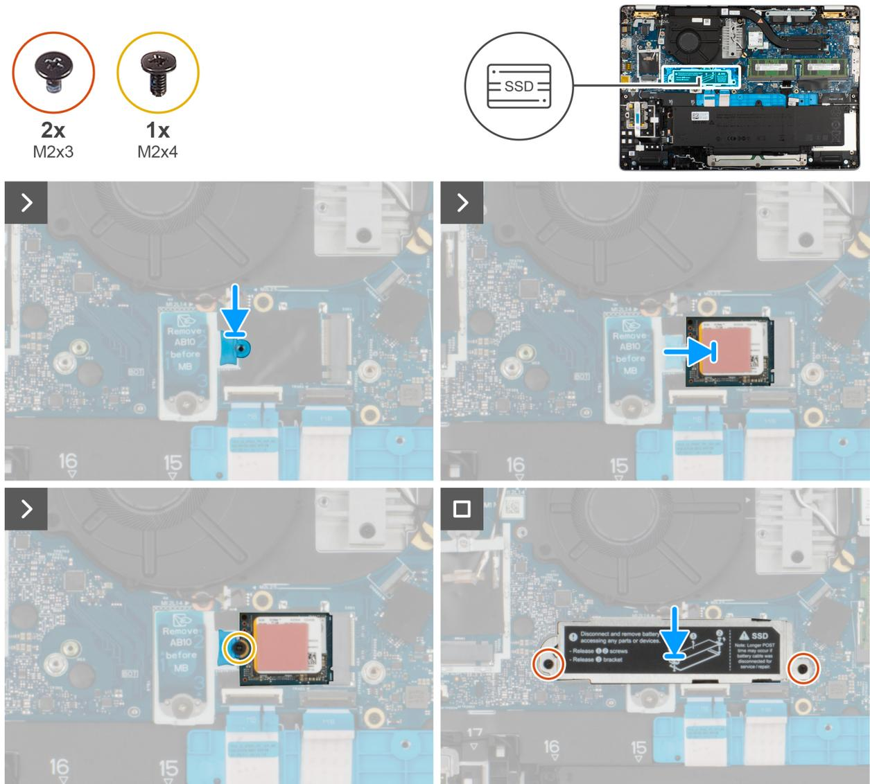
**Figura 25. Installazione dell'SSD M.2 2230**
