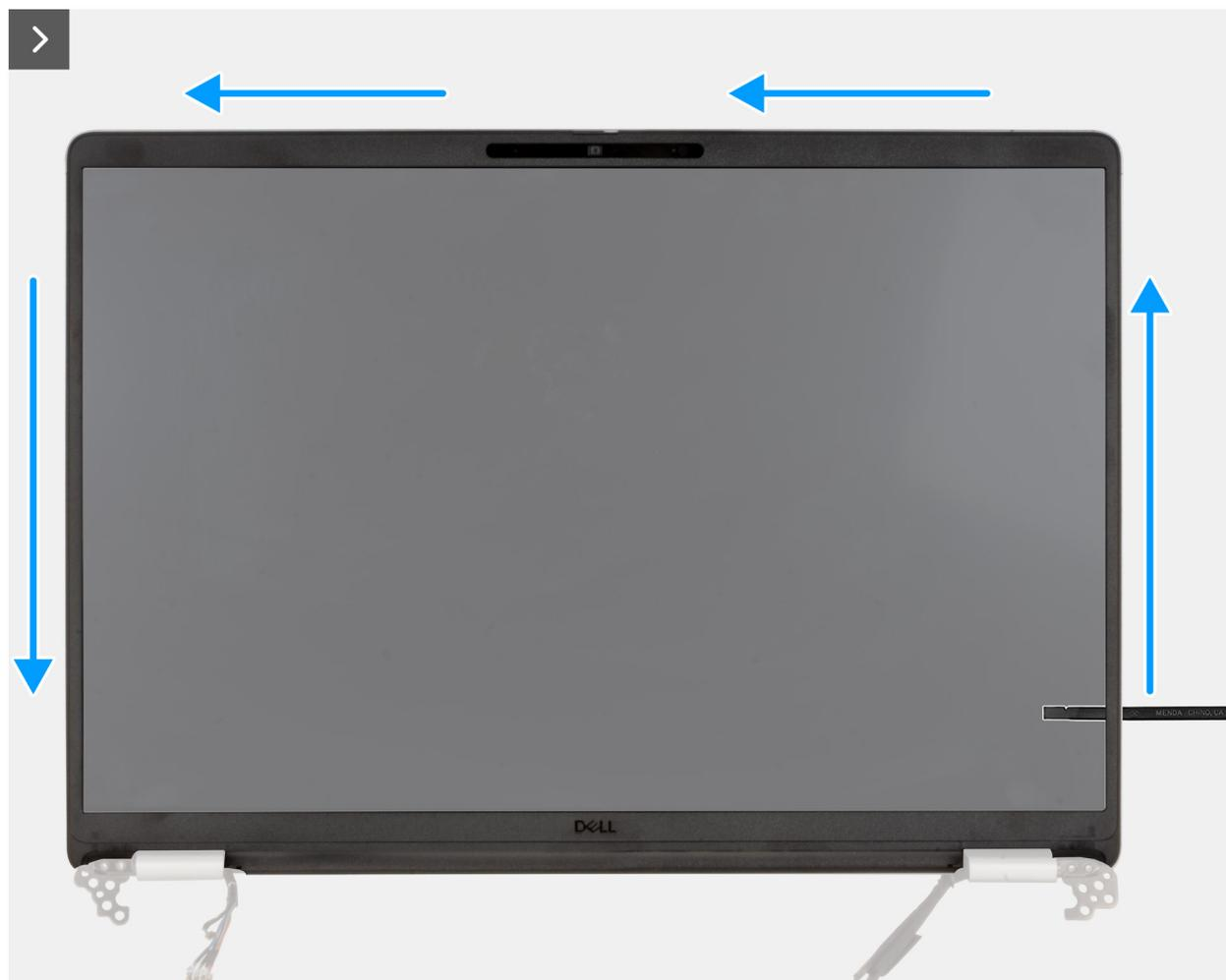
Figura 67. Rimozione della cornice del display
