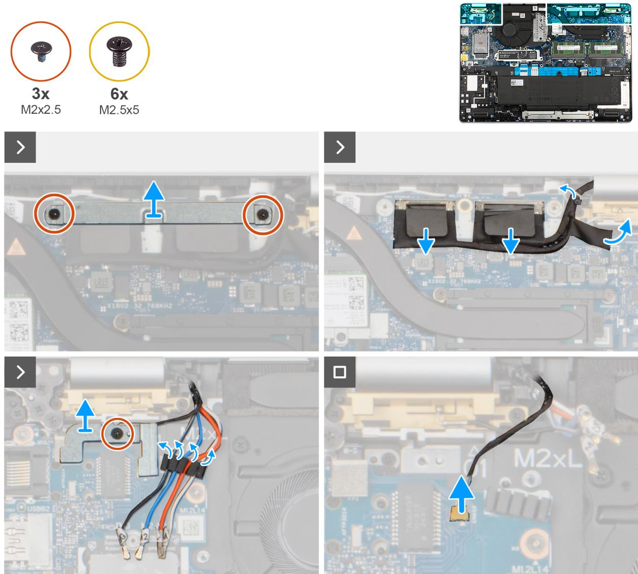
Figura 61. Rimozione del gruppo del display
