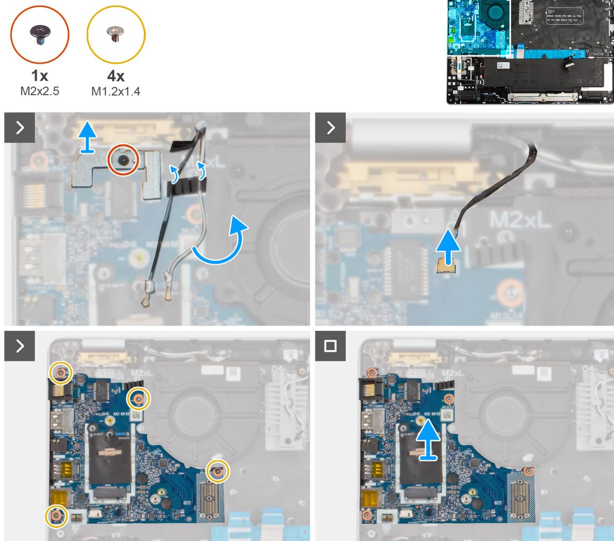
**Figura 57. Rimozione della scheda di I/O**
