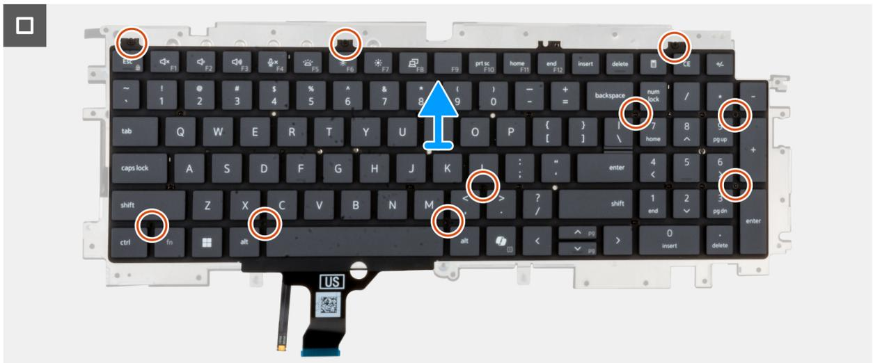
Figura 85. Rimozione della tastiera
