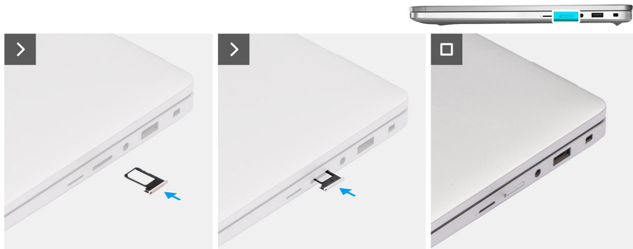
**Figura 12. Installazione del vassoio per scheda SIM**
