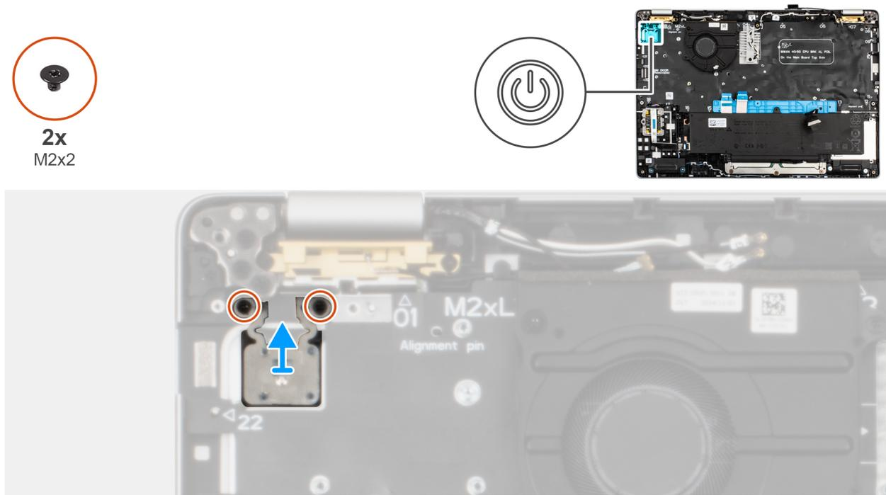
**Figura 59. Installazione del pulsante di accensione con lettore di impronte digitali opzionale**
