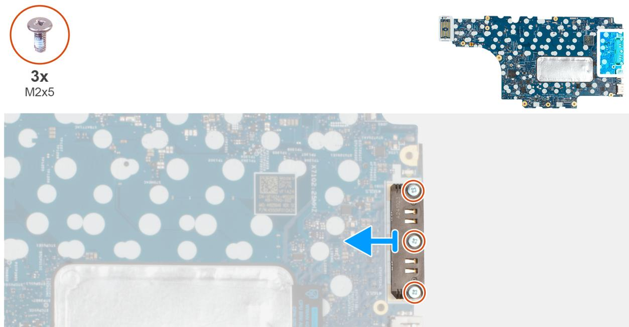
Figura 82. Rimozione del modulo del connettore USB Type-C
