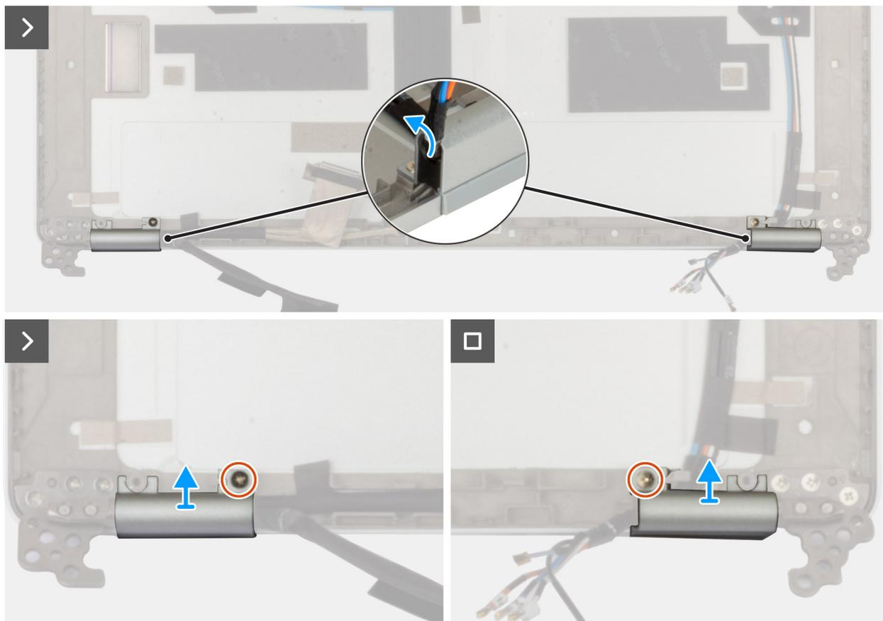
Figura 74. Rimozione del tappo dei cardini del display
