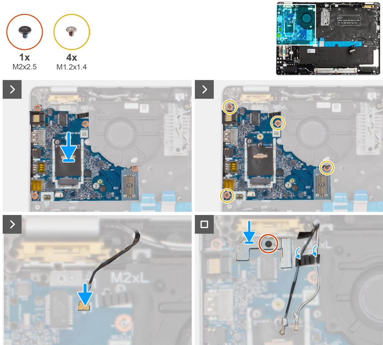
Figura 58. Rimozione della scheda di I/O
