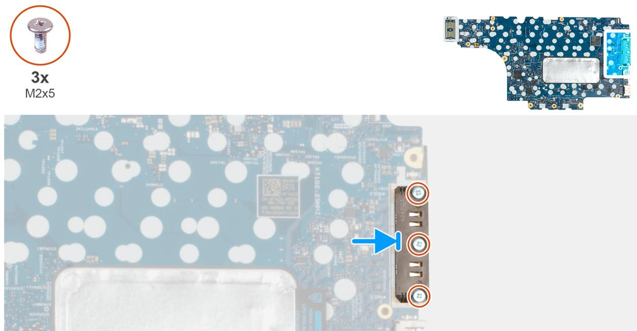
**Figura 83. Installazione del modulo del connettore USB Type-C**
