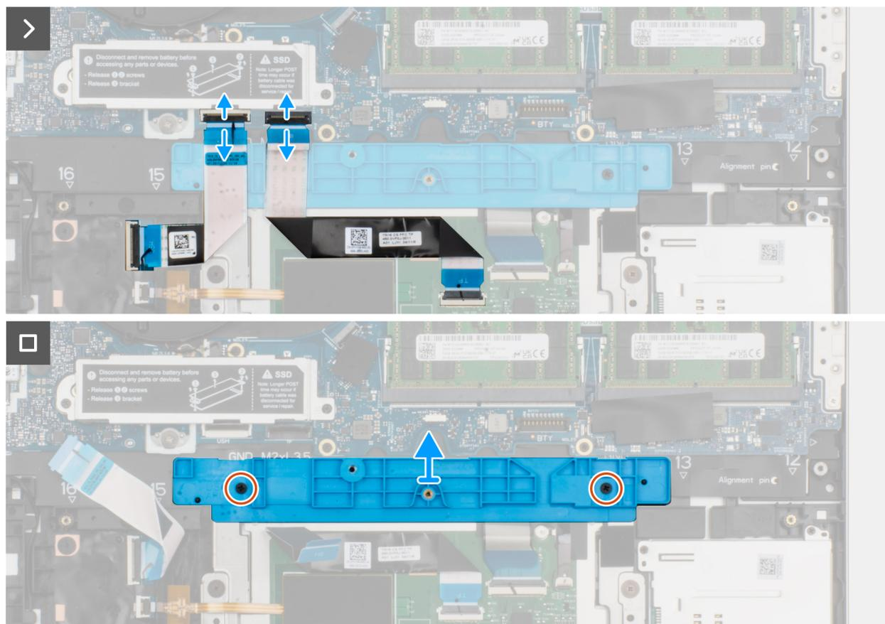
Figura 47. Rimozione della staffa di supporto della batteria
