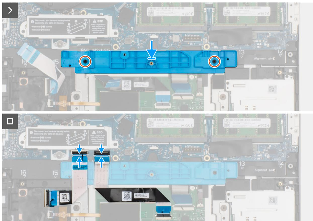
Figura 48. Installazione della staffa di supporto della batteria
