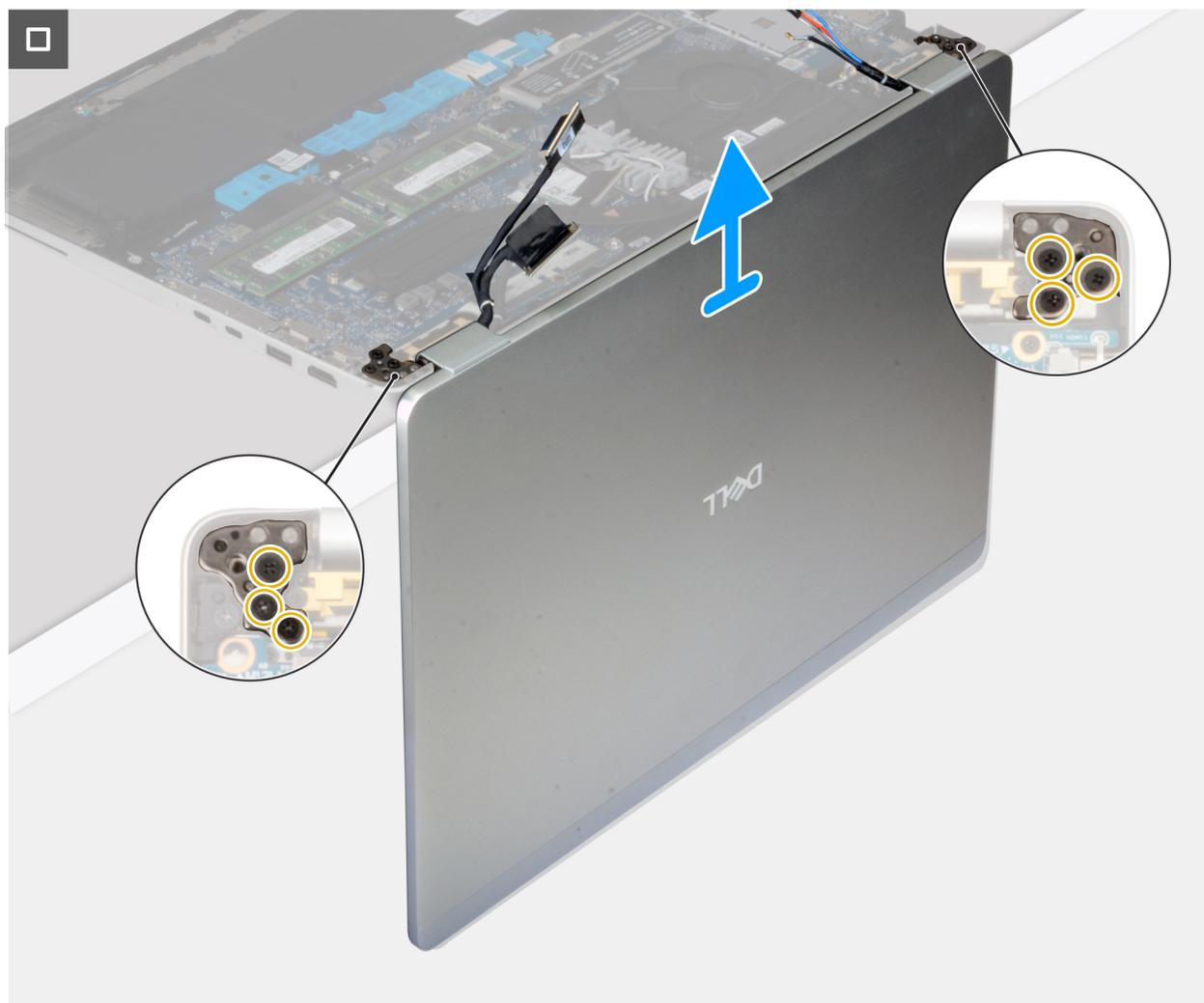
**Figura 62. Rimozione del gruppo del display**
