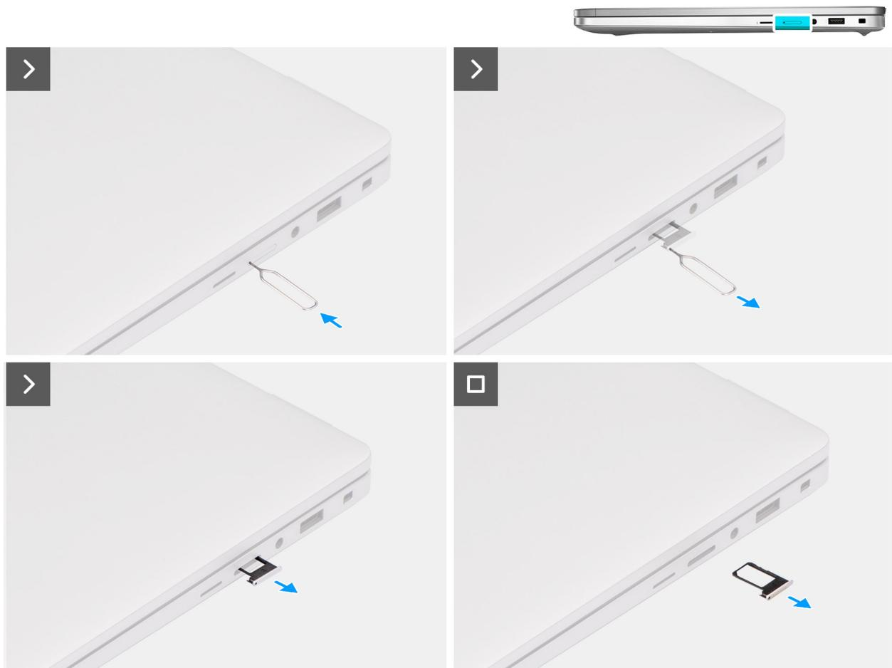
**Figura 11. Rimozione del vassoio della scheda SIM**
