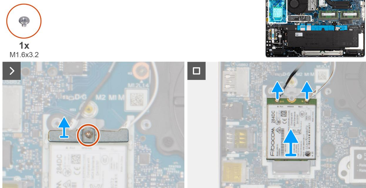
**Figura 33. Rimozione della scheda WWAN 4G**
