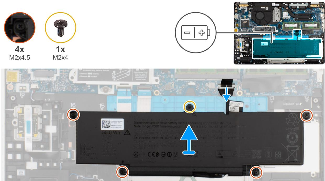
Figura 18. Rimozione della batteria
