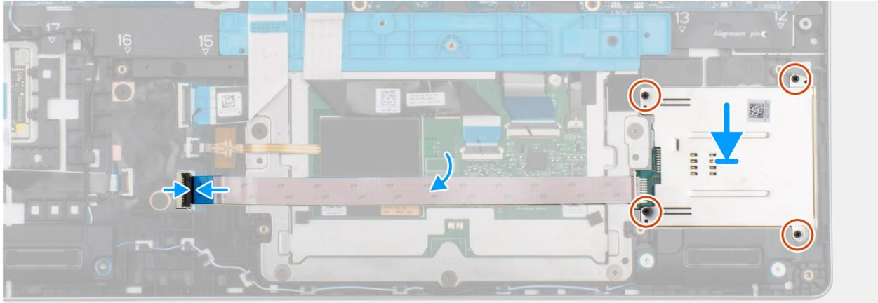
Figura 51. Installazione del lettore di smart card
