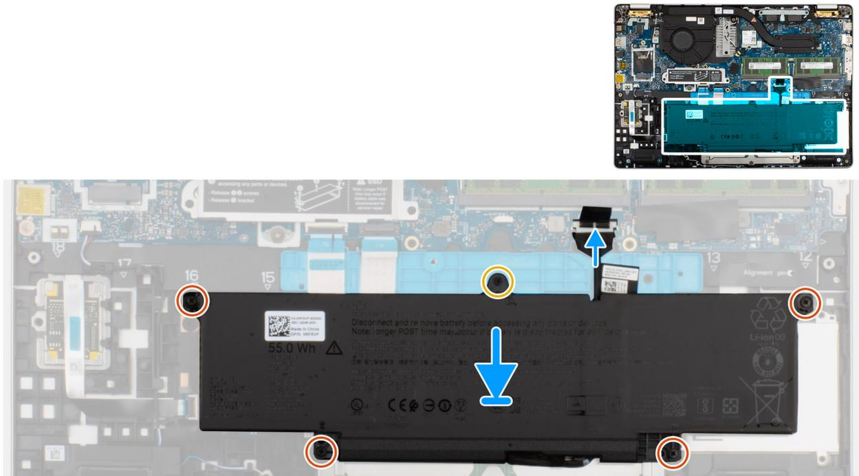
Figura 16. Collegamento del cavo della batteria
