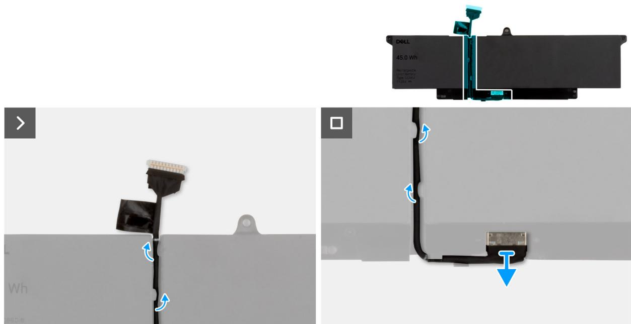
**Figura 20. Rimozione del cavo della batteria**
