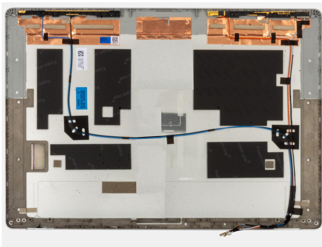
Figura 80. Rimozione del coperchio posteriore del display
