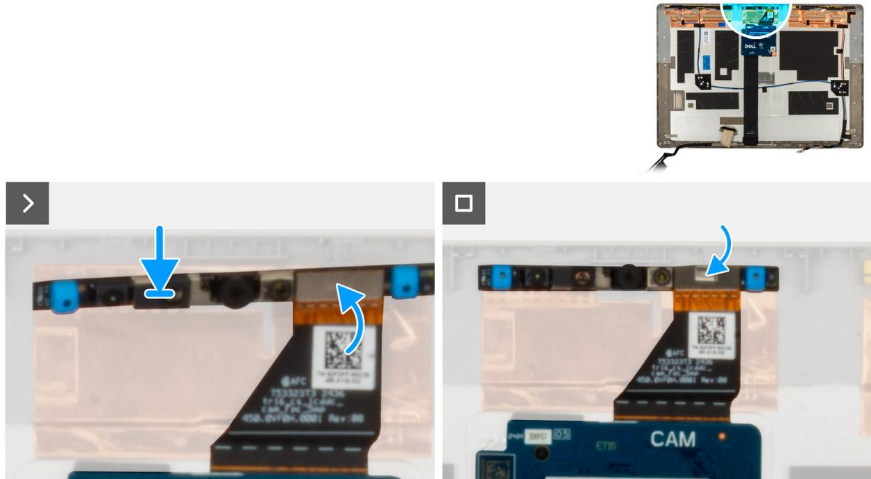
Figura 79. Installazione del modulo della fotocamera
