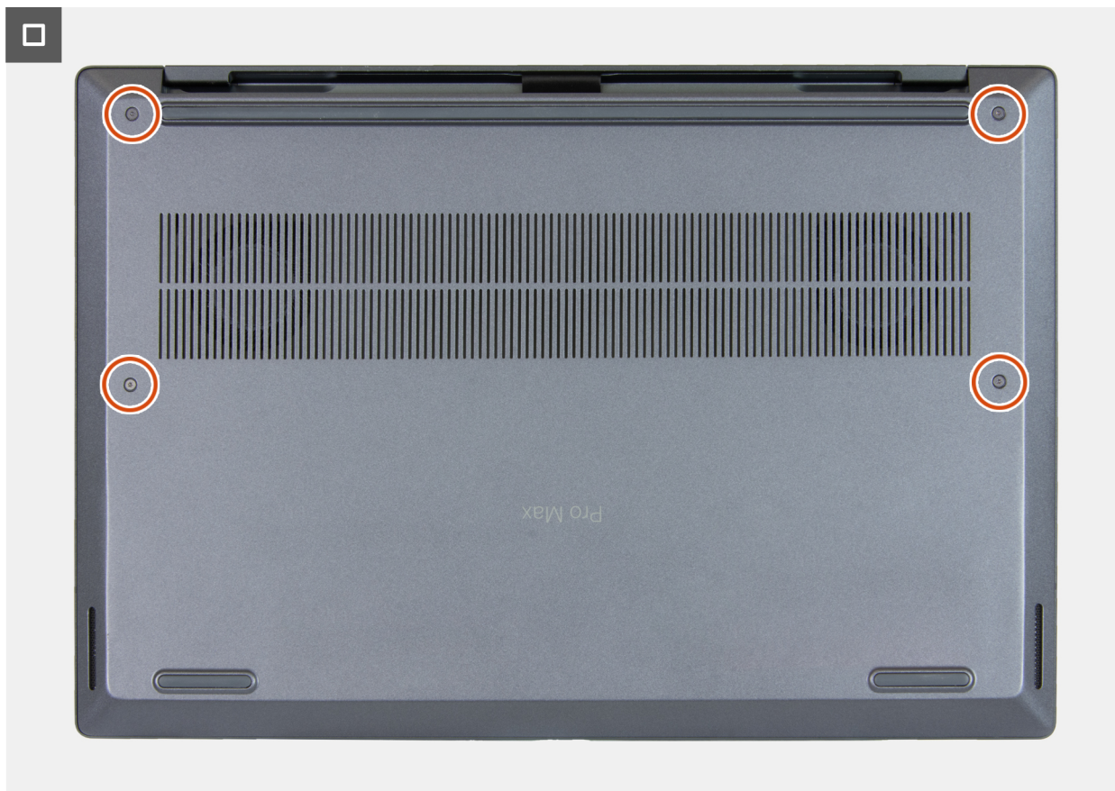
Afbeelding 15. De onderplaat plaatsen
