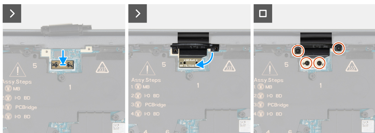
Figure 39. Installation de l'assemblage d'écran
