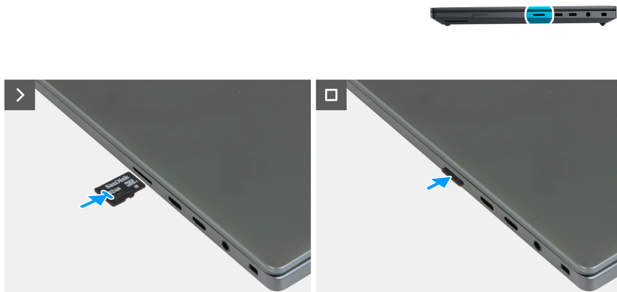
Figure 11. Installation de la carte mémoire
