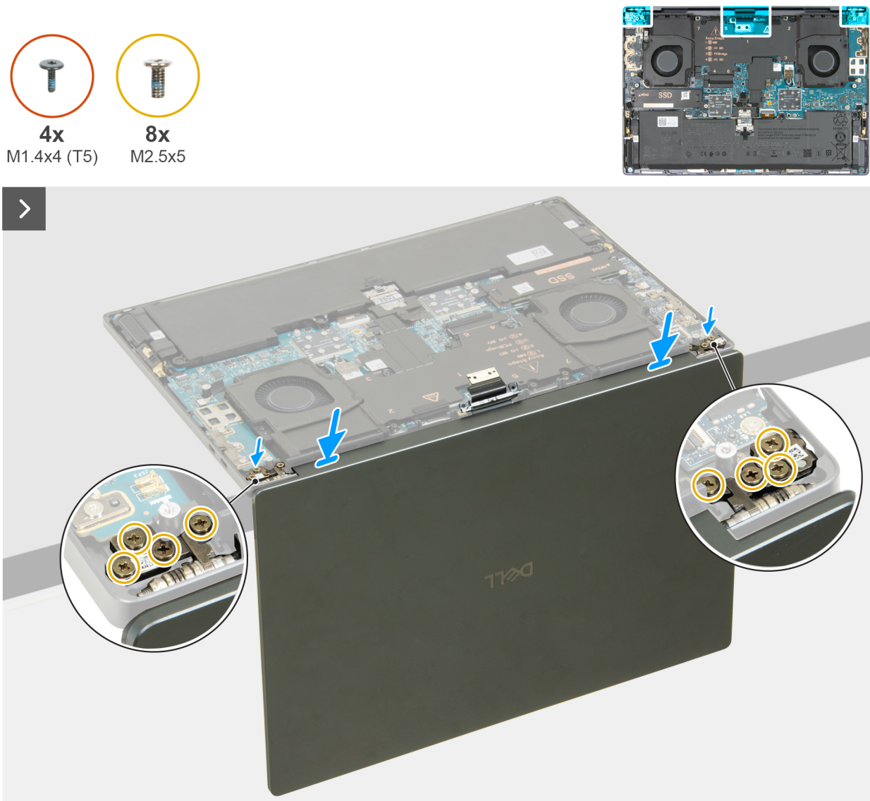
Figure 38. Installation de l'assemblage d'écran
