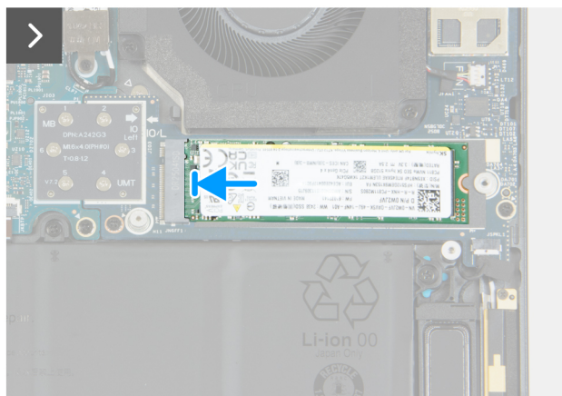
Afbeelding 24. De M.2 2280 SSD (SSD1) installeren
