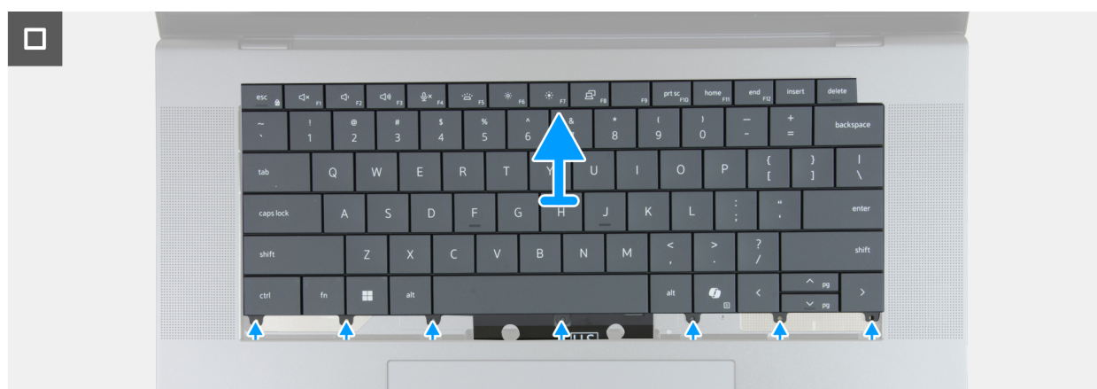
Afbeelding 77. Het toetsenbord verwijderen
