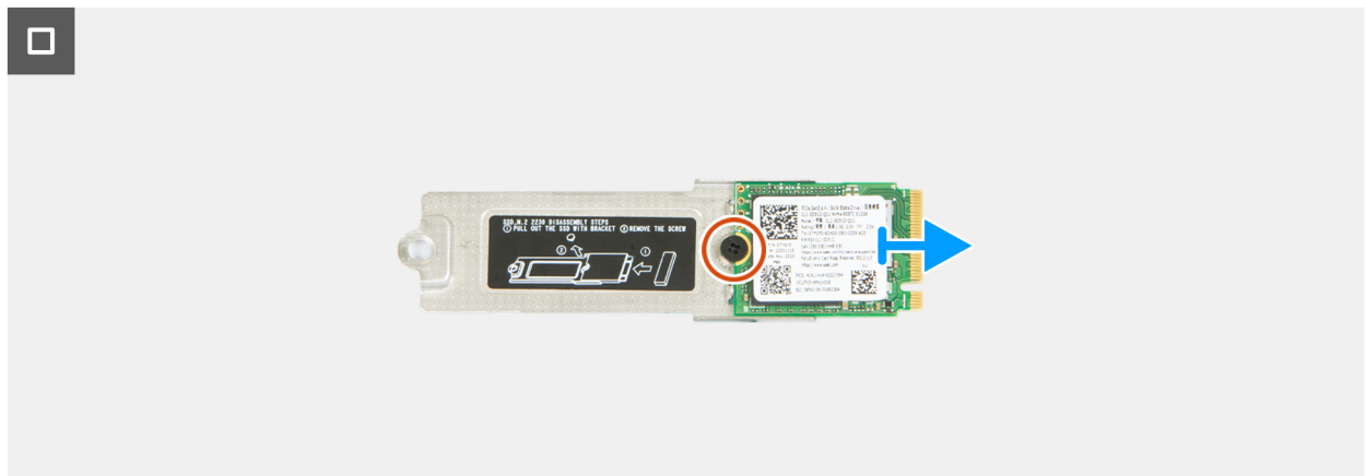
Afbeelding 26. De M.2 2230 SSD (SSD1) verwijderen
