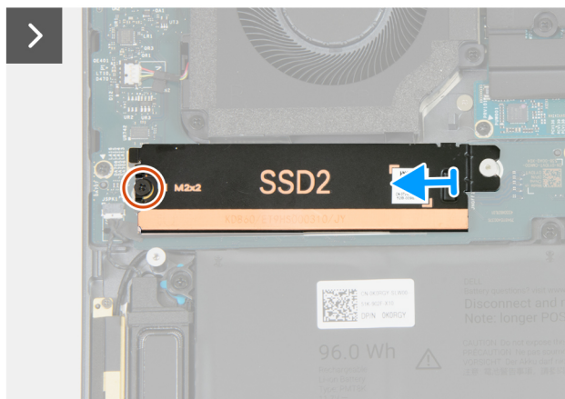
Afbeelding 23. De M.2 2280 SSD (SSD2) verwijderen
