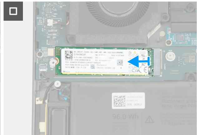
Abbildung 23. Entfernen des M.2 2280-Solid-State-Laufwerks (SSD2)
