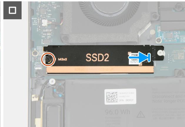
**Abbildung 29. Einbauen des M.2 2230-Solid-State-Laufwerks (SSD2)**
