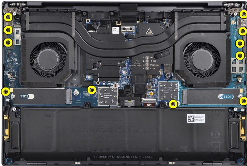
**Abbildung 70. Schrauben der I/O-Platinen**
