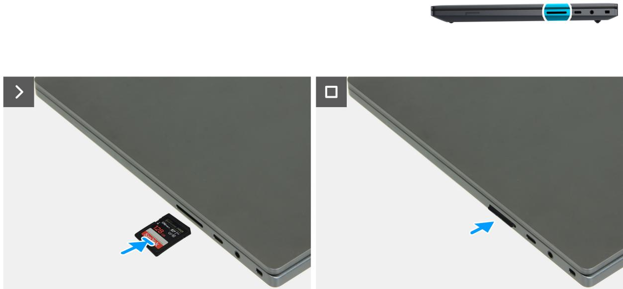
Abbildung 12. Einsetzen der Speicherkarte
