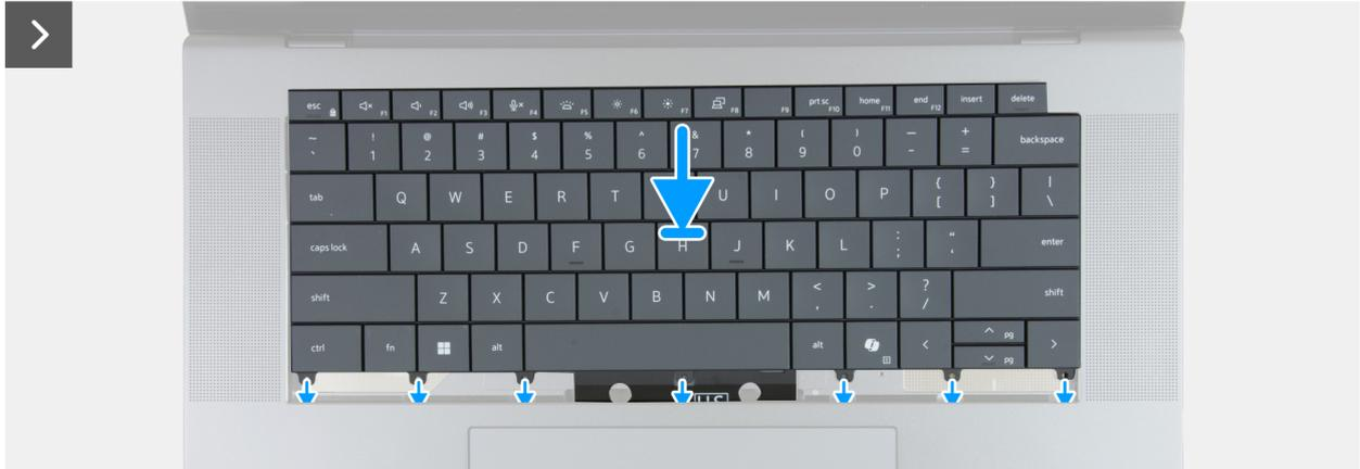
Abbildung 79. Einbauen der Tastatur
