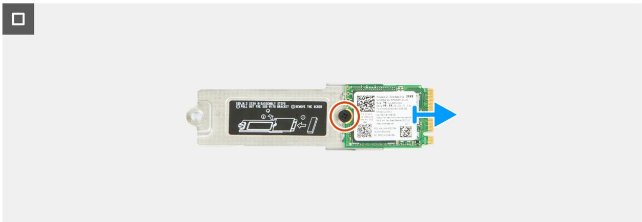
Abbildung 26. Entfernen des M.2 2230-Solid-State-Laufwerks (SSD1)
