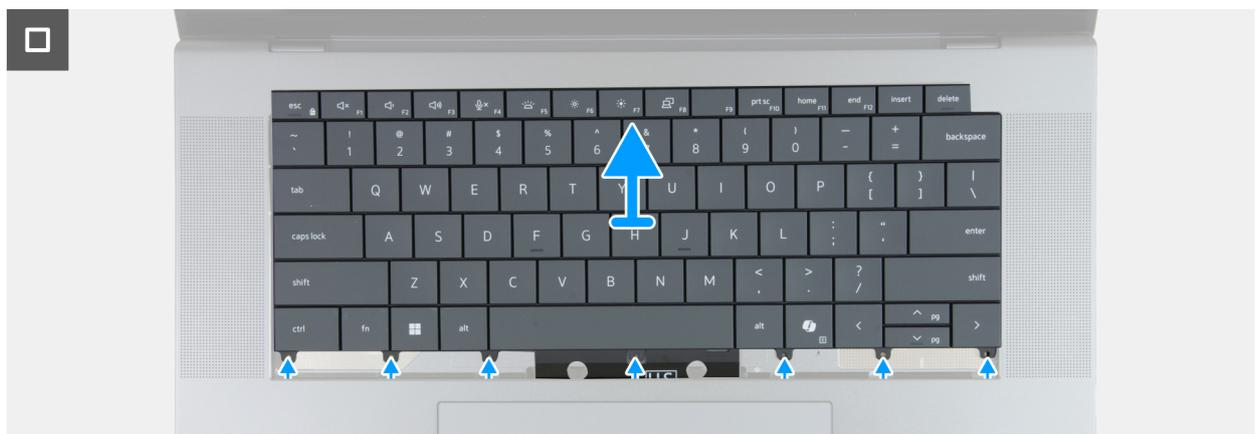
Abbildung 77. Entfernen der Tastatur
