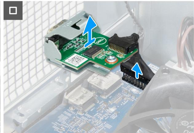
**Ilustración 57. Extracción del módulo de puerto serial**
