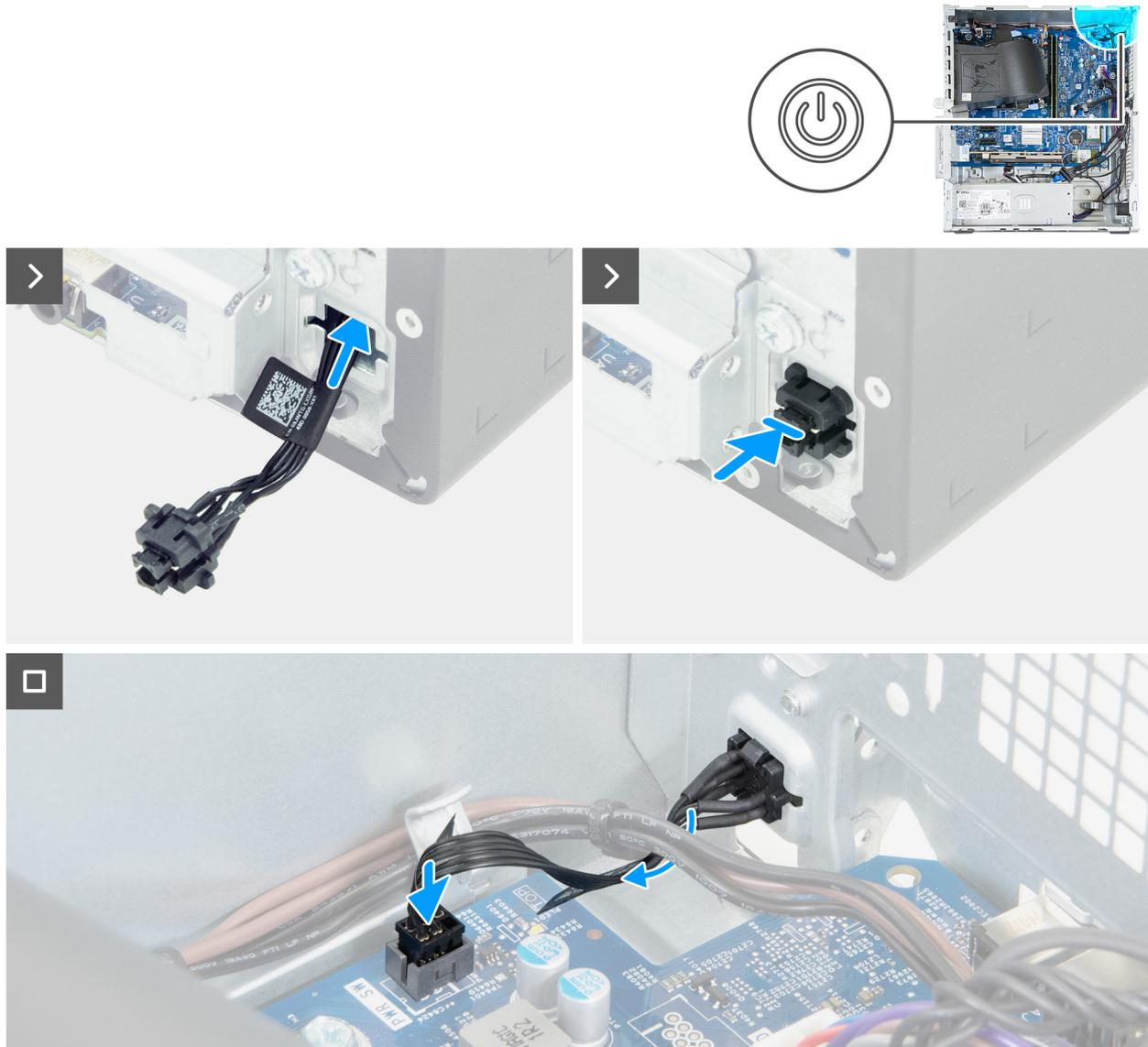
**Ilustración 51. Instalación del botón de encendido**
