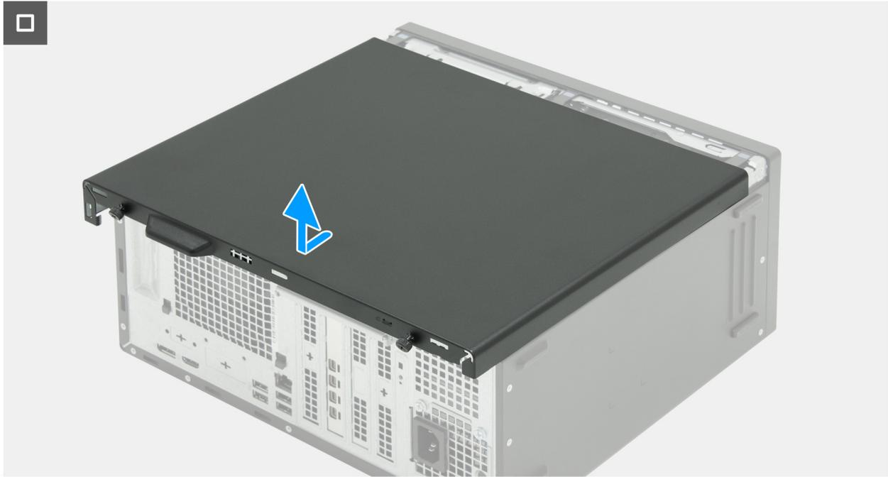
**Ilustración 14. Extracción de la cubierta lateral izquierda**
