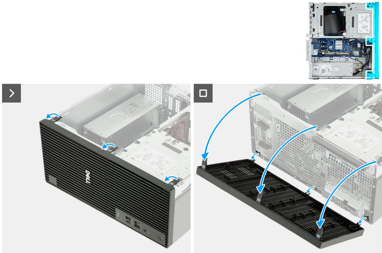
**Ilustración 23. Extracción de la cubierta frontal**
