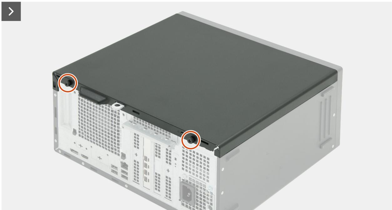
Ilustración 13. Extracción de la cubierta lateral izquierda
