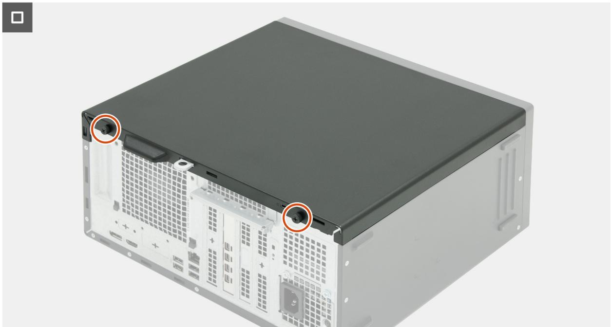
Ilustración 16. Instalación de la cubierta lateral izquierda
