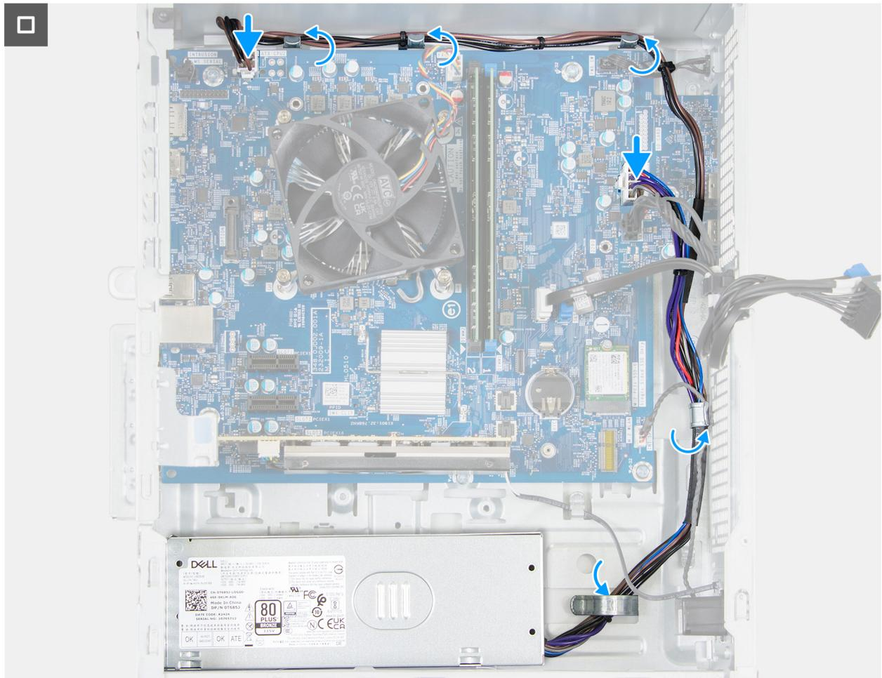
**Ilustración 65. Instalación de la fuente de alimentación**
