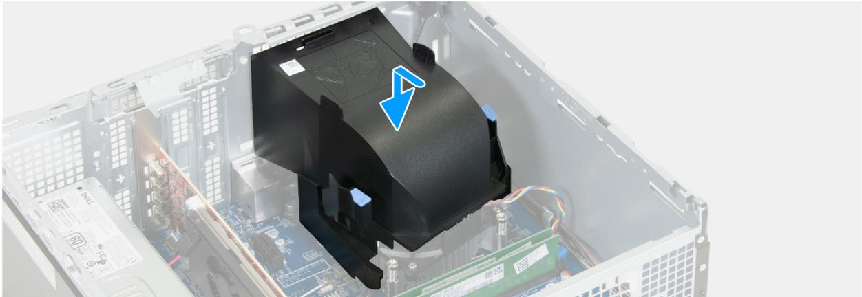
**Ilustración 53. Imagen: instalación de la cubierta para flujo de aire del ventilador**
