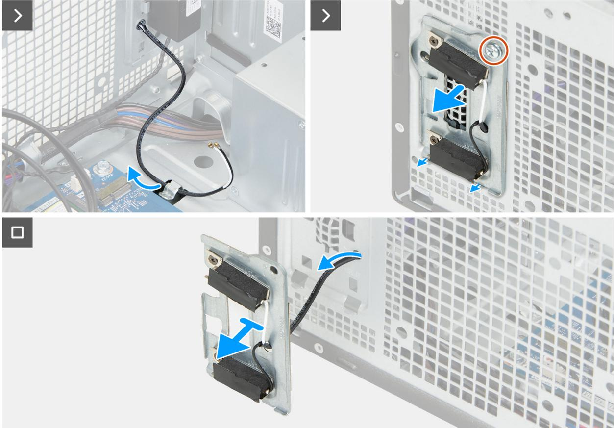
**Ilustración 60. Extracción de los módulos de la antena**
